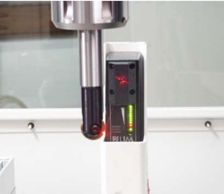
Das Lasermess-System scannt die Werkzeugschneide ab und erkennt somit auch kleinste Ausbrüche oder Verschleiß \mu\text{m} -genau.
