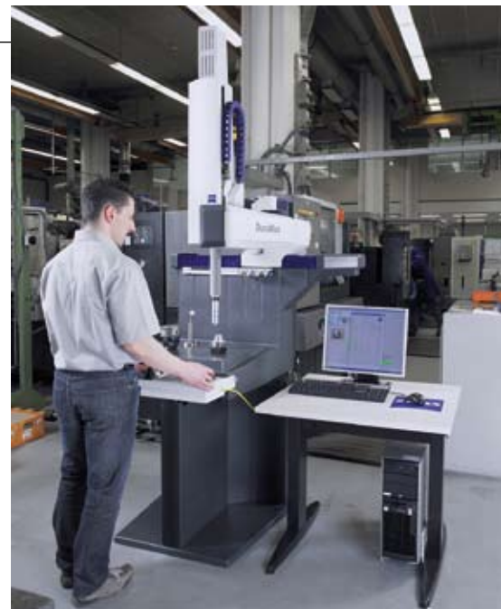
Ein Handmessmittel oder eine Lehre kann meist nur ein Merkmal messen. Ändert sich die Messaufgabe oder das Messspektrum, muss in neue Prüfeinrichtungen investiert werden. Kostengünstiger geht es mit DuraMax und myCALYPSO: Einmal investieren und alles messen – alle Werkstücke, alle Merkmale.
