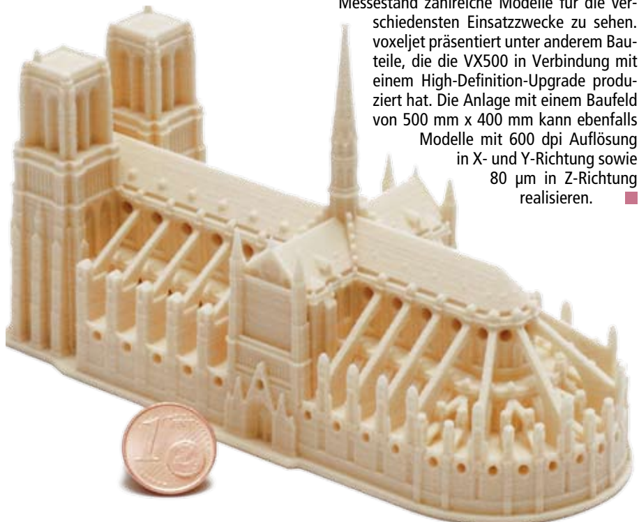
Das Modell der Kathedrale Notre-Dame de Paris ist mit der VX500 von voxeljet gefertigt und repräsentiert architektonische Einsatzszenarien des 3D-Kunststoffdrucks. Bilder: voxeljet
