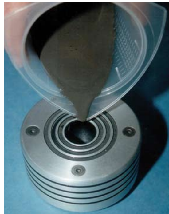
Klebeverbindungen mit dem Zwei-Komponenten-Klebstoff Aremco Bond 805 halten (auch wechselnden) Temperaturen im Bereich von -75 °C bis 300 °C stand und lassen sich nach dem Aushärten mechanisch bearbeiten.
