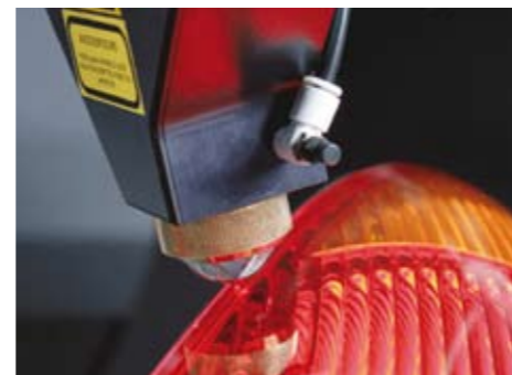
Globo-Welding für das dreidimensionale Laserschweißen von Kunststoff-Bauteilen. Bild: Leister
