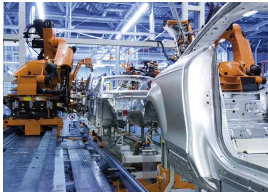
Bild aus dem Karosseriebau mit Robotern: Mit rund 95 Prozent Automatisierungsgrad ist der Aluminium-Karosseriebau des Audi TT optimal an die Stückzahl in diesem Fahrzeug-Segment angepasst.
