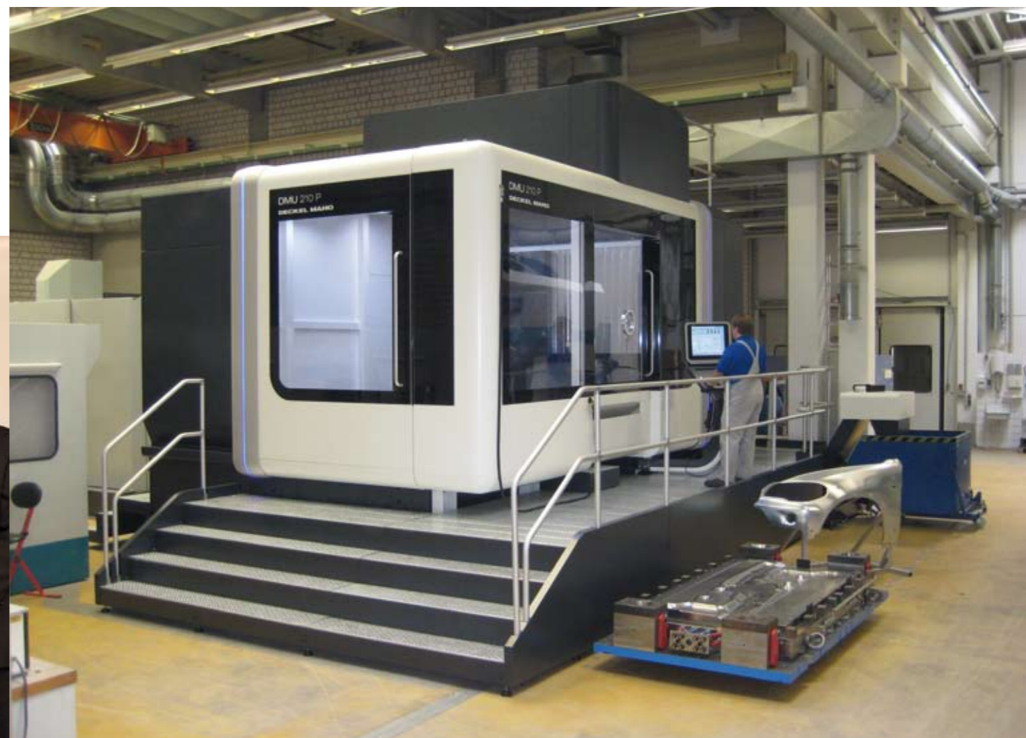
Letzte Großinvestition: Das neue Fräszentrum DMU 210 P von Deckel-Maho soll die Wettbewerbsposition des Unternehmens weiter stärken.
