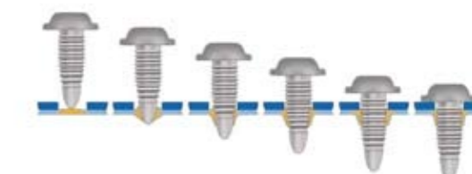
FDS-Schrauben/Fügetechnik für den Mischbau: Mit den neu entwickelten Flow-Drill-Schrauben (FDS) können Blechdicken bis zu vier Millimeter in Aluminium beziehungsweise zwei Millimeter in Stahl ohne Vorloch und mit einseitiger Fügeichtung verbunden werden.
