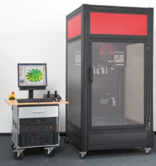
Die Inspektionszelle vermisst die Bauteile automatisch. Bild: GOM
