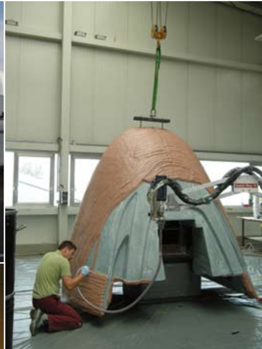
Realisierung einer Designstudie eines Hochgeschwindigkeitszug mit Hilfe der Epoxidpaste P 26. Bilder: ebalta
