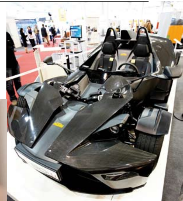
Der Österreichische Motorradbauer KTM zeigte den X-Bow, seinen ersten Sportwagen mit Kohlefaser-Monocoque.
