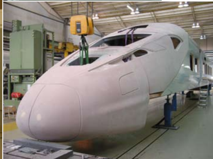
Realisierung einer Designstudie eines Hochgeschwindigkeitszug mit Hilfe der Epoxidpaste P 26. Bilder: ebalta
