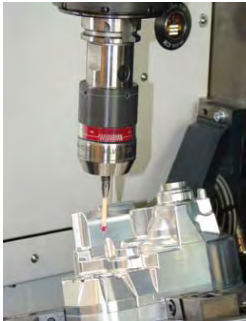
Mit FormControl V4 können Freiformflächen direkt auf dem 5-Achs-Bearbeitungszentrum vermessen werden.
