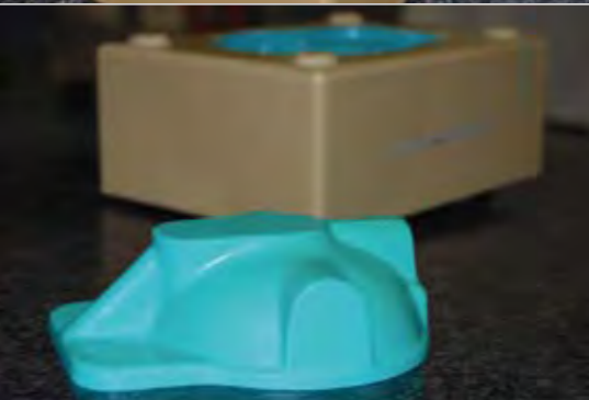
Modell gefertigt im Frontgussverfahren mit RAKU-TOOL PC-3451/PH-3952, Kernherstellung mit PF-3701-1.
