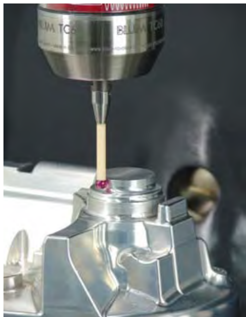
Die Blum-Software ermöglicht nun auch die Vermessung geometrischer Elemente wie z.B. Bohrung, Zapfen, Kegel, Kugel, Stege, Stufe oder Nut (zueinander bzw. relativ zu einer Maschinenachse).
