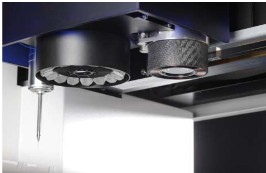
Die Sensoren des Multisensor Messgerätes O-INSPECT.
