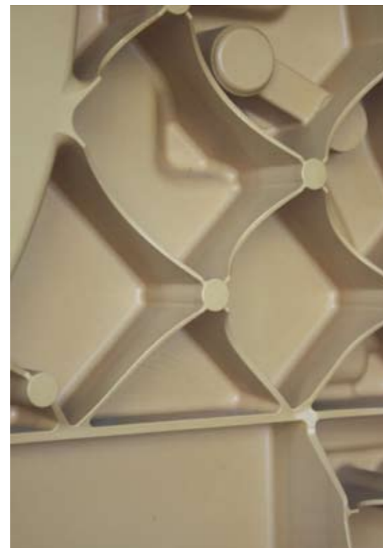
Detail eines Kernkastens, der mit der WorkNC programmiert wurde. Bild: Kegelmann
