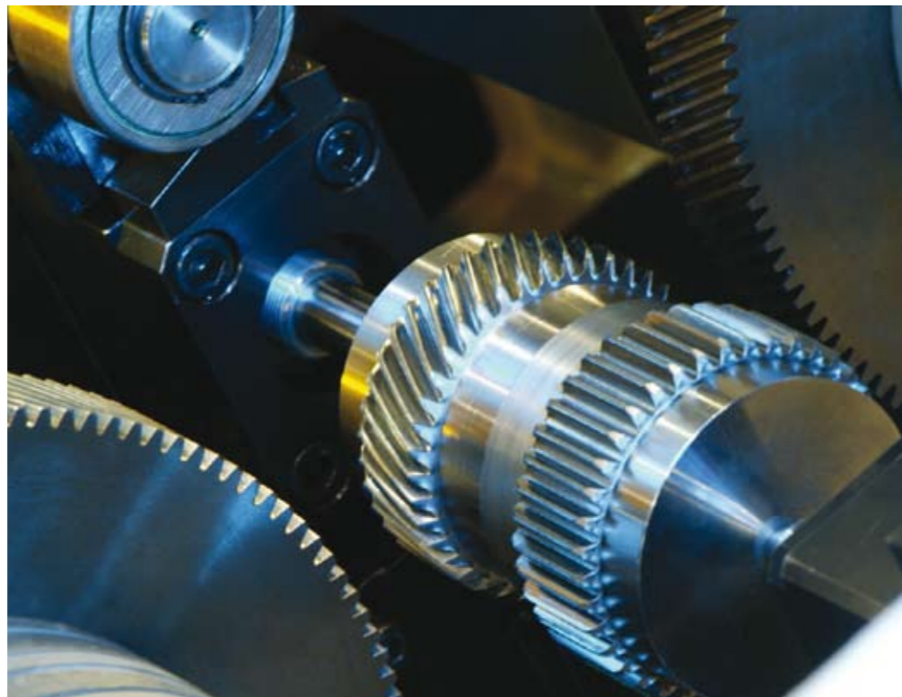
Plus für Kaltumformen: Profilwalzen senkt Energiekosten sowie Fertigungszeiten und ermöglicht die Produktion von Endkonturen. Bild: IWU, Chemnitz
