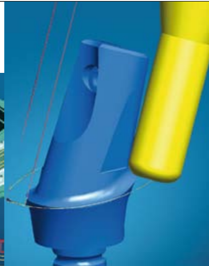
Das neue 5Achs-Konturfraßen sorgt für mehr Sicherheit beim Einsatz von großen Fräsern.
