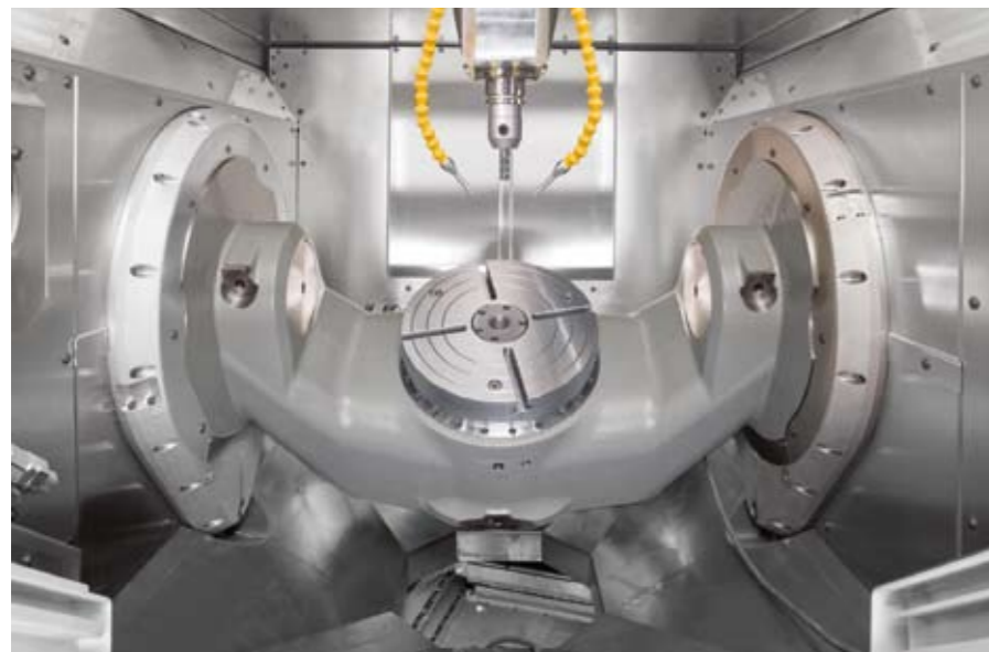
NC-Schwenkrundtisch mm mit integriertem Torquemotor.
