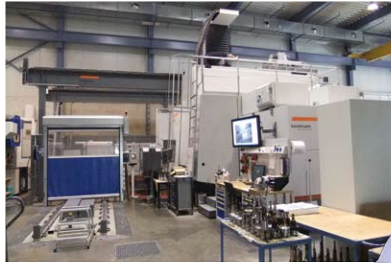
Eine der Fräsmaschinen, die Handtmann UBZ 300/200 mit 3fachem Palettenwechsel. Bild: König
