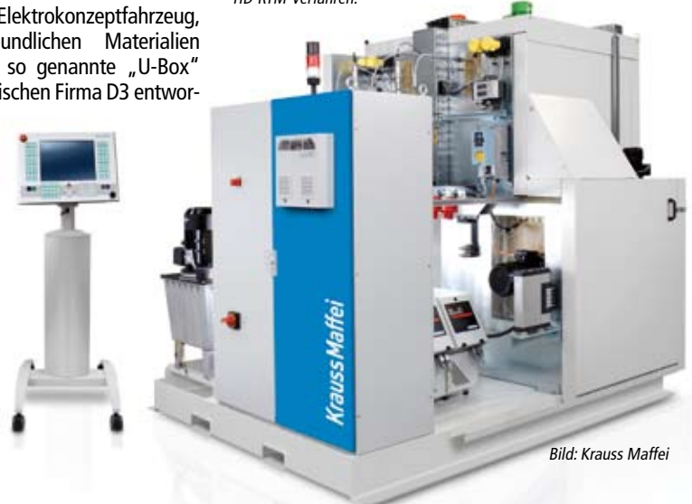
Die Hochdruck-Misch- und Dosiereinheit RimStar Thermo verarbeitet die reaktive Kunststoffmatrix im HD-RTM-Verfahren.
