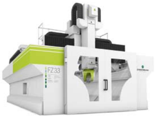
Die Portalfräsmaschine FZ 33 bearbeitet Bauteile aus Aluminium und Verbundwerkstoffen schnell und komplett von fünf Seiten. Bild: Zimmermann
