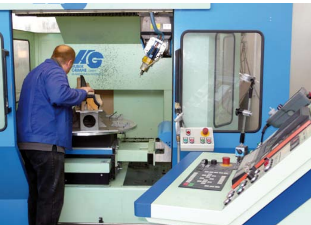
Flexibel: Ein 5-Achs-Bearbeitungszentrum stellt Bauteile unterschiedlicher Dimensionen her.
