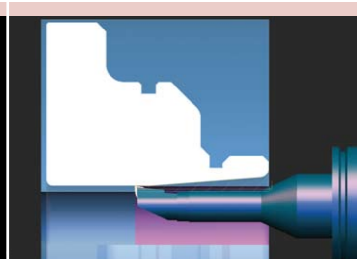
Bei allen Bearbeitungen werden Kollisionen bereits bei der Berechnung mit dem Komplettwerkzeug geprüft. Falls nötig, wird der zu bearbeitende Bereich automatisch verkleinert.
