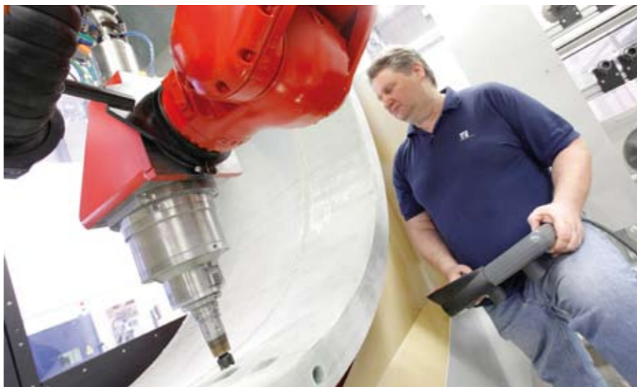
Kyrogen im Kommen: Die GFE-Forscher aus Thüringen setzen bei der CFK-Zerspanung auf Trockenbearbeitung, sind aber auch aufgeschlossen zu Speziallösungen wie dem Bearbeiten mit Stickstoffkühlung (im Bild). Bild: Hannovermesse
