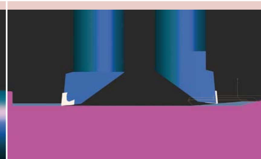
Mit nur einem Werkzeug können verschiedene Hinterschnittbereiche vollständig zerspannt werden. Die benötigte Spindelorientierung wird automatisch gesetzt.
