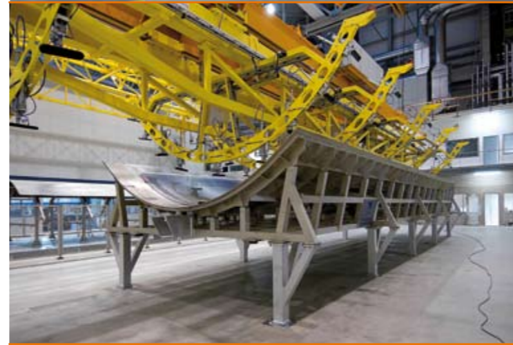
Klebeauftrag der besonderen Art: Bei Premium Aerotec entstehen auch Laminierklebevorrichtungen (im Bild eine Anlage mit automatisierter Handhabungseinrichtung zur Bauteilentnahme).
