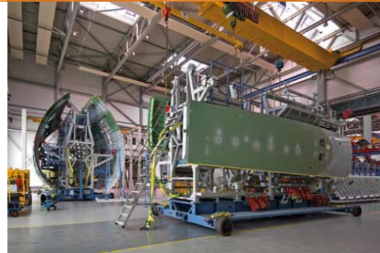
Erweitertes Produktprogramm: Rund 200 Mitarbeiter entwickeln und bauen auch Fertigungssysteme für ein optimiertes Material- bzw. Bauteilhandling (im Bild eine Handhabungs- und Transportvorrichtung) oder zum Fixieren von Bauteilen für die Zerspanung.
