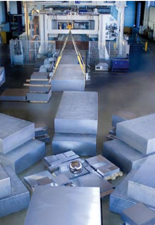
Mit Hilfe eines hochmodernen Sägezentrums in Thüringen versorgt Bikar seine Kunden mit Formodal-Aluminium-Gussplatten.
