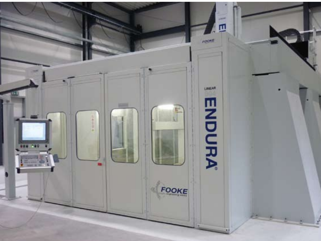
Die Endura 900Linear wurde als neueste Generation mit oben liegendem, verfahrbarem Portal aus den bereits erfolgreichen konventionellen Fräsmaschinen entwickelt. Bilder: Fooke
