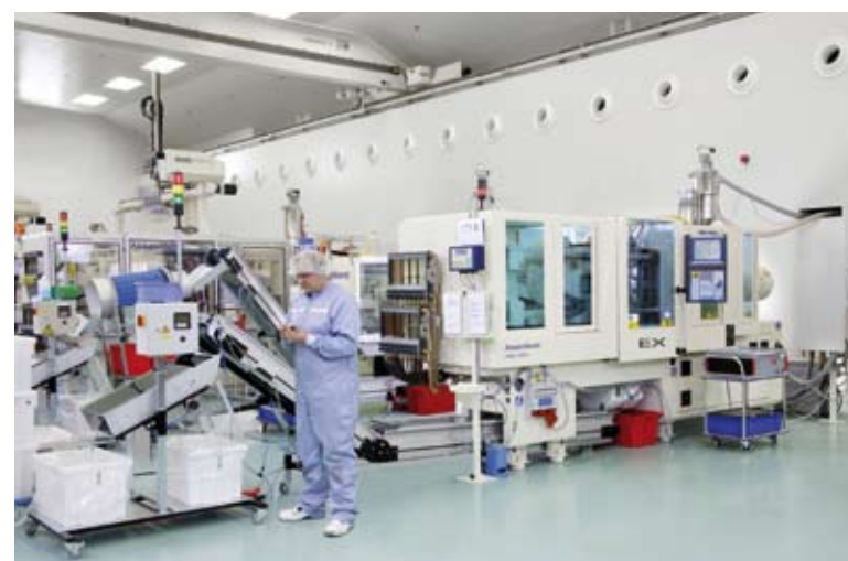
Reinraumfertigung bei Rexam im Werk Neuenburg: Vollelektrische Spritzgießmaschinen arbeiten emissionsarm und präzise und sind daher besonders gut für eine Produktion im Reinraum geeignet. Bild: Krauss Maffei
