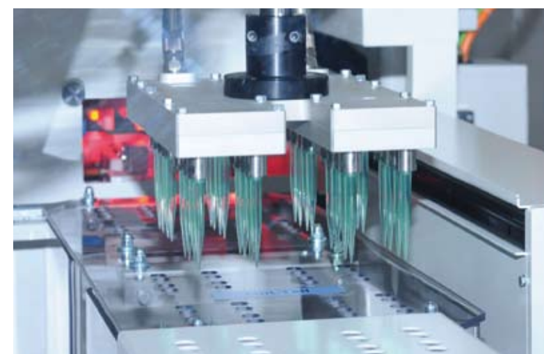
Dieser Entnahmegreifer schafft es, innerhalb von 0,25 Sekunden in das Spritzgießwerkzeug einzuqueren, die Pipetten aus einem 32fach-Werkzeug aufzunehmen, eine Anwesenheitskontrolle durchzuführen und wieder auszuqueren. Bild: Hekuma
