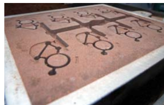
Auch die Erstellung von Gussformen gehört zum Alltag bei der Firma Braach. Bilder: Dickel / Westfalenpost
