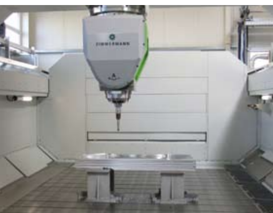
Die Portalfräsmaschine überzeugt durch ihren großen Arbeitsraum, der wegen ihrer Modularbauweise beliebig variieren kann.
