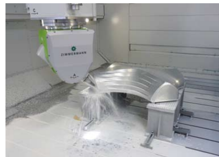
Die komplexe Form ist für die FZ 33 kein Problem. Gleichzeitig wird eine hohe Oberflächengüte erreicht – ohne Nacharbeit.
