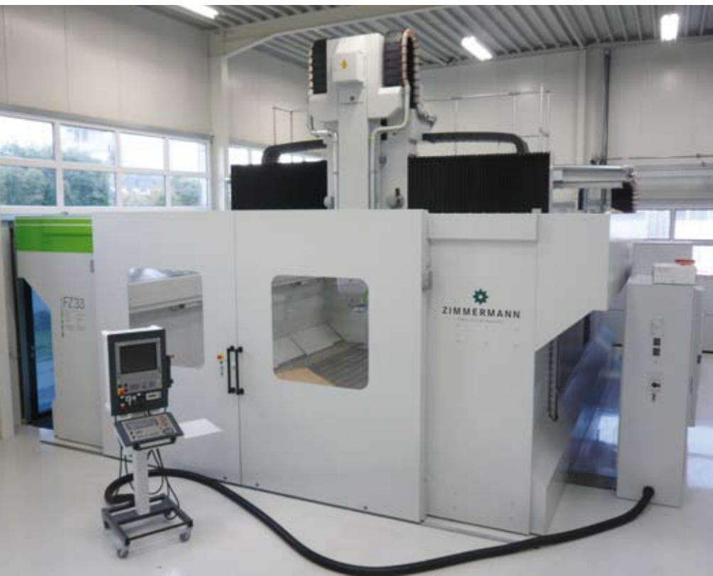
Die Portalfräsmaschine FZ 33 bearbeitet Bauteile aus weichen und zähen Werkstoffen schnell und komplett von fünf Seiten. Bilder: Zimmermann
