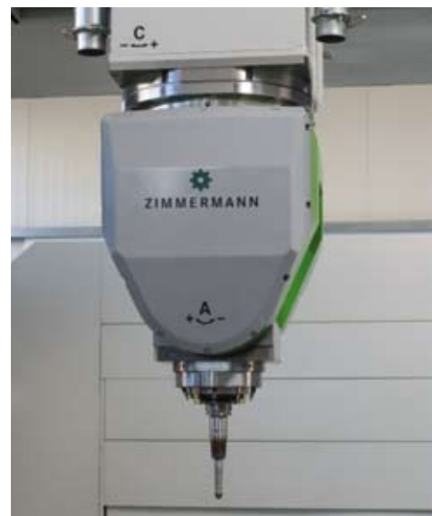
Der neue Zimmermann-Fräskopf VH 20 verbindet hohe Drehmomente mit hohen Rotationsgeschwindigkeiten in der A- und C-Achse bis 360 Grad/Sekunde.
