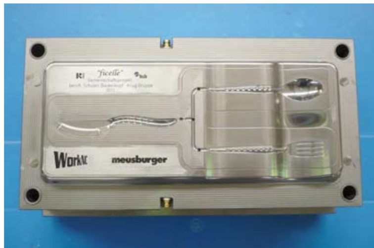
Die Auszubildenden von Formenbau Krug setzten die CAD-Daten mit WorkNC in NC-Programme um.
