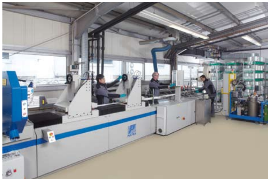
Die ITC-Forscher haben für die Automobilindustrie ein neues Herstellungsverfahren entwickelt und dabei eine Flechtmaschine mit einer Pultrusionsmaschine kombiniert. Bild: ITC
