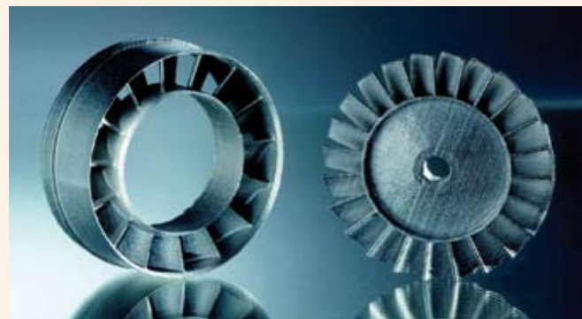
Aus einer Superlegierung mittels SLM gefertigter Stator und Rotor einer Mikrogasturbine. Konstruktive Auslegung durch das Fraunhofer IPT. Bild: Fraunhofer ILT
