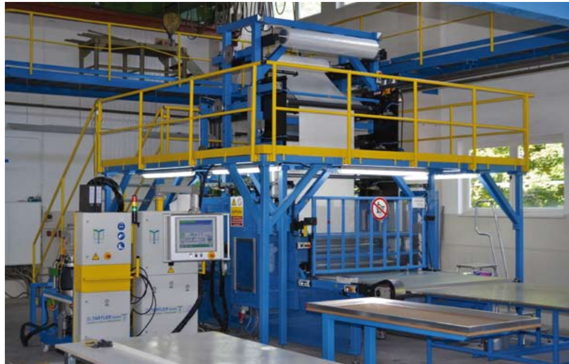
Die neue Inhouse-PrePreg-Anlage von Tartler zur wirtschaftlichen Produktion von Glasfasermatten ging Mitte September bei Vitec in Betrieb.
