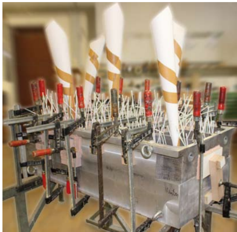
Kernkästen: optimal zum Frontschichtguss vorbereitet mit dem Gießereiharz Biresin U1320 NT.
