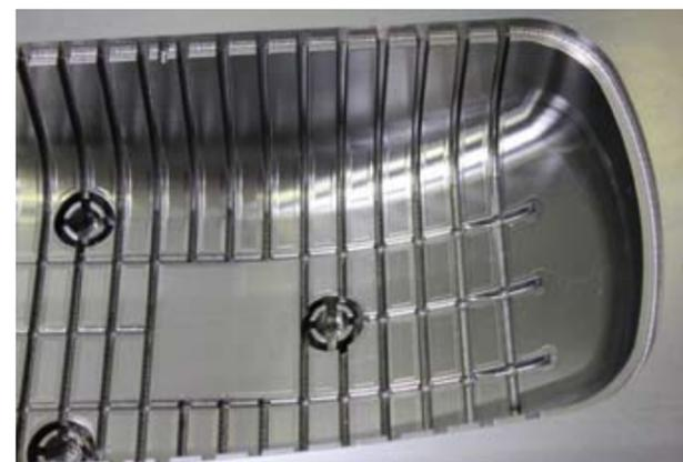
Bei diesen schmalen Nuten konnte sich Langer das Vorschlichten sparen. Das Werkzeug wurde in ein Haimer Power Mini Shrink Chuck gespannt und wies dann solche Stabilität auf, dass das Schlichten in einem Durchgang die erforderliche Qualität erbrachte.
