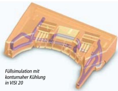
Füllsimulation mit konturnaher Kühlung in VISI 20
