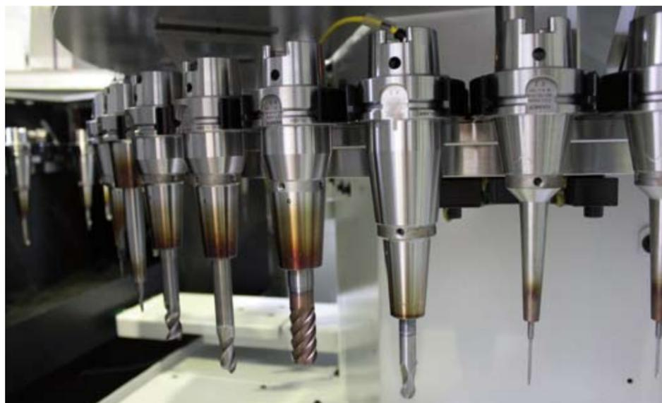
Die modernen Bearbeitungszentren bei Langer sind mit Werkzeugen bestückt, die vorwiegend in Haimer Power Shrink Chucks und Power Mini Shrink Chucks (die schlanken Futter rechts) gespannt sind.
