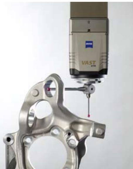
Der neue Messkopf VAST XTR gold. Bild: Zeiss
