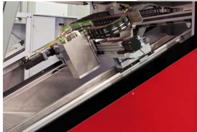
Schräges Baufeld der VXC800
