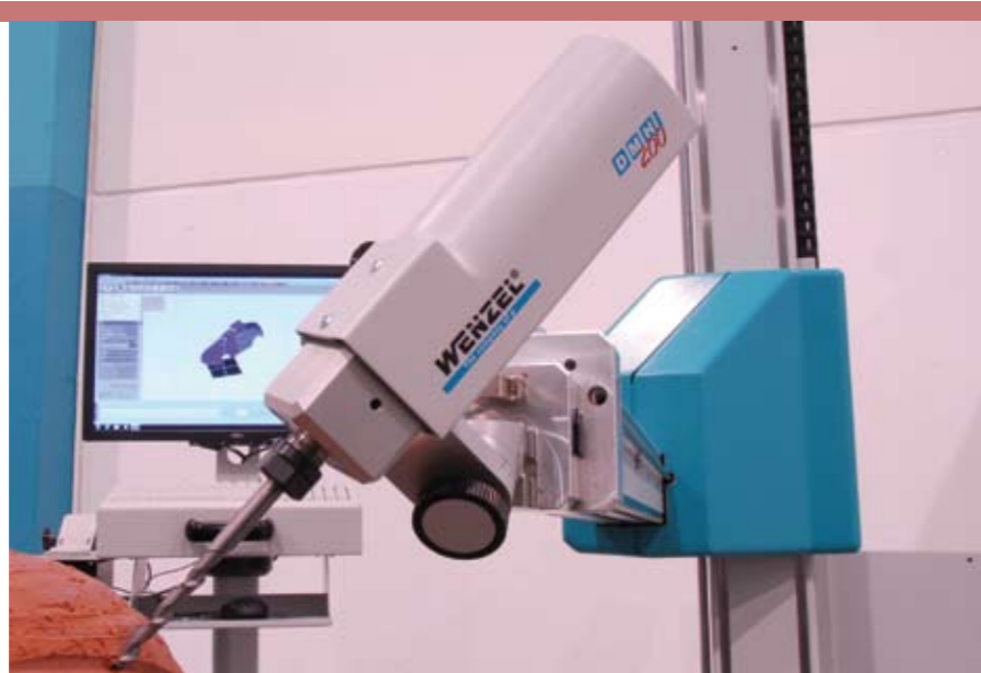
2-Achsen-Fräskopf DMH 200 im Einsatz an einem Clay-Modell
