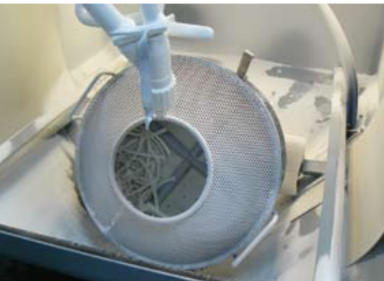
Was die Oberflächen von gesinterten Bauteilen angeht: Kegelmann hat gemeinsam mit Rösler Oberflächentechnik entsprechende Verfahren bei der Strahl- und Gleitschleiftechnik entwickelt.
