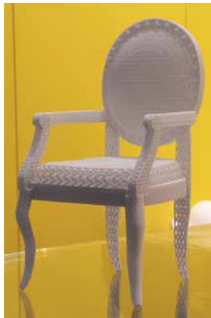
Ein aus Strukturen mit dem Lasersinterverfahren gefertigter Kunststoffstuhl.
