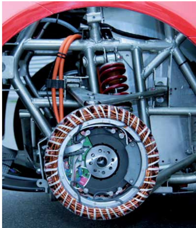
Stator des Radnabenmotors montiert am „Fraunhofer electric concept car“ Bilder: Fraunhofer IFAM
