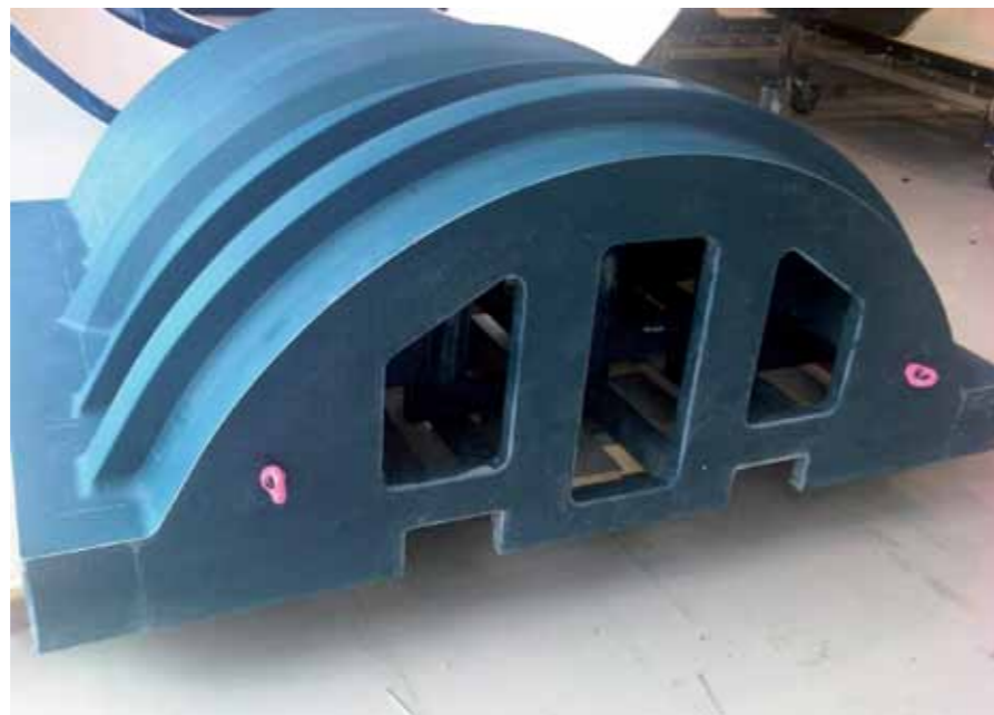
Mastermodell zur Herstellung eines Prepregwerkzeuges für einen Turbinengehäuse mit einem Gewicht von 5.500 kg
