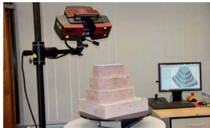
Um Materialien und Bauteilverhalten besser zu verstehen, wird optische 3D-Messtechnik eingesetzt – auch in der Ausbildung in Bad Wildungen. Möglich wird dies durch einen GOM-Scanner der neuesten Generation.
