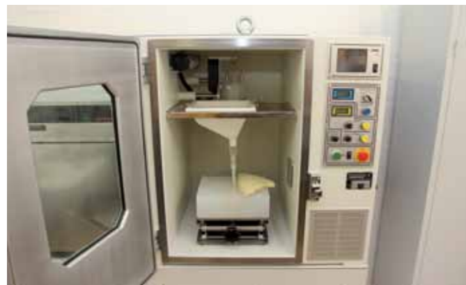
Mit der neuen Vakuum-Gießanlage erhalten Schüler an der Bundesfachschule einen weiteren Einblick in die Kunststoffverarbeitung.
