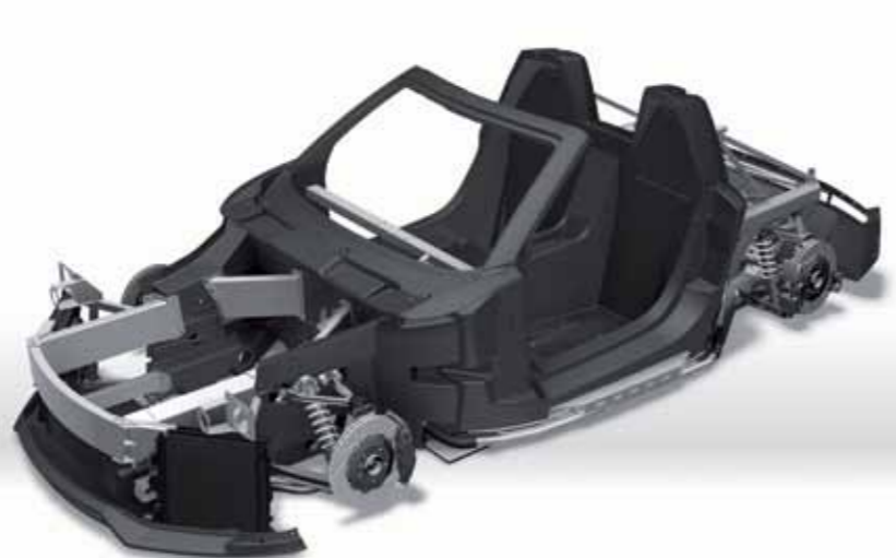
CFK-Chassis aus 45 Kilogramm ebalta AH 140 mit Härter TC 90-1.
