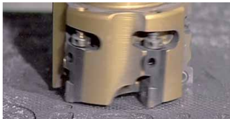
Dia Mill Speed beim Fräsen von CFK.
