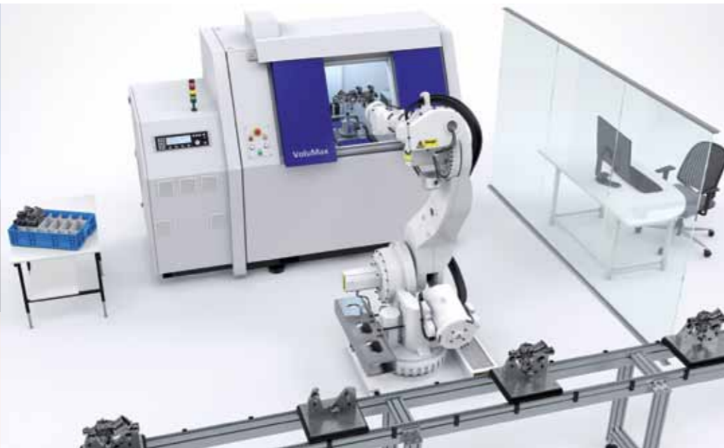
Vollautomatische 3D Werkstückprüfung: Die Inline-Computertomographie sorgt durch automatische Roboterbestückung für die optimale Einbindung in Fertigungslinien. Bild: Zeiss
