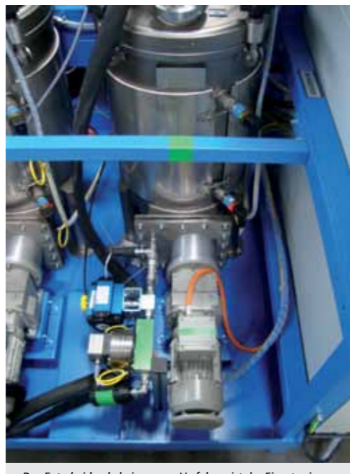
Das Entscheidende beim neuen Verfahren ist der Einsatz einer wartungsfreien Dosierpumpe am Boden des Dosierbehälters, die vollständig von Material umgeben ist. Die Antriebswelle der Pumpe wird berührungslos über eine Permanentmagnet-Kupplung von einem Elektroantrieb angetrieben. Bilder Tartler
