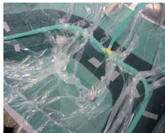
Die Vakuuminfusion wird durchgeführt.
