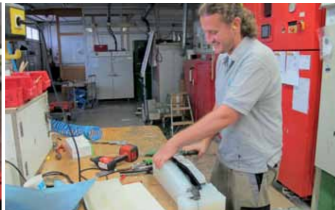
Oliver Karle (Teamleiter Vakuumraum) löst ein Teil aus der Silikonform.
