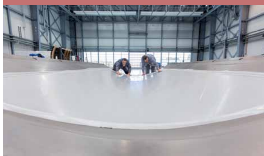
Trennmittelfreie XXL-Bauteilherstellung: Überprüfung der in der Form für eine CFK-Flugzeugrumpfschale tiefgezogenen faltenfreien FlexPLAS-Trennfolie. Bild: Fraunhofer IFAM
