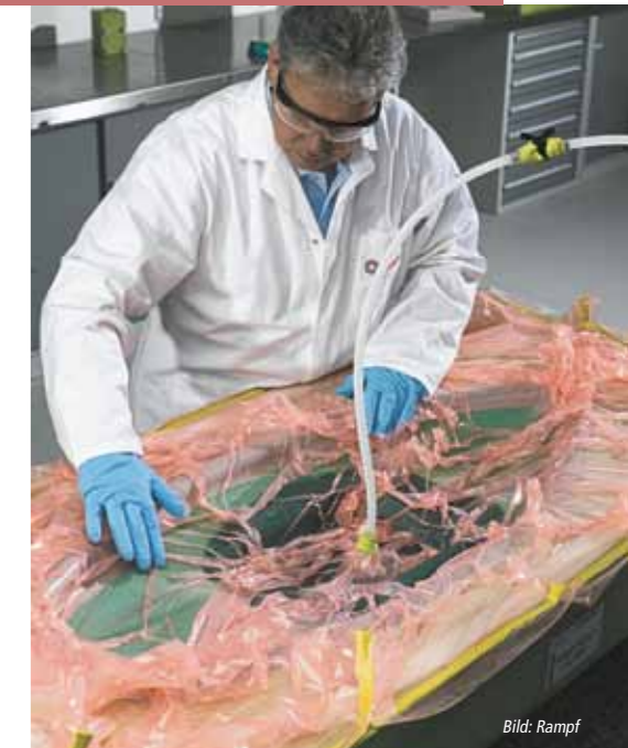
Resin-Infusion-Verfahren mit Materialien von RAMPF Tooling.
