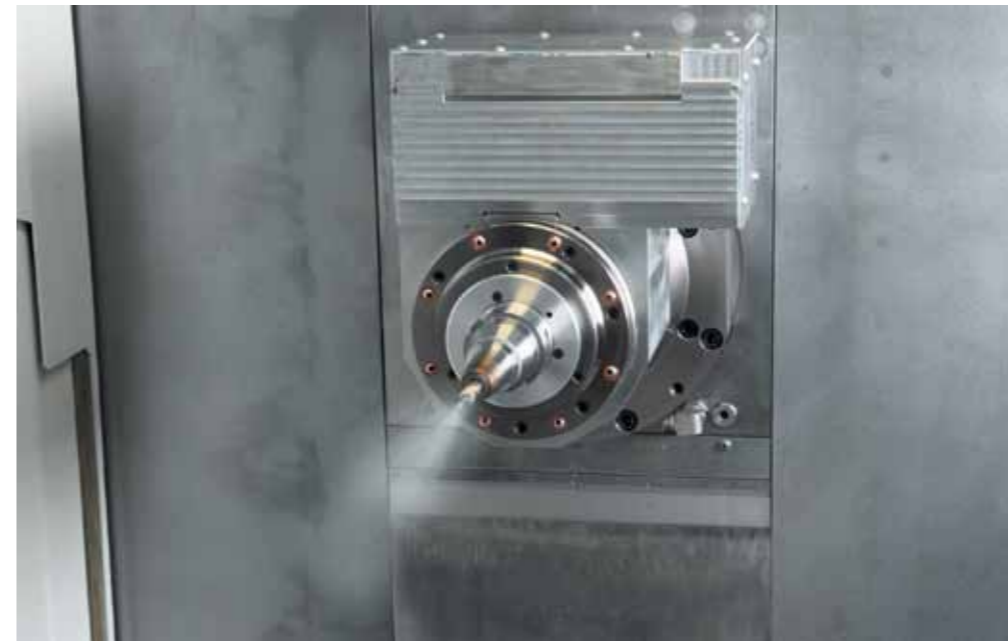
Optionale Nachrüstung: Die kryogene Kühlung mit Kohlendioxid lässt sich laut ISF relativ einfach nachrüsten und bietet sich für Maschinenbauer an, die damit erste Erfahrungen sammeln wollen. Bild: Starrag Group
