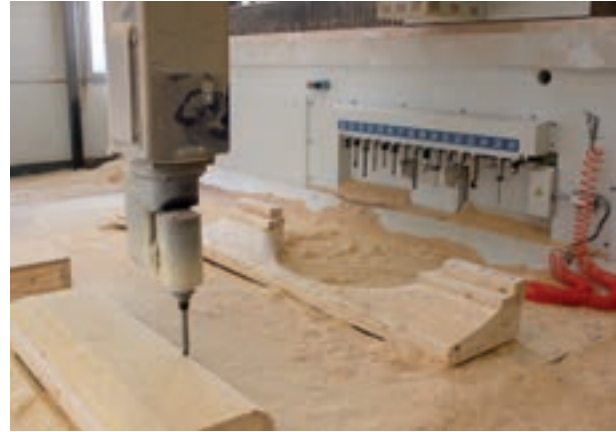
Platz für große Bauteile: Auf dem fünfachsigen CNC-Portal-Bearbeitungszentrum von CMS lassen sich Modellkomponenten aus Leichtbaumwerkstoffen wie zum Beispiel aus Holz hochgenau fräsen.
