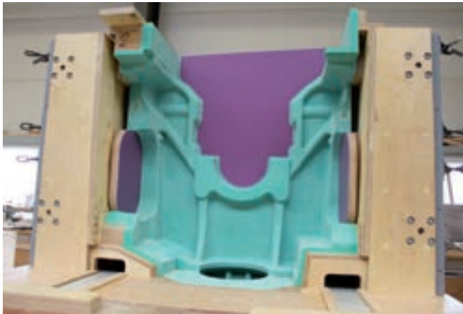
Manche Gießereimodelle werden auch komplett gefräst.
