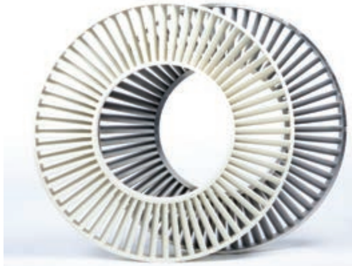
Kunststoffmodell und fertiges Gussteil
