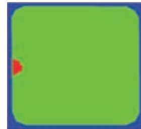
QMcoating: Ohne QMcoating kann es zu unzureichender Beschichtung des Layer kommen (die roten Bereiche weisen auf fehlendes Pulvermaterial hin); Ansatz dazu: Mit QMcoating wird der Dosierfaktor des Pulvers innerhalb der Toleranz angepasst.
