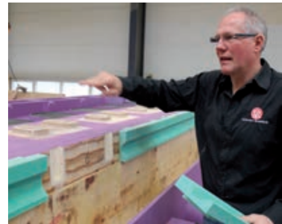
Herbert Schild erklärt den Aufbau eines Gießereimodells, bei dem an den manuell gebauten Grundkörper gefräste Komponenten montiert werden.
