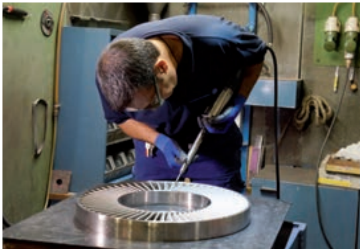
Nachbearbeitung des Gussteils
