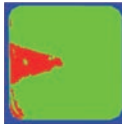
QMcoating: Ohne QMcoating kann es zu unzureichender Beschichtung des Layer kommen (die roten Bereiche weisen auf fehlendes Pulvermaterial hin); Ansatz dazu: Mit QMcoating wird der Dosierfaktor des Pulvers innerhalb der Toleranz angepasst.
