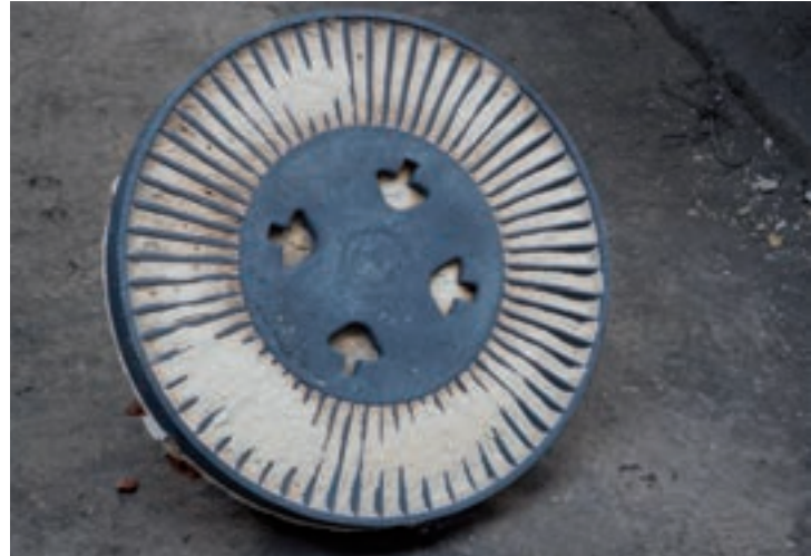
Rohgussteil mit Keramikschale
