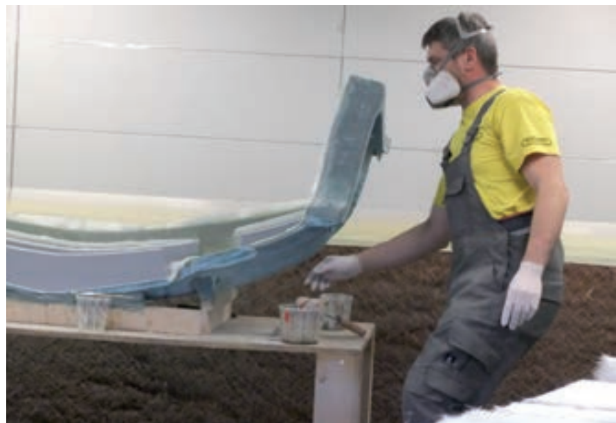
Neu ist ein Freiarbeitsplatz der Firma Denios. Im Sommer werden die abgesogenen Luftmengen nach außen geleitet. Bild: König
