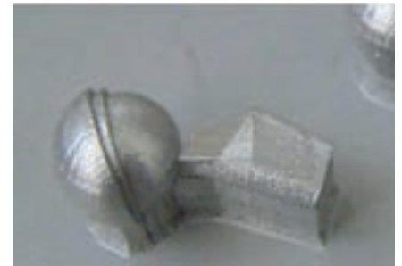
Aktive Qualitätssicherung mit dem QMmeltpool: Für das menschliche Auge ist kein Fehler erkennbar. Abweichungen in der Bauteilqualität erkennt QMmeltpool dennoch.
