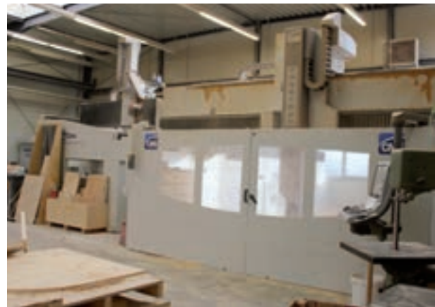
Ohne CAD/CAM und Fräsbearbeitung geht es heute auch im Großmodellbau nicht mehr. 2008 zogen die großen 5-Achs-Bearbeitungszentren in die Fertigungshalle der Duisburger Modellfabrik.
