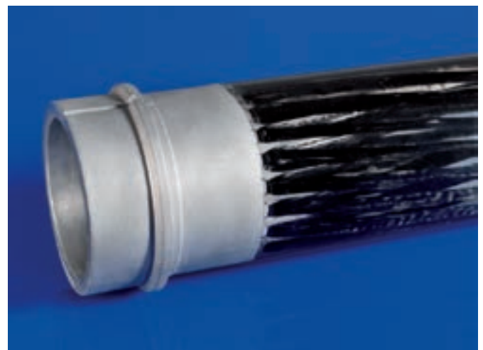
Rohrstoß als Hybridverbindung zwischen einem Aluminium-Druckgussbauteil und CFK mithilfe von Titandrahtschlaufen als Übergangsstruktur. Bilder: Fraunhofer IFAM
