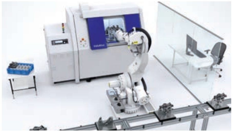
Vollautomatische 3D-Werkstückprüfung: Die Inline-Computertomographie sorgt durch automatische Roboterbestückung für die optimale Einbindung in Fertigungslinien. Bild: Zeiss
