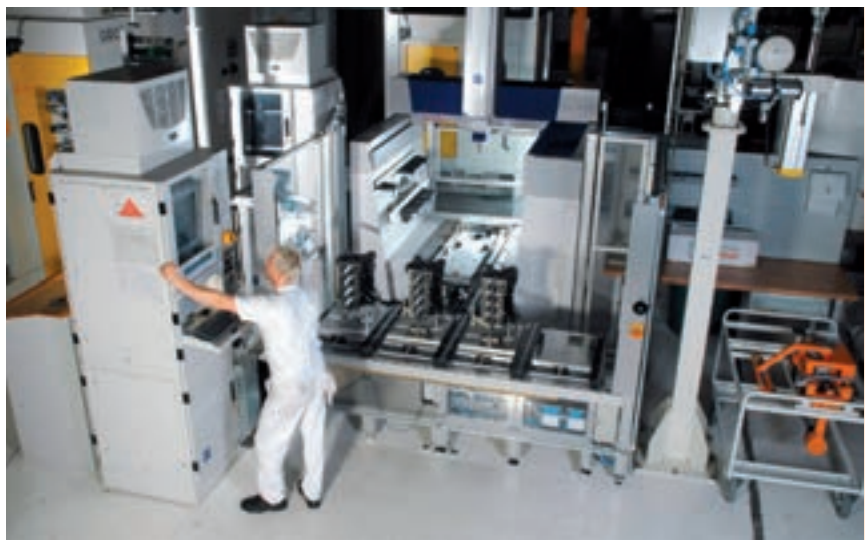
Universelle Koordinatenmessgeräte eignen sich zur wirtschaftlichen Messung sowohl mit den in der Fertigung als auch im Messraum.“ Bild: Zeiss
