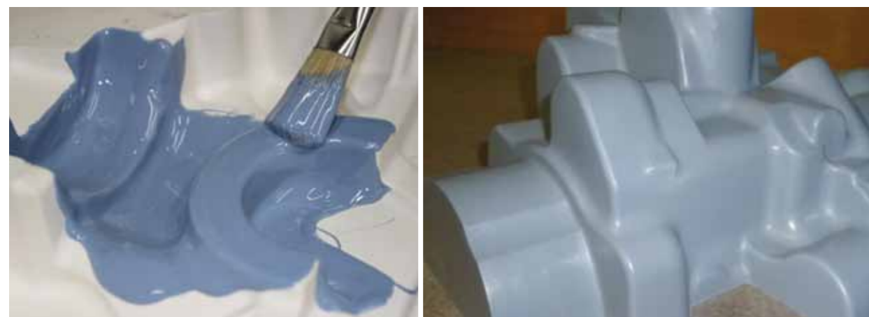
Bild 4: Aufstreichen des Oberflächenharzes Biresin S13 (links) und fertiges Produktionsmodell für Formmaschinen-guss (rechts).
