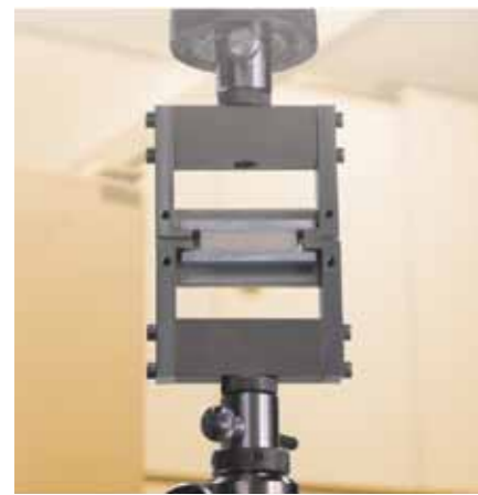
Bild 3: Mit optimaler Oberflächenvorbereitung lässt sich die Haftung von Biresin U1320 NT auf Aluminium bis zum 20-fachen erhöhen.
