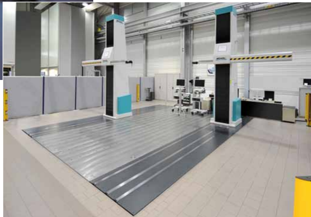
Ein RAX Duplexsystem im Messraum bei VW in Wolfsburg. Durch den spiegelbildlichen Aufbau der Messständer bei einer Duplexversion, wird der Messbereich in der X-Achse optimal genutzt. (Quelle: Volkswagen) Bilder: Wenzel
