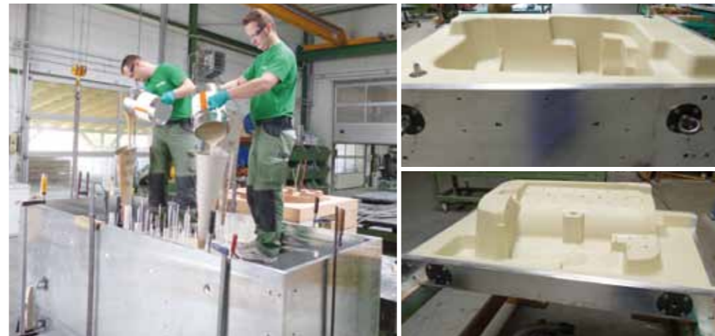
Bild 2: Frontschichtguss mit Biresin U1320 NT und das Ergebnis: perfekte Modellhälften.
