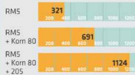
Bild 3: Mit optimaler Oberflächenvorbereitung lässt sich die Haftung von Biresin U1320 NT auf Aluminium bis zum 20-fachen erhöhen.
