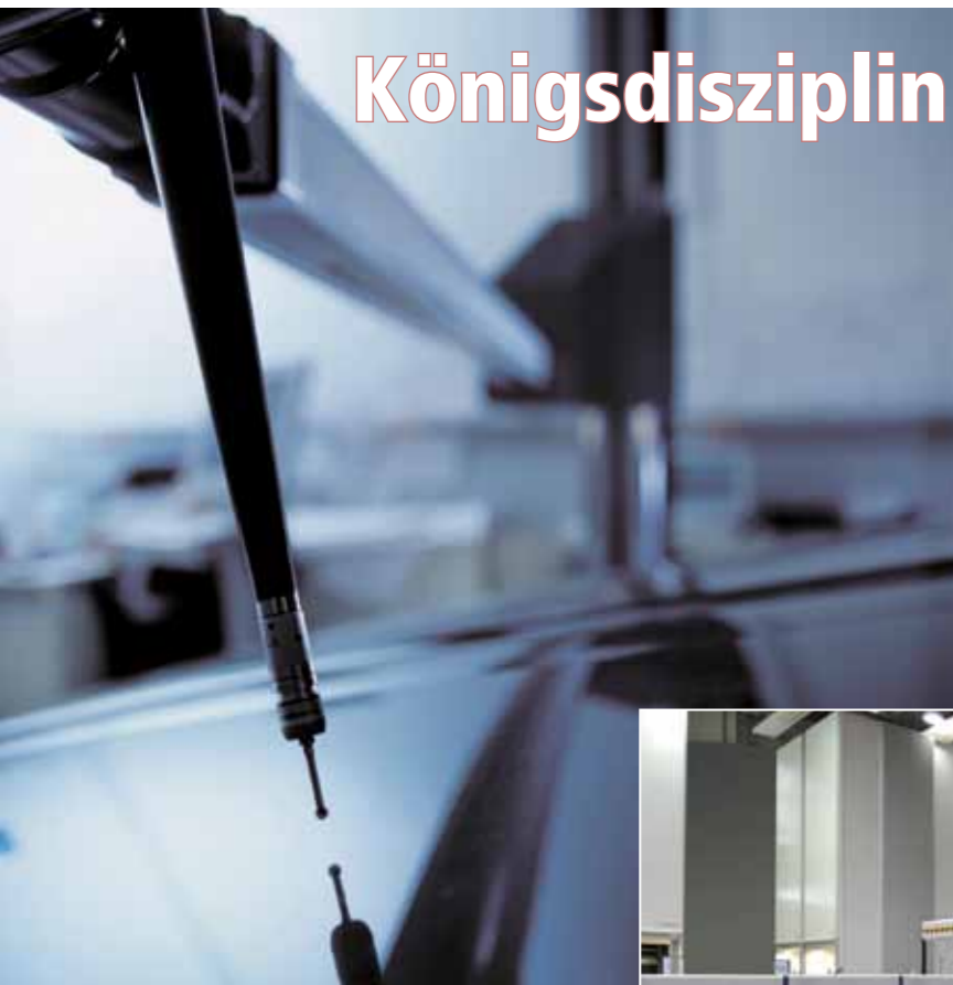
Der stufenlos schwenkbare motorische Dreh- und Schwenkkopf PHS benötigt einen minimalen Kalibrieraufwand. Es können Verlängerungen bis 750 mm montiert werden.
