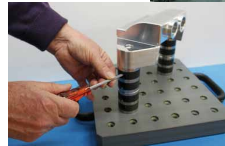
Eine FCS BREYLINE Palettenanlage ermöglicht fünfseitige Bearbeitungen.
