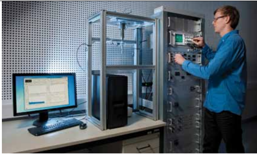
Einrichtung des Hochfrequenz-Ermüdungsprüfstandes Bild: Fraunhofer IWS / Frank Höhler
