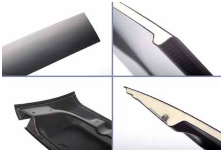
Composites vor dem Einzug in die Großserie: Konzeptstudie von BASF für ein mehrteiliges Cabriolet-Dachmoduls in Sandwich-Bauweise mit Carbonfaserverstärkten Deckschichten und einem PUR-Schaumstoffkern. Bild: BASF
