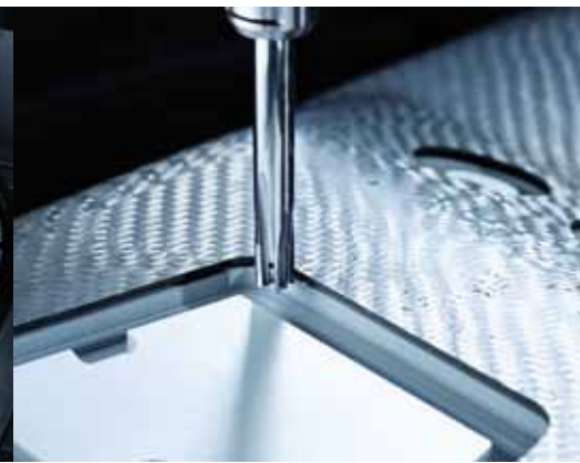
Stellt höchste Anforderungen an Maschine und Werkzeug: Das Besäumen und Bohren einer Pkw-Mittelkonsole aus CFK, hier auf einer Ultrasonic-Maschine von DMG Mori. Bilder: DMG Mori
