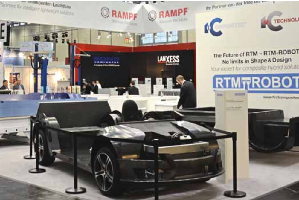
Elektrifizierend: Für die Formen dieses Elektrofahrzeug wurden insgesamt 9,5 Tonnen Epoxy-Material von RAMPF Tooling Solutions vergossen. Hergestellt wurden die Carbon-Teile aus der Harzmatrix RAKU-TOOL EI-2560 1C und dem von der Firma First COMPOSITES (1C) entwickelten und patentierten RTM-ROBOT.
