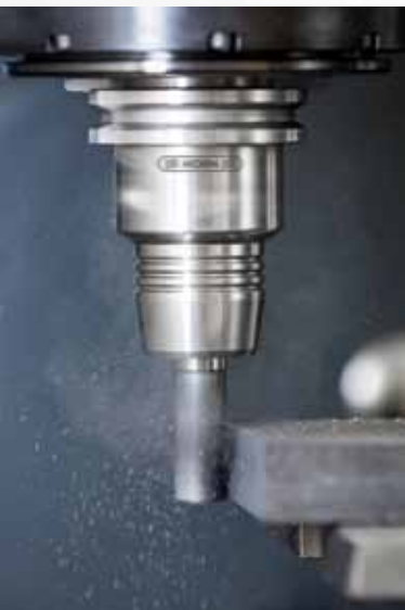
Für fast alles den richtigen CVD-Fräser: Auswahl von Horn-CVD-Fräsern zur Bearbeitung von Composites. Bild: Horn
