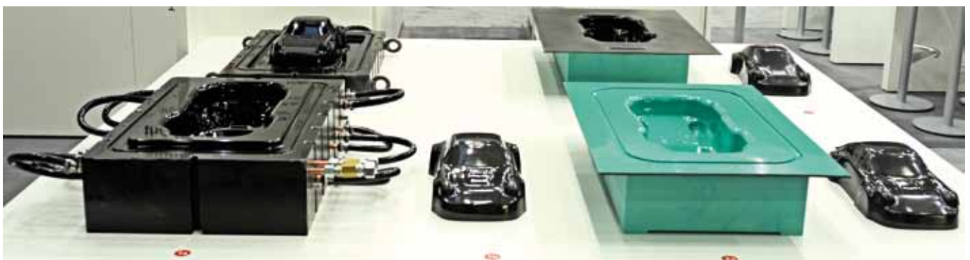
Klein und sehr fein: Die Sportwagenmodelle wurden mittels RTM, Resin Infusion und Prepreg hergestellt.
