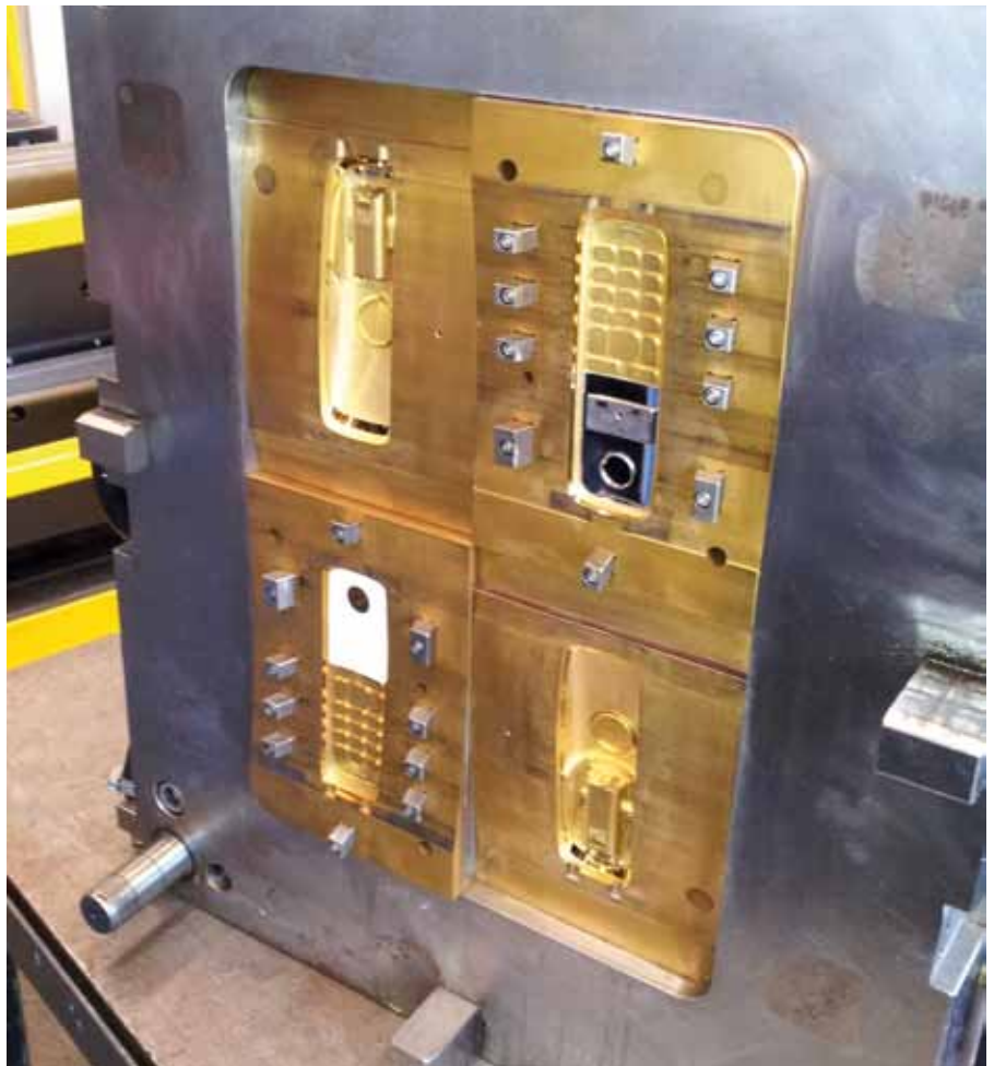
Die WZR Formeinsätze aus technischer Keramik können die optische Qualität spritzgegossener Kunststoffteile deutlich sichtbar verbessern. Die Oberflächenrauigkeit nimmt ab und hässliche Bindenähte lassen sich vermeiden.
