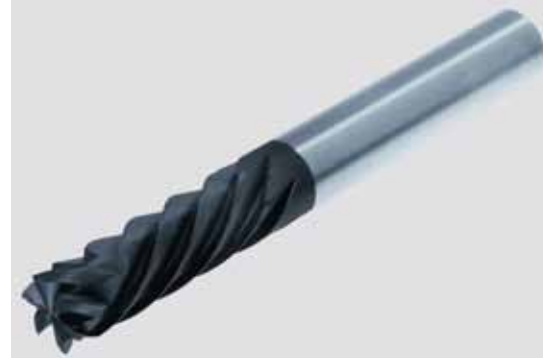
Problemlöser gegen Delamination: Kompressionsfräser sorgen durch ihre Schneidenausbildung mit Rechts- und Linksdrall für gegenläufige Schnittkraftkomponenten. Bild: LMT
