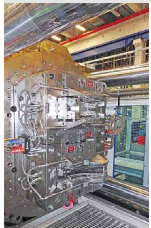
Mehrkomponenten-Drehwerkzeug bei Hella Slovakia Signal Lighting, s.r.o.
