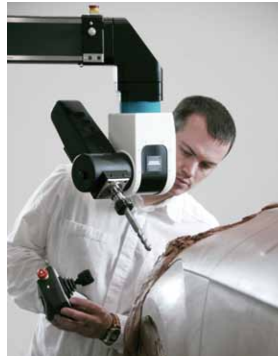
2-Achsen-CNC-Fräskopf Excalibur beim Fräsen eines 1:1 Automobilmodells aus Industrieplastilin, auch Clay genannt.
