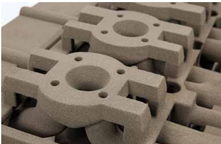
Nahaufnahme der phenolharzgebundenen Sandform
