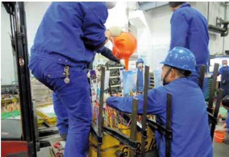
Handverguss einer Formplatte mit 20 kg Frontguss
