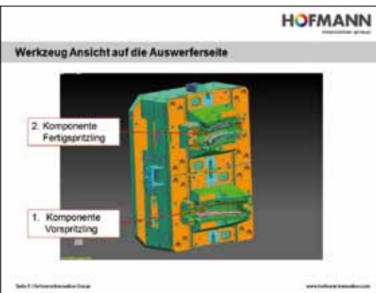
3D-Werkzeugdarstellung für das „Edgelight“ Teil 1 Unten (Ansicht Auswerferseite)
