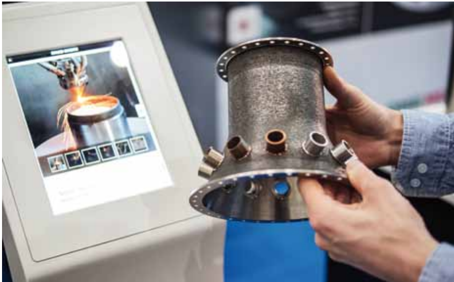
Beim Metall-Lasersintern verschmilzt ein Laserstrahl das in dünnen Schichten verteilte Metallpulver lokal. Es entstehen massive Körper mit homogenem Gefüge. Bild: Messe Erfurt
