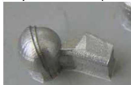
Aktive Qualitätssicherung mit dem QMmeltpool: Für das menschliche Auge ist kein Fehler erkennbar. Abweichungen der Bauteilqualität erkennt QMmeltpool. Bild: Concept Laser
