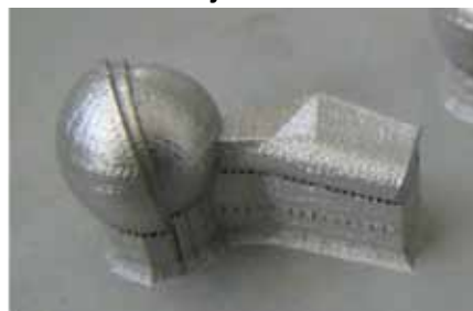
Aktive Qualitätssicherung mit dem QMmeltpool: Für das menschliche Auge ist kein Fehler erkennbar. Abweichungen der Bauteilqualität erkennt QMmeltpool. Bild: Concept Laser
