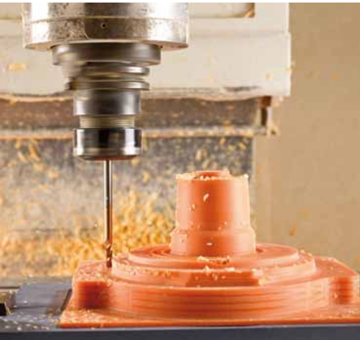
Ermöglicht extrem hohe Abformstückzahlen: das neue Gießerei-Blockmaterial RAKU-TOOLWB-1258.
