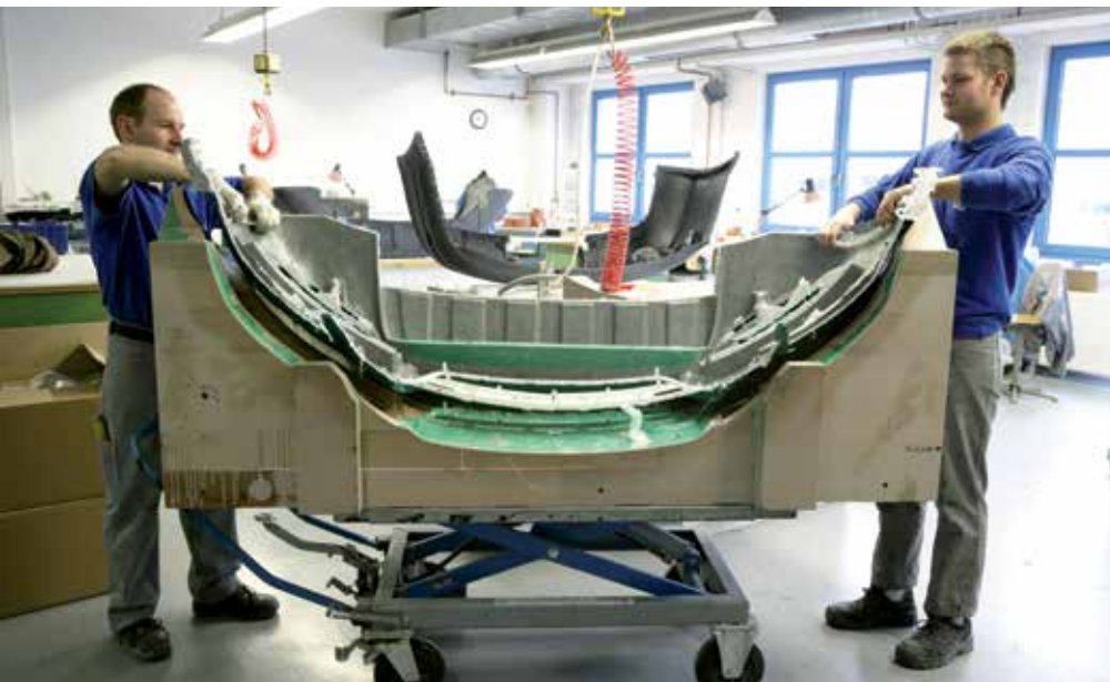
Ausheben aus der Form Bilder: Kegelmann
