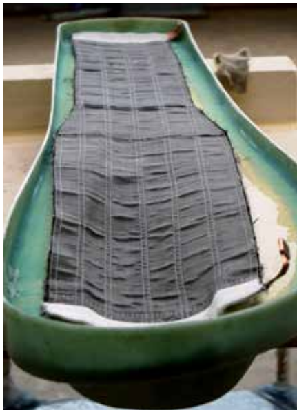
Energieeffizientes Temperiersystem für Formenwerkzeuge von Fibretec Bild: Fibretec
