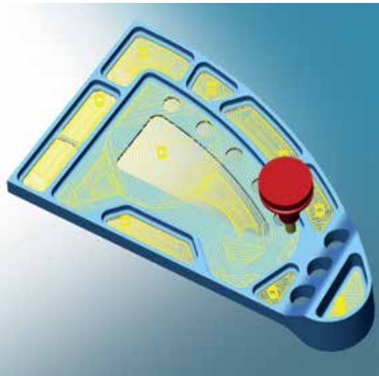
High-Performance-Schruppbearbeitung mit spiralförmigen und trochoidalen Werkzeugbahnen
