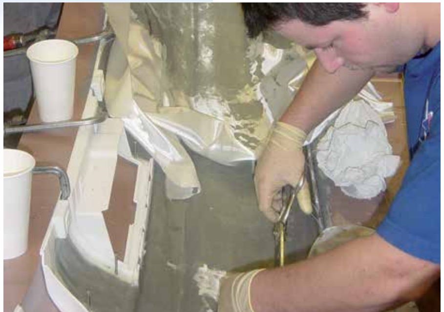
GFK-Laminat in einer CNC-gefrästen Negativform
