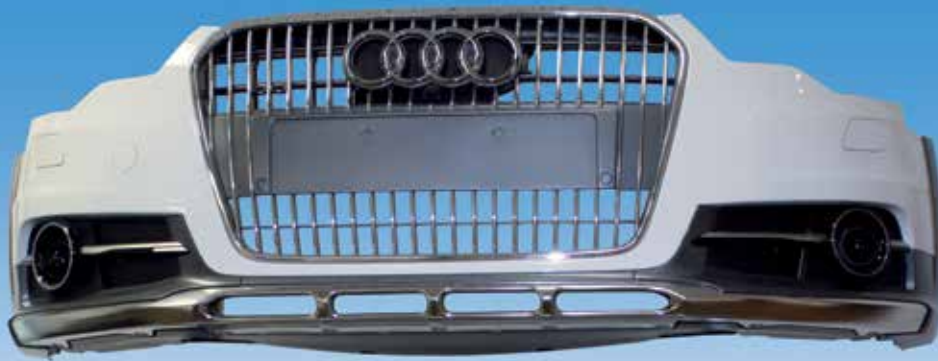
Hybrider Prototyp eines Stoßfängers mit SLS und GFK-Verbundwerkstoffen
