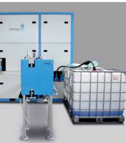
Entgasungs- und Dosieranlage für höhere Produktqualität von Hedrich Bild: Hedrich
