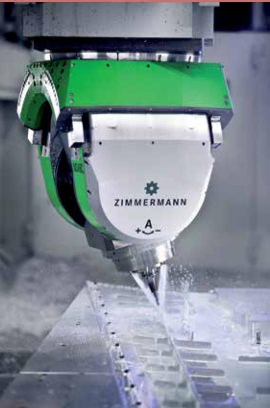
Mit dem Drei-Achs-Fräskopf M3 ABC lassen sich Werkstücke mit konstantem Vorschub sechsachsig simultan bearbeiten. Bild: F. Zimmermann
