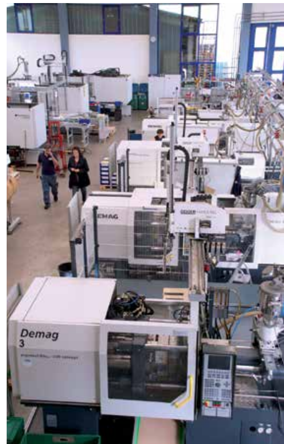
In der eigenen Spritzerei produzieren zehn, zum Teil hoch automatisierte Maschinen überwiegend stark beanspruchte technische Kunststoffteile.
