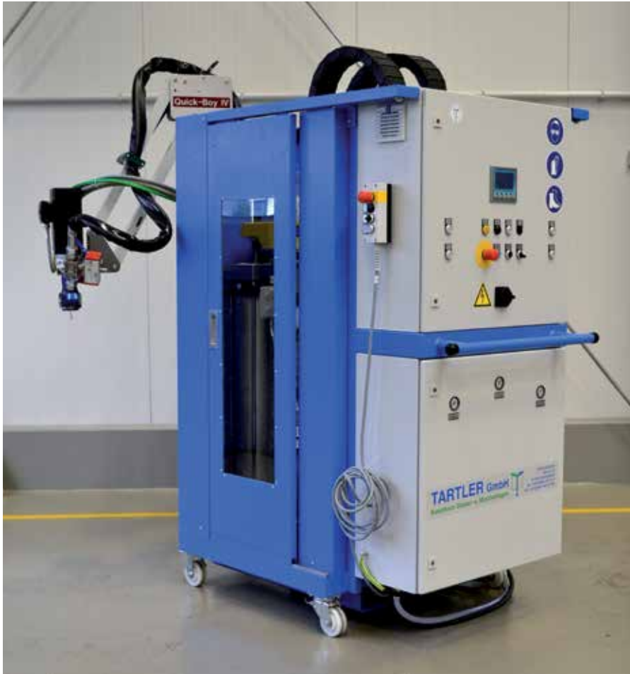
Kompakte Zweikomponenten-Anlage Nodopox 50 V mit Volumenstromregelung und beweglichem Doppelarm-Ausleger Quick-Boy.
