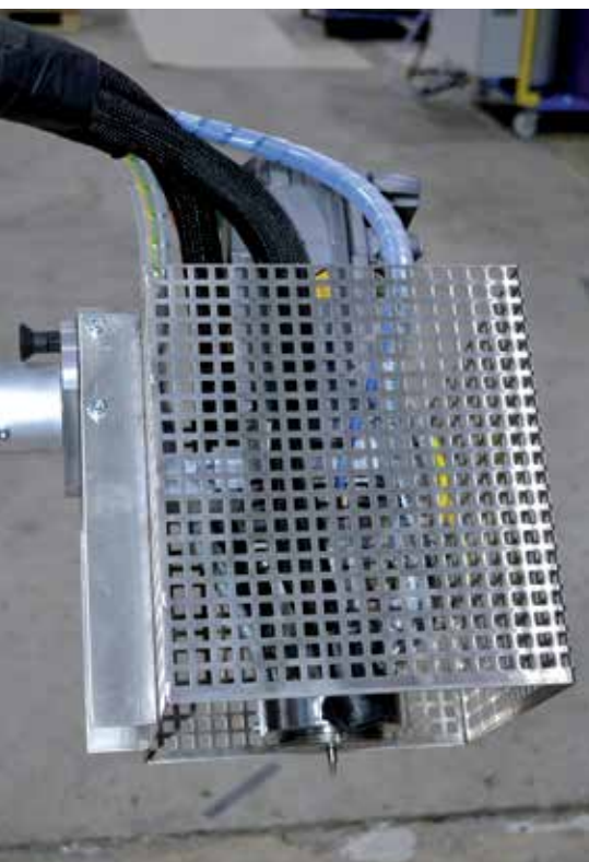
Vom Tartler-Engineering kundenspezifisch gefertigter Mischkopfhalter mit zusätzlichem Schutzkäfig. Bilder: Tartler
