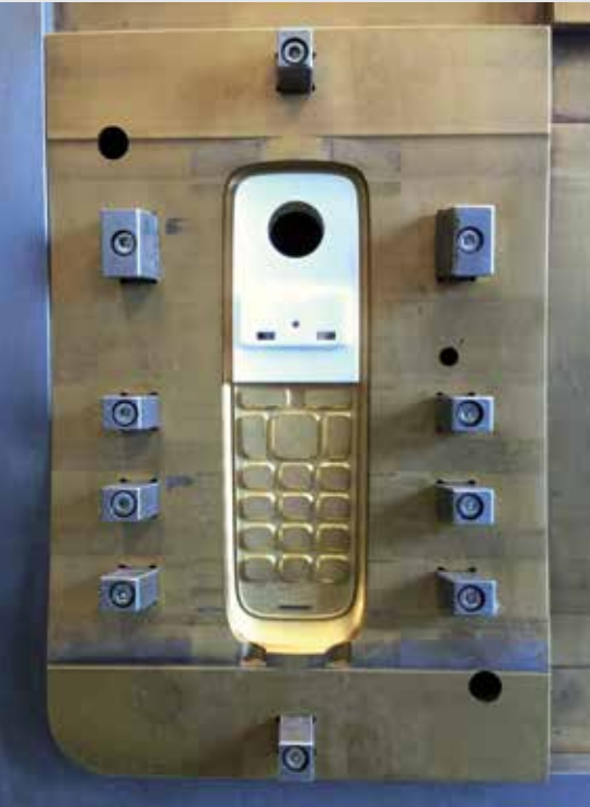
Beim Spritzgießen von Telefon-Gehäuseschalen konnten durch den Einsatz der keramischen Werkzeug-Inlays von WZR sicht- und fühlbare Oberflächenoptimierungen erzielt werden.
