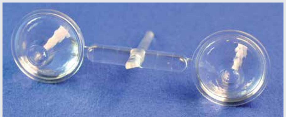
Kollimatorlinsen werden zur Parallelbündelung von Röntgen- und Gammastrahlen genutzt. Rechts im Bild die mit den keramischen Formeinsätzen von WZR spritzgegossenen Linsen; die linke Linse wurde konventionell mit Stahleinsatz gegossen. Bilder: WZR
