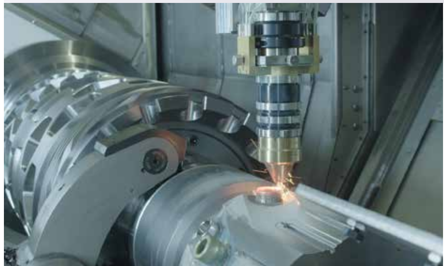
Der vom Fraunhofer IWS in Dresden entwickelte Auftragskopf wird in der Maschine vorgehalten und kann über die WFLPrismenwerkzeugschnittstelle aufgenommen werden. Bild: WFL
