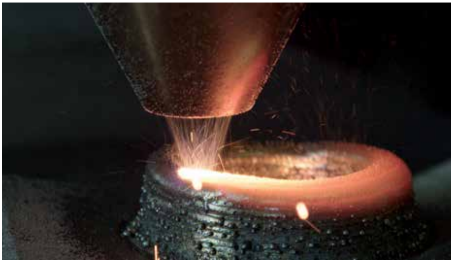
Der Auftragskopf besteht aus einer Düse, durch die die Metallpulverpartikel fokussiert zur Auftragsstelle transportiert werden. Ein Schutzgas verhindert Oxidationsprozesse und dient als Träger- und Transportmedium. Der Laserstrahl wird durch das Zentrum der Düse auf den Auftragspunkt fokussiert. Bild: WFL
