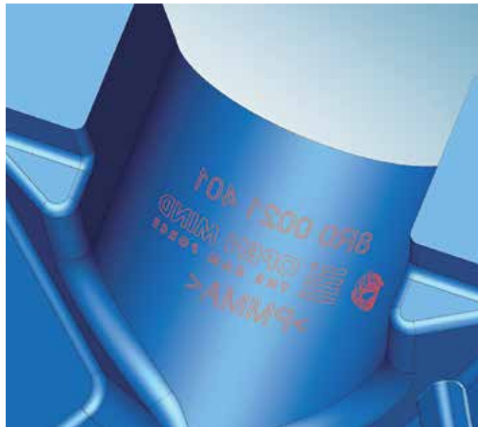
5-Achs-Tangentialbearbeitung: effizientes Schichten von beliebig krümmungstetigen Flächen mit konischen Tonnenfräsern.
