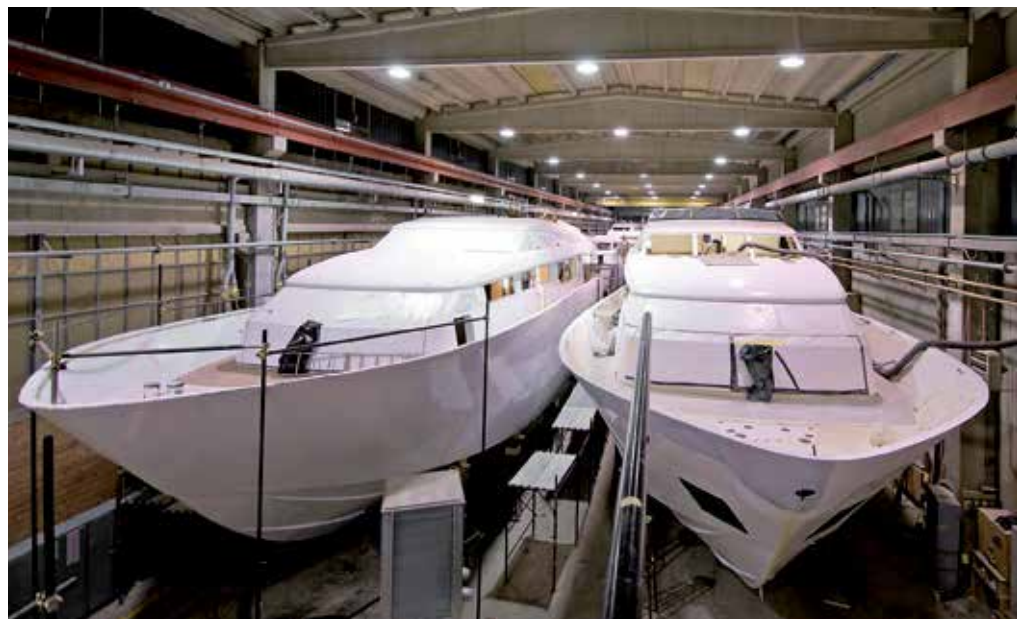
Auch im Bootsbau werden Close Contour Pasten eingesetzt. Da die Paste nahe der Endkontur aufgetragen wird und die Verwendung kostengünstiger Unterbauten möglich ist, können große Modelle einfacher und schneller hergestellt werden. Auch der Finish-Aufwand wird durch die feine, homogene Oberfläche ohne Klebefugen deutlich reduziert. Bild: Rampf
