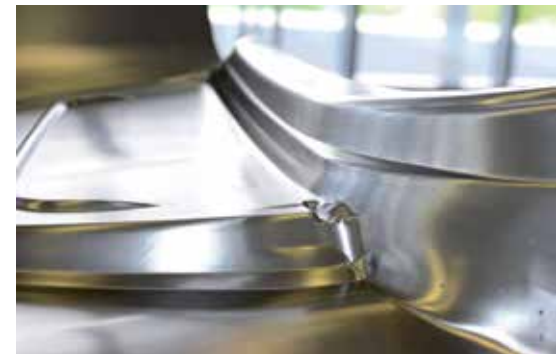
Glatt gefräste Wirkflächenoberfläche, ohne dass der Anwender manuell nacharbeiten muss.
