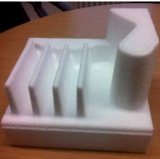
Bild 047: Ein Anschauungsmodell, anhand dessen die Produkteigenschaften exemplarisch gezeigt werden – Oberfläche nach der Bearbeitung, Festigkeit des Modellschaumes, Kantenschärfe, Eindruckfestigkeit
