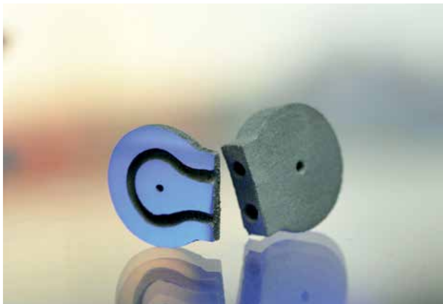
Drahtziehdüse mit integriertem Kühlkanal im Rohzustand nach dem Sintern: Am Fraunhofer IKTS in Dresden werden nach Kundenanforderung über das 3D-Binder-Jetting Hartmetallbauteile entwickelt. Bild: Fraunhofer IKT
