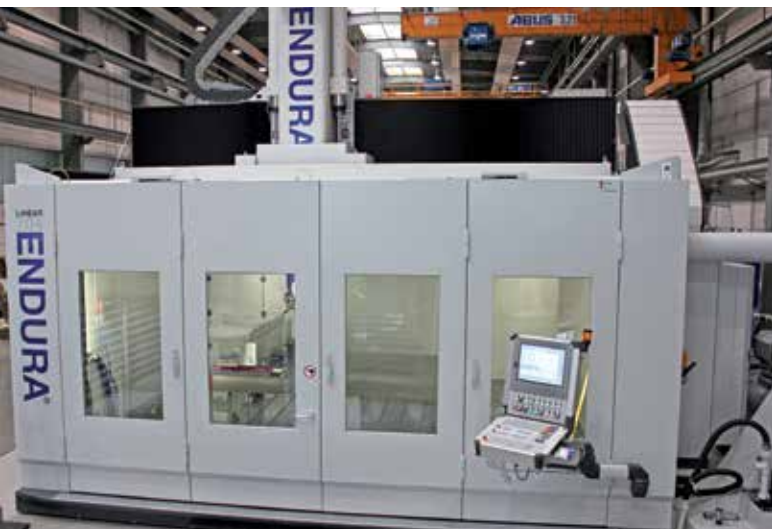
Die Endura 704Linear ist eine 5-Achs-Fräsmaschine in kompakter Portalbauweise mit Linearmotor-Antriebstechnik und fünf CNC-gesteuerten, simultan verfahrbaren Achsen. Aufgrund ihrer sehr vielseitigen Einsatzfähigkeit hat Fooke sie im Vorführzentrum installiert.
