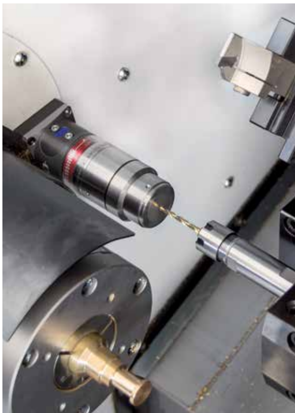
Der neue Werkzeugtaster Z-Nano RC mit universeller Software zur horizontalen Montage ermöglicht jetzt auch den Einsatz in Drehmaschinen und Dreh-Fräszentren. Bild: Blum
