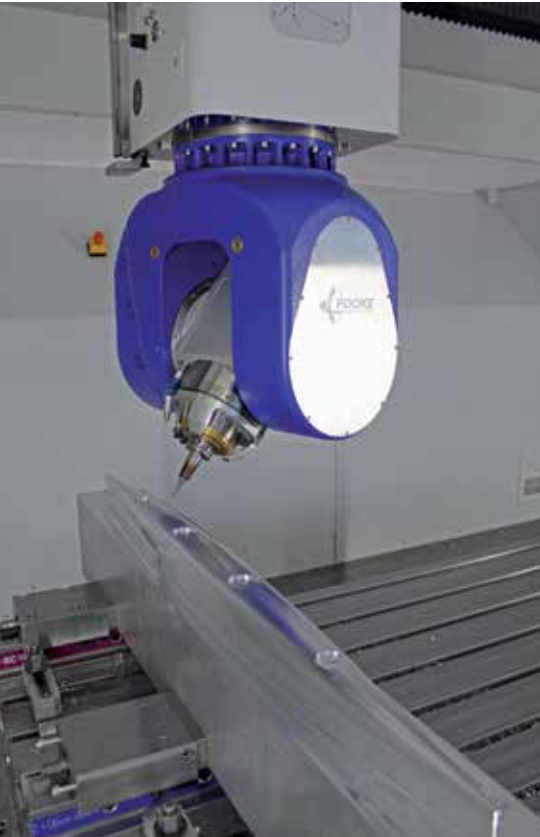
Die Fooke GmbH bearbeitete im Vorführzentrum auf ihrem fünfachsigen Bearbeitungszentrum Endura 704Linear an anspruchsvolles Flugzeugmodell aus Aluminium. Die Programmierung übernahm der CAD/CAM-Hersteller Vero Software mit dem System WorkNC.
