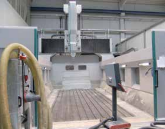
Die Portalfräsmaschine FZ 37 bearbeitet Bauteile aus weichen und zähen Werkstoffen schnell und komplett von fünf Seiten. Mit dem großen Arbeitsraum ist Schröter flexibel bei auftragsspezifischen Anforderungen.
