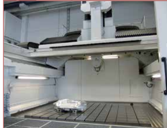
Die FZ33 c compact besitzt einen eigensteifen Basiskörper aus Guss mit integrierter Tischplatte. Ein Maschinenfundament ist nicht erforderlich.
