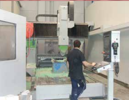
Die Fünf-Achsen-Hochgeschwindigkeits-Portalfräsmaschine vom Typ FZ 30 mit Fahrwegen von 6.000 mal 3.360 mal 1.500 mm.
