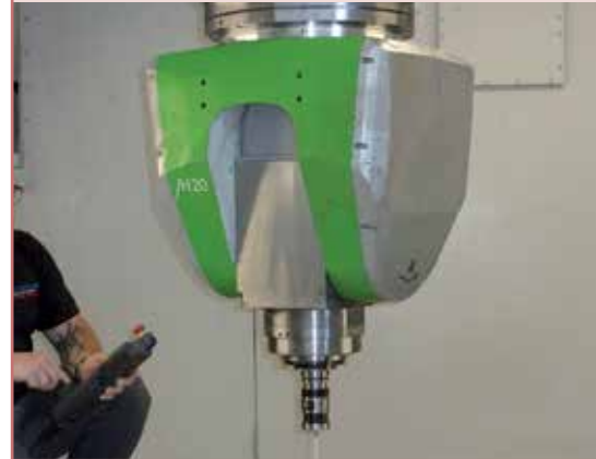
Bei den Maschinen kommen die Zimmermann-Fräsköpfe vom Typ VH 20 zum Einsatz. Durch den symmetrischen Aufbau und die nach unten verjüngte kompakte Bauform besitzt dieser eine geringe Störkontur.
