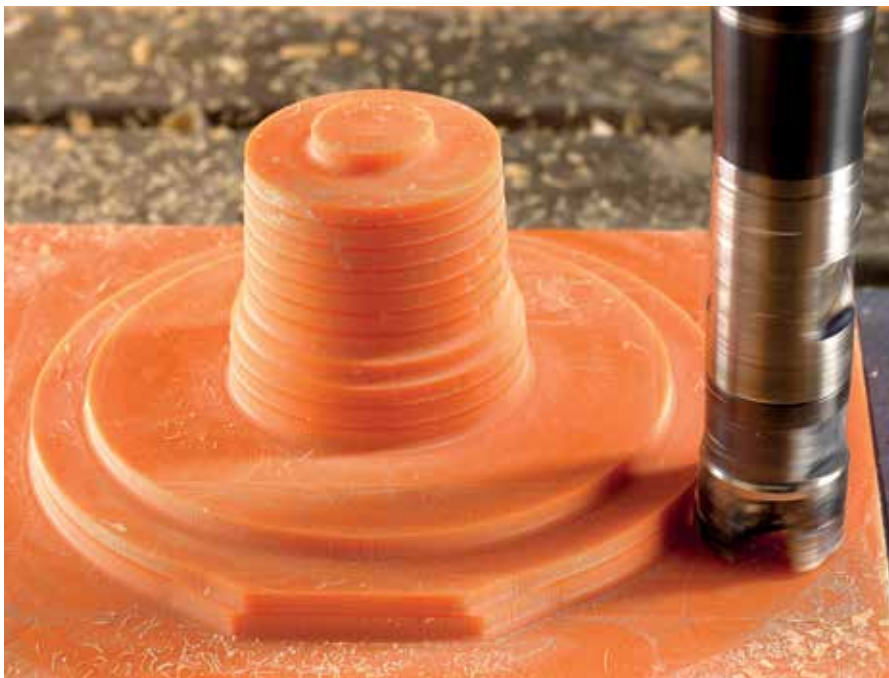
Das neueste Gießerei-Blockmaterial RAKU-TOOL WB-1258 aus Polyurethan von RAMPF: Aufgrund der extrem hohen Abrasionsbeständigkeit sind hiermit Abformstückzahlen möglich, die sonst nur mit Flüssigsystemen erreicht werden können.
