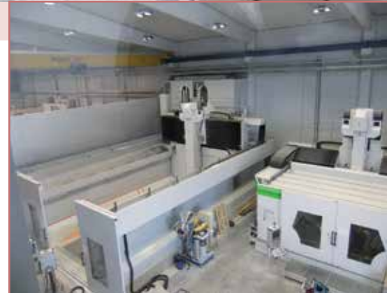
Der Modell- und Formenbauer hat jetzt zwei neue Anlagen von Zimmermann im Einsatz – eine FZ 37 (li) und eine FZ 33 c compact.
