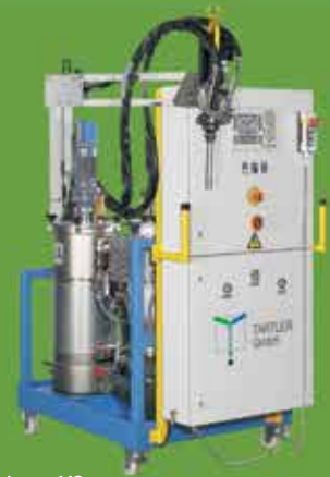
Nodopur VS Die Anlage zur rationellen Verarbeitung von pastösen Kunststoffen aus Polyurethan- oder Epoxidharzen. Automatische Regelung mittels Volumenstromzähler.
