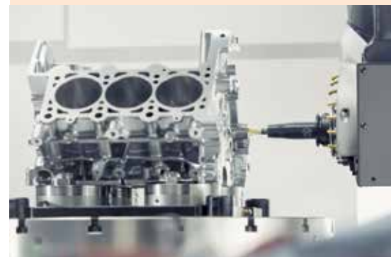
Die Werkstückdirektspannung ermöglicht eine optimale Zugänglichkeit und eine definierte Spannsituation. Zugleich gewährleistet das Hydrodehnspannfutter eine perfekte Schwingungsdämpfung. Bild: Schunk
