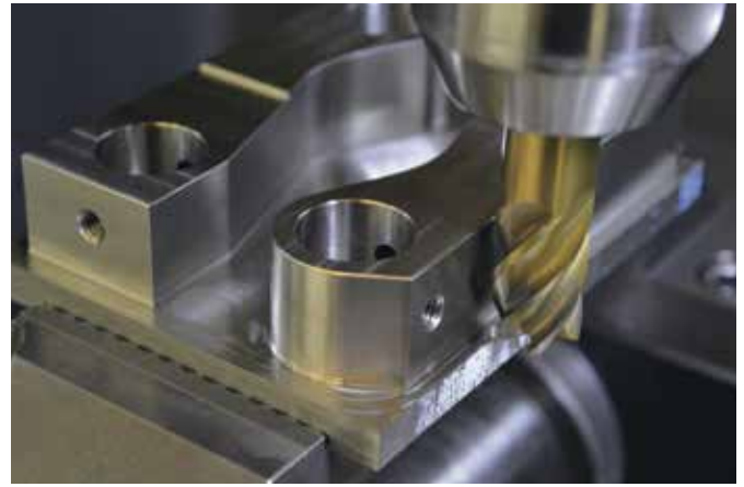
Bei den Fräsern sind nicht mehr nur fünf Millimeter der Schneide, sondern die komplette Schneidenlänge nutzbar.
