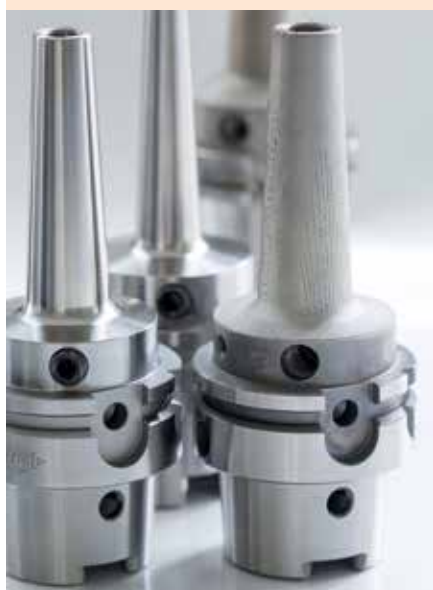
Auf den konventionell gefertigten Grundkörper wird per selektivem Laserschmelzen der Funktionsbereich aufgebracht. Bild: Mapal
