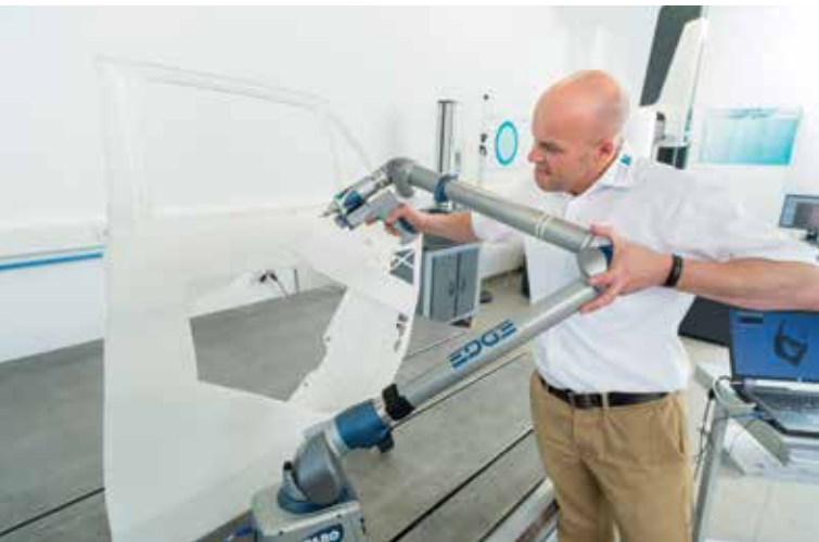
Qualitätsanalyse beim Lasersintern einer Pkw-Tür mit FARO Edge ScanArm HD mit Laser Line Probe HD
