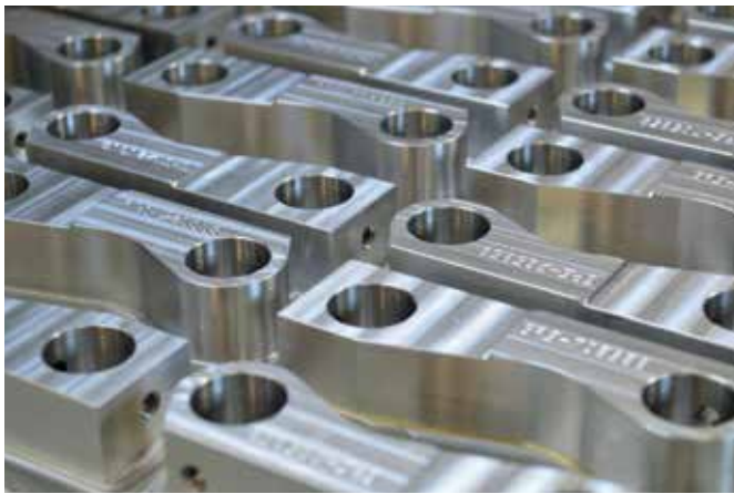
Statt wie bisher fünf Hebel werden mit dem wellenförmige Schruppen aktuell 20 Stück und mehr mit nur einem Werkzeug gefertigt.
