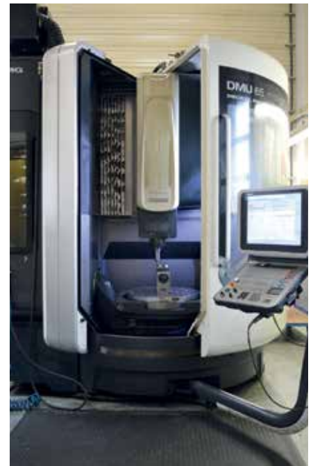
Bei GPS Reisacher fräst man mit Edgcam auch komplexe Bauteile 5-Achs-Simultan. Da ist es von Vorteil, dass man beim Schrubbens Parameter verändern und Begrenzungen in kurzer Zeit definieren kann.
