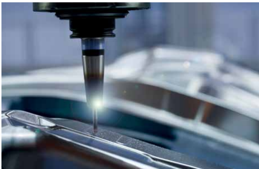
Die neue WorkNC-Hochvorschubstrategie berücksichtigt Fräswerkzeuge jeglicher Kontur. So entstehen keine undefinierten Aufmaße, welche die nachfolgende Schlichtbearbeitung beeinträchtigen könnten.
