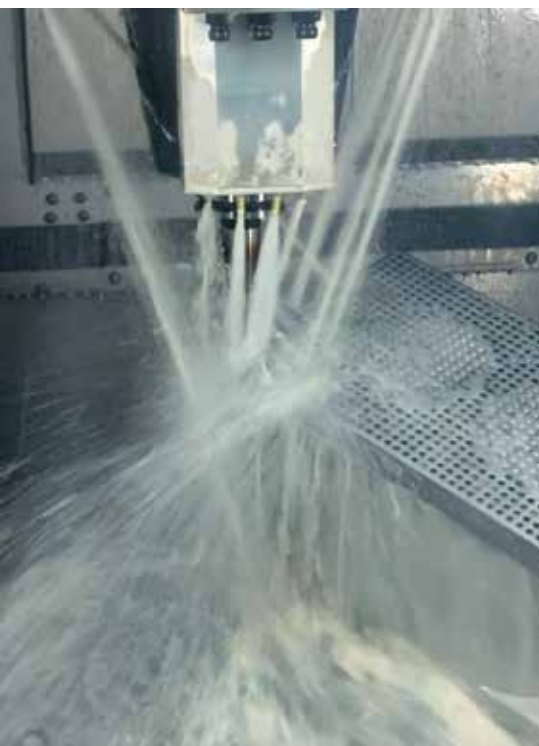
Fräsbearbeitung auf der Hermle C42: Auf einer Lochrasterplatte wird ein kleines Bauteil für eine Lehre gefräst. Bilder: MHO
