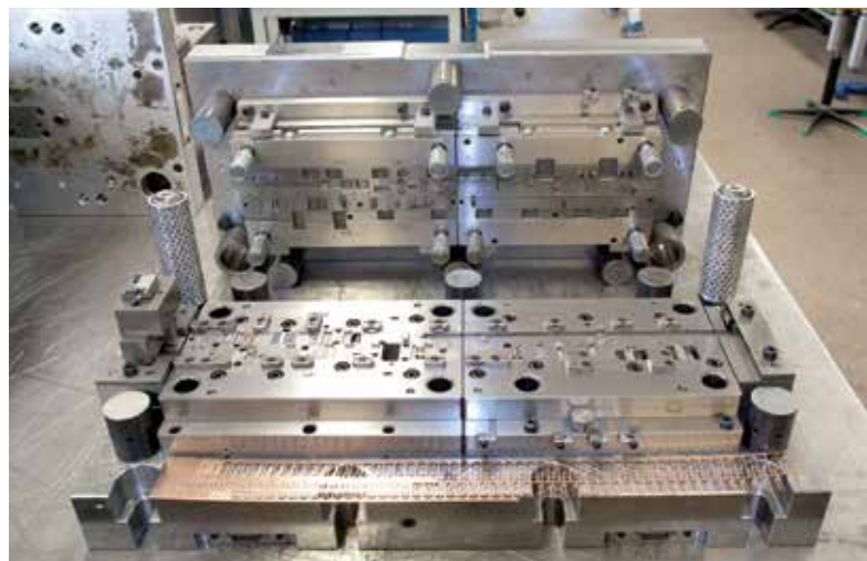
Ober- und Unterseite eines fertig abgemusterten Folgeverbundwerkzeugs mit Streifenlayout. Die Durchlaufzeit im Werkzeugbau beträgt im Schnitt etwa 20 Wochen.
