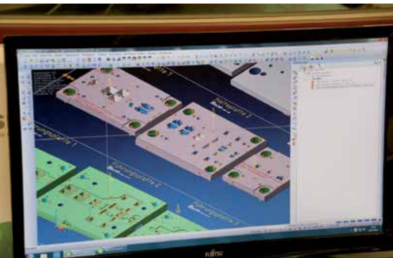
VISI PEPS-Wire erkennt erodierbare Geometrien des 3D-CAD-Modells automatisch und unterstützt auch Funktionen wie den automatischen Wechsel der Drahtdicken.
