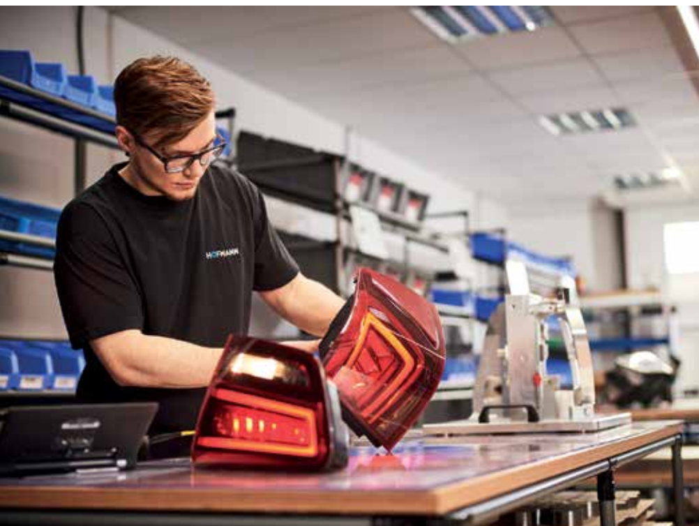
Baugruppenmontage von Leuchten bei den „Modellbauern“ von Hofmann – Ihr Möglichmacher Bilder: Hofmann
