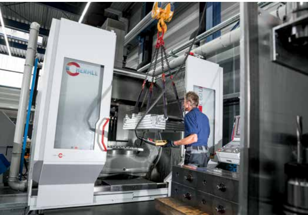
Einfache Beladung des BAZ C 60 U per Kran und bei geöffneter Doppeltüre
