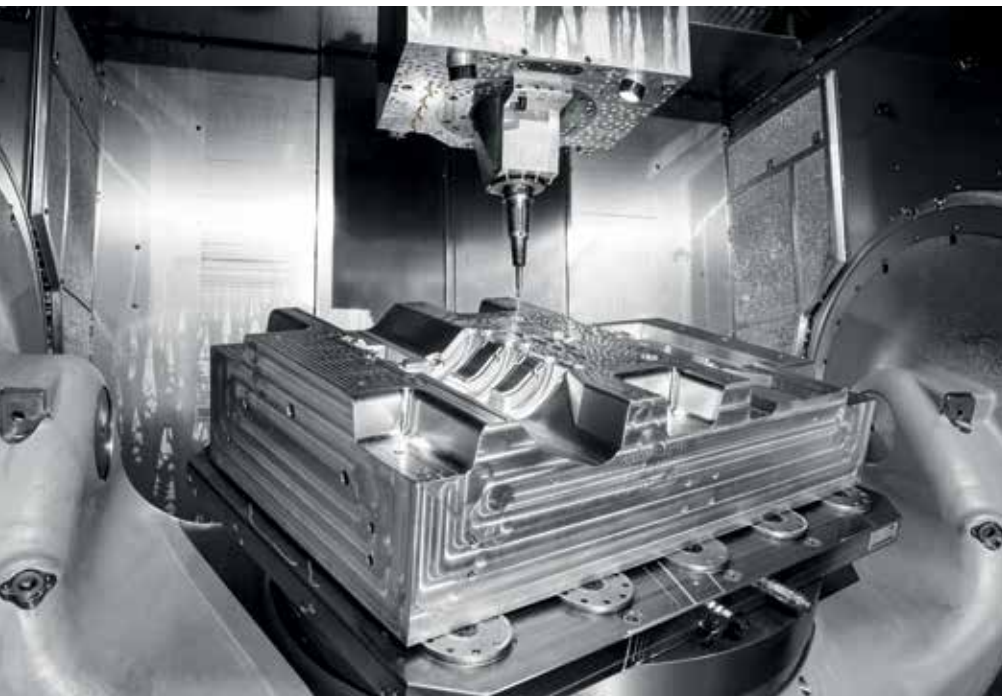
Der große Arbeitsraum mit NC-Schwenkrundtisch ermöglicht die 5-Achsen-Komplettbearbeitung großer und schwerer Formplatten in einer Aufspannung. Das Maschinenkonzept „3 Achsen im Werkzeug und 2 Achsen im Werkstück“ erlaubt eine optimale Anstellung der Werkzeuge.
