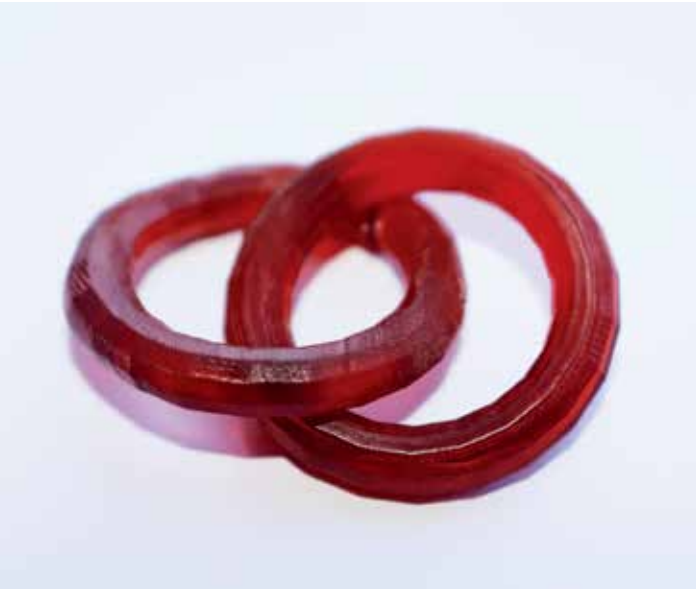
Mit dem neuen „TwoCure“-Verfahren aufgebaute Ring-in-Ring-Struktur, hergestellt ohne tragende Stützstrukturen und ohne direkten Kontakt zur Bauplattform.
