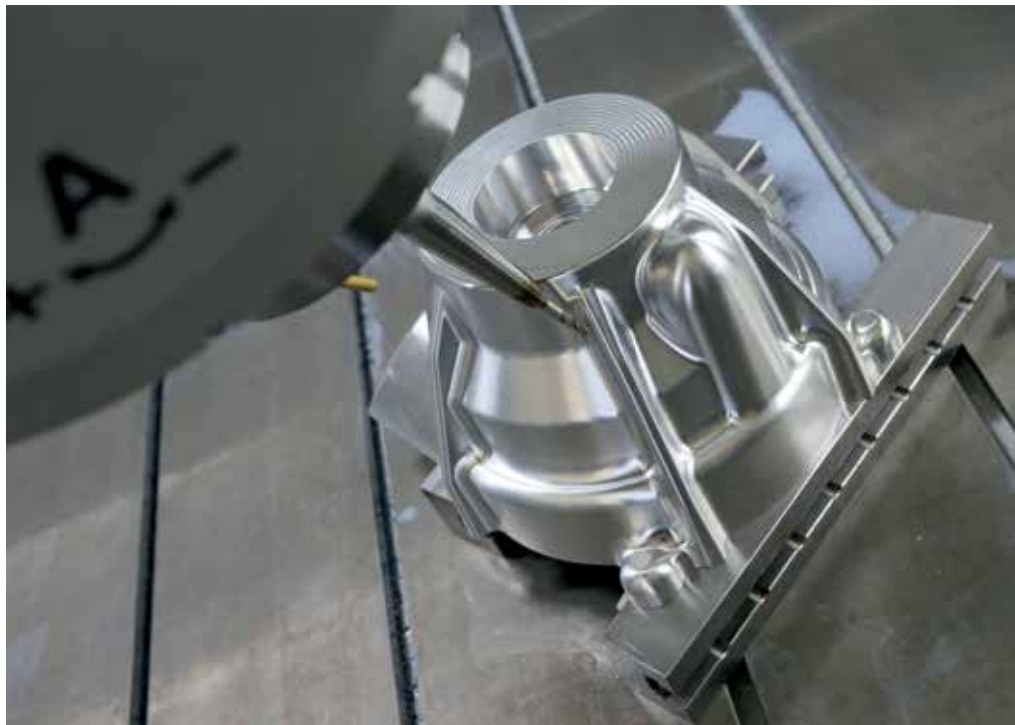
5-Achs-gefrästes Modell aus Aluminium EN AW-5083
