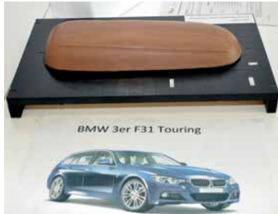
Projektarbeit von angehenden Technischen Modellbauern der Fachrichtung Karosserie und Produktion im 3. Ausbildungsjahr: Umgesetzt wurde der Auftrag, ein neues Designmodell einer Dachbox für einen BMW 3er F31 Touring zu entwerfen und zu fertigen.
