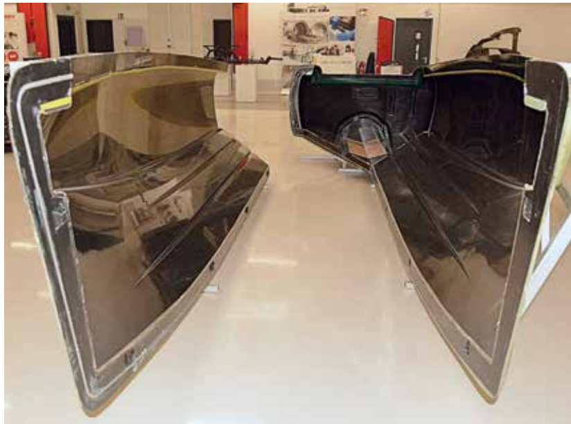
Das größte Exponat der Ausstellung: Diese Produktionsform für einen Bootsrumph wurde via Resin Infusion gefertigt. Zum Einsatz kamen das Oberflächenharz RAKU TOOL ZEG-2104 / EH-2950-1 sowie das Resin Infusion System RAKU TOOL EI-2500
