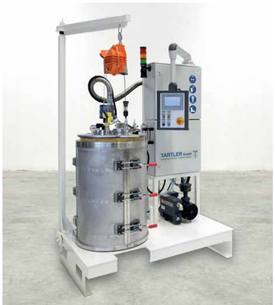
Mit der TAVA 200 F lassen sich viele verschiedene hochviskose und pastöse Medien ohne Lufteinschlüsse in Deckelfässer abfüllen lassen. Bild: Tartler
