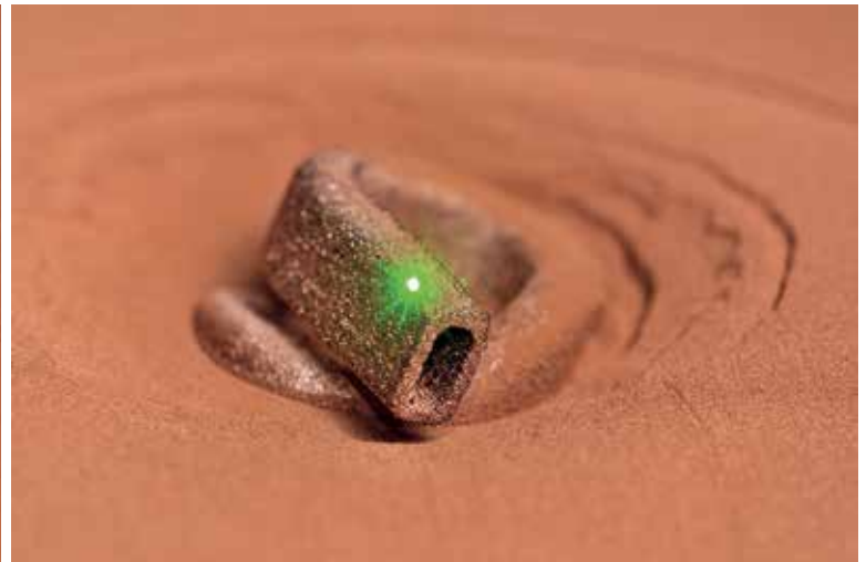
„SLM in grün“: Mit dem neuen Prozess sollen sich auch Bauteile aus reinem Kupfer additiv fertigen lassen. Bilder: Fraunhofer ILT
