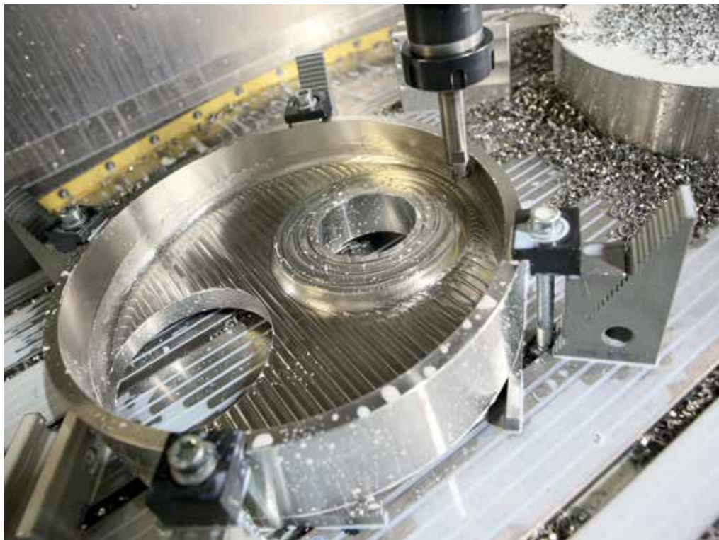
Schlichtbearbeitung eines Einschweißflansches aus Edelstahl V4A
