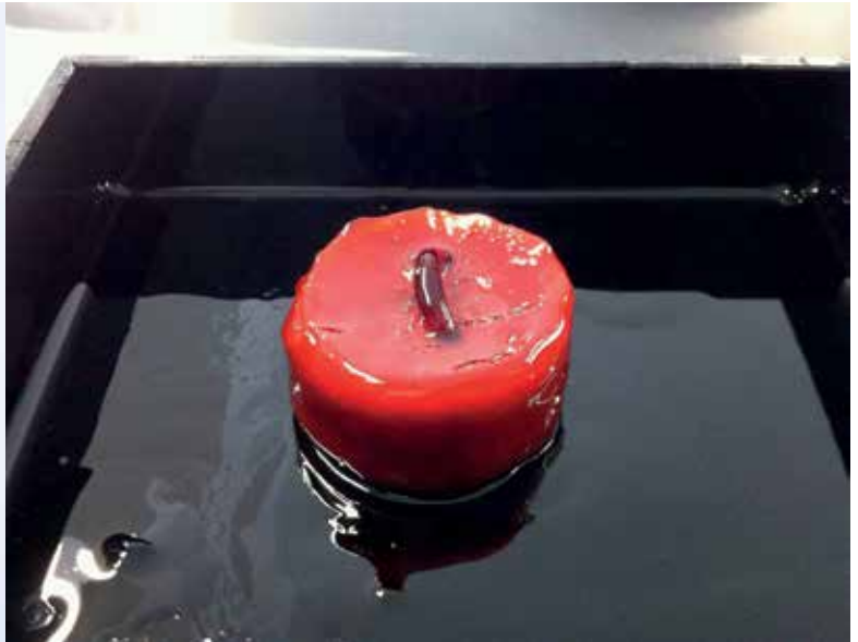
Verflüssigung eines zuvor aufgebauten Bauteils, bei der das stützende Material abfließt. Bilder: Fraunhofer ILT, Rapid Shape
