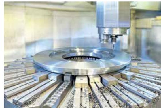
Hybridfutter vereinen ein klassisches Zentrierfutter und eine runde Magnetspannplatte. Sie zentrieren die Werkstücke und spannen diese deformationsfrei. Bilder: Schunk
