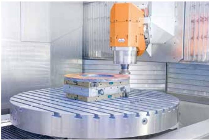
Ob rund, eckig oder kubisch, ob Stahl oder Guss – die doppelten Quadratpolplatten in dieser Anwendung ermöglichen eine hochflexible und zugleich deformationsfreie Werkstückspannung.
