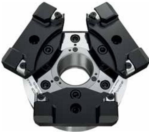
*Hydraulische Ausgleichsbacken kombinieren eine hochpräzise, deformationsarme Werkstückspannung mit schwingungsdämpfenden Eigenschaften. Auch bei hohen Drehzahlen bleibt die Spannkraft vollständig erhalten.*
