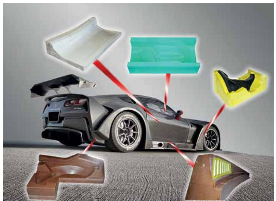
In Deutschland arbeitet RAMPF mit dem Racing-Team Callaway Competition zusammen. Für ihr aktuelles Fahrzeug Corvette C7 GT3-R wurden RAKU TOOL Block- und Flüssigmaterialien für die Herstellung verschiedener Leichtbauteile verwendet.
