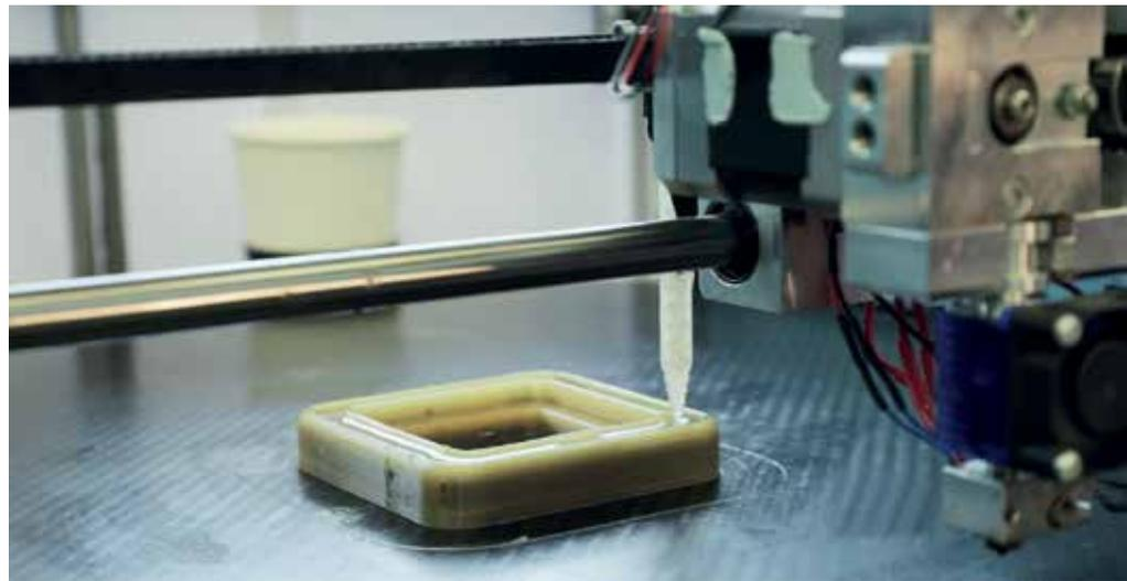
Beim additiven Freiformgießen wird die Hülle des Bauteils im FDM-Druck aufgebaut. Anschließend befüllt eine Dosiereinheit im Drucker die Form mit einem Zwei-Komponenten-Gemisch.
