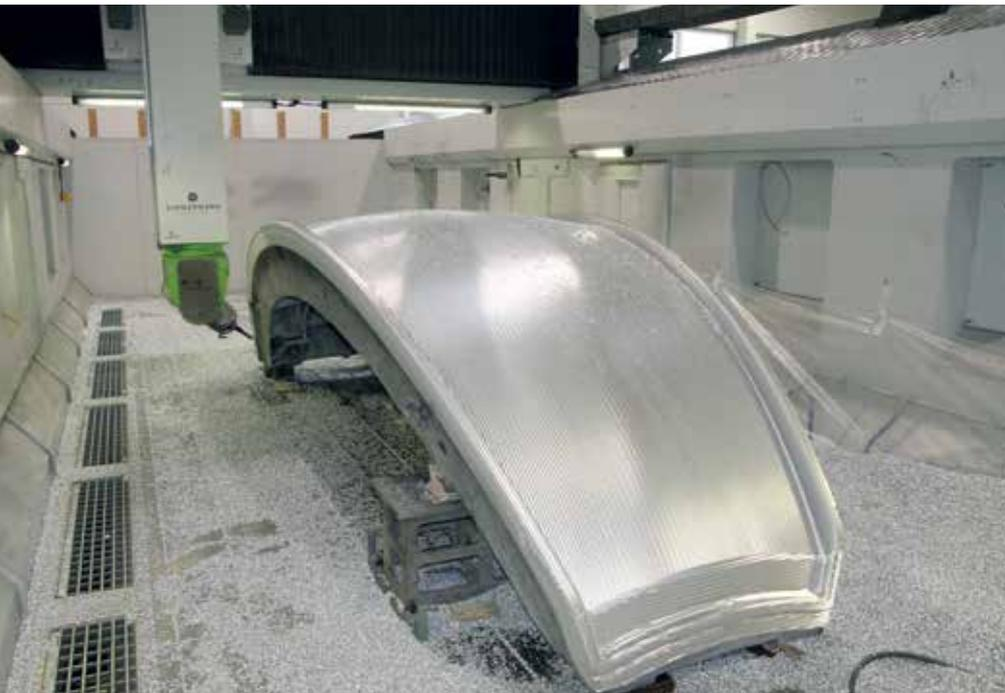
5-Achs Bearbeitung einer gegossenen Aluminiumform
