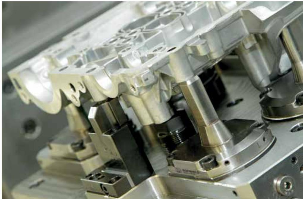
Große Kräfte auf kleinstem Raum: Die hydraulische Spanntechnik hat sich beim Spannen von schweren Werkstücken bewährt. Bild: Römheld
