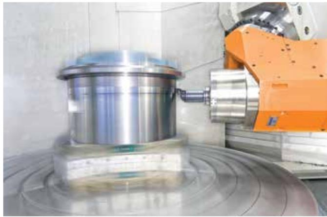
Auf diesen Quadratpolplatten können im Wechsel unterschiedliche Teile bearbeitet werden. Zudem sind sie mit wenigen Handgriffen vom Maschinentisch entfernt.
