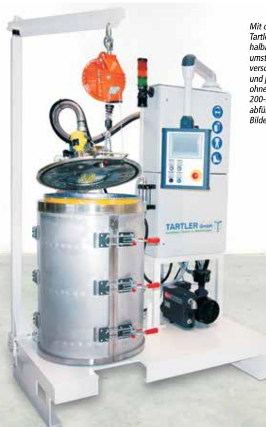
Mit dem TAVA 200 F bietet Tartler eine vielseitige halbautomatische Vakuumstation, mit der sich verschiedene hochviskose und pastöse Medien ohne Lufteinschlüsse in 200-Liter-Deckelfässer abfüllen lassen.
