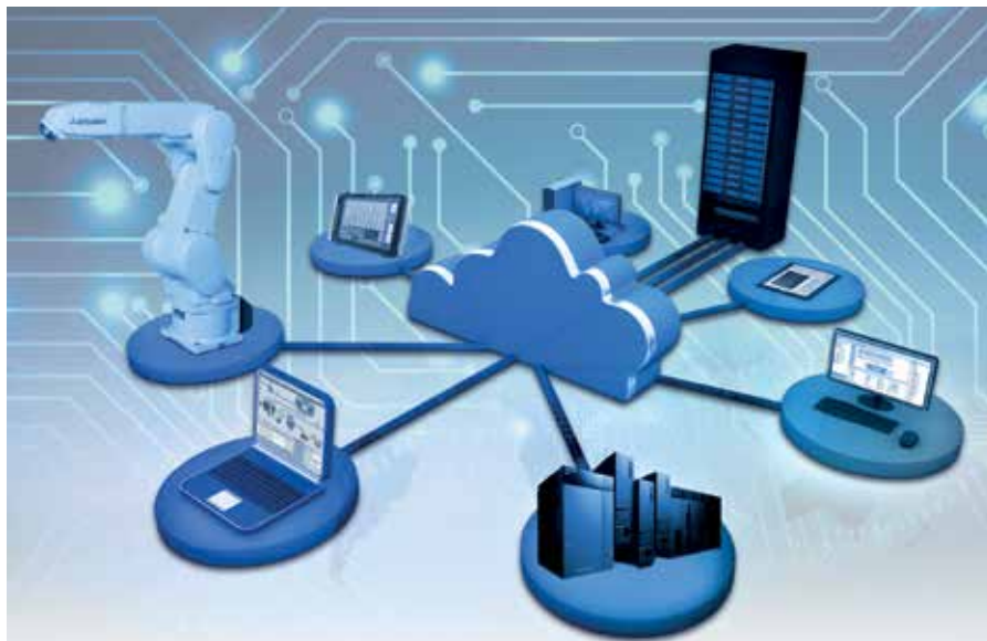
Künstliche Intelligenz für vorausschauende Wartung: Die Daten aus der Steuerung eines Mitsubishi-Roboters werden an eine SPS übermittelt, wo sie auf der Geräteebene bearbeitet werden (Edge Computing) und anschließend vorverarbeitet in die Cloud zur Analyse durch die KI-Plattform von IBM Watson gehen. Bild: Mitsubishi
