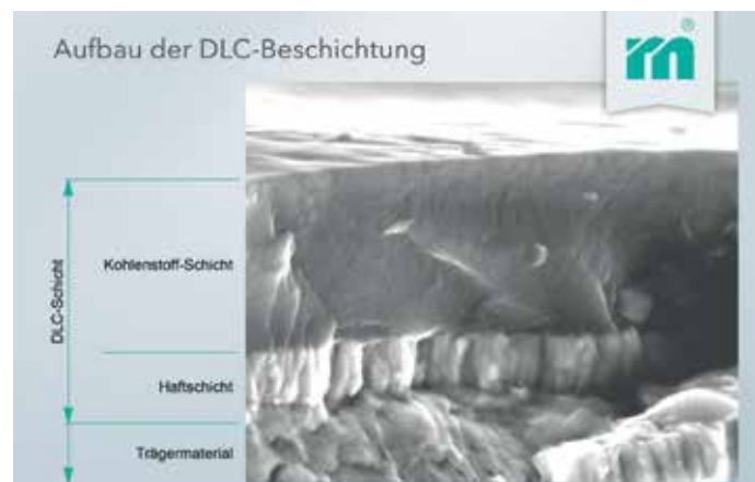
Aufbau und Eigenschaften einer DLC-Beschichtung
