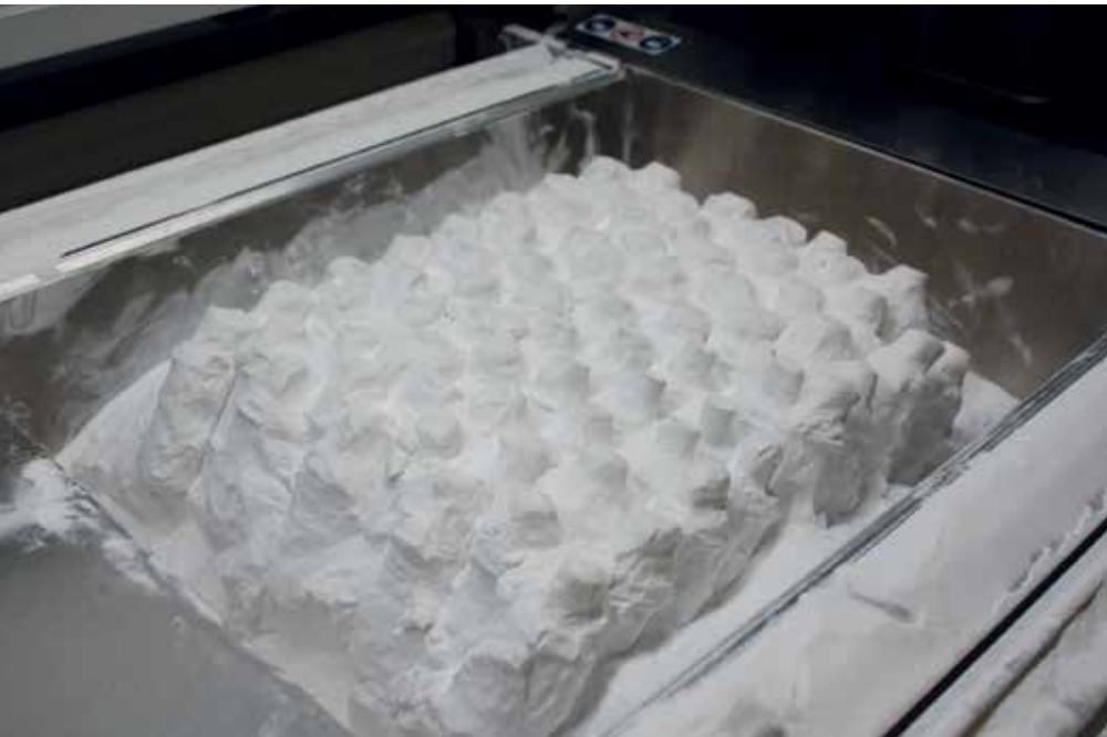
Bauraum HP Jet Fusion mit dem Ersatzteil Waschbeckensieb für Lufthansa Technik Bild: Kegelman
