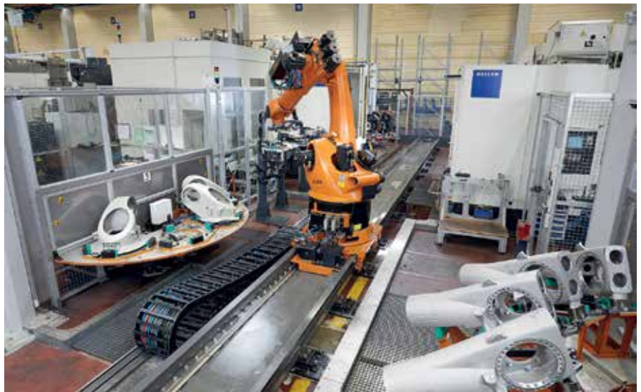
Vollautomatisierte, vernetzte Roboterzelle von Kuka mit zwei Heller-Bearbeitungszentren: Alle aktiven Komponenten sind miteinander und mit der Kuka-Cloud über die Kuka Connectivity Box verbunden. Bild: Kuka
