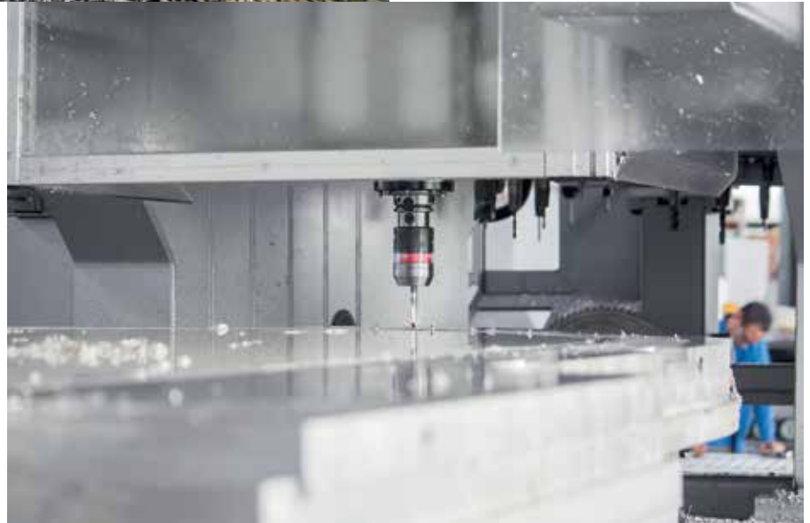
Blum hat seine Messtaster auf hohe Verfah- und Antastgeschwindigkeiten ausgelegt. Bild: Blum-Novotest
