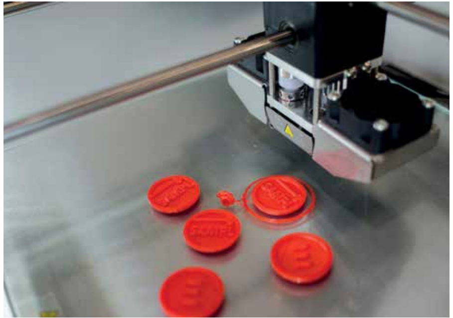
Mit dem 3D-Drucker lassen sich in kurzer Zeit maßgeschneiderte Ersatzteile herstellen.
