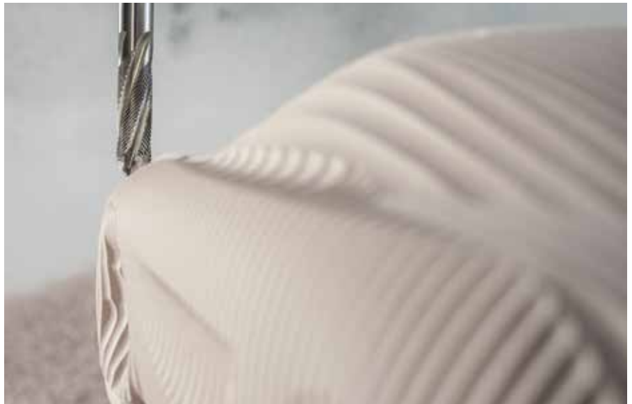
Schruppen und Schlichten erfolgen ohne Werkzeugwechsel in einem Arbeitsgang. Bild: Hufschmied
