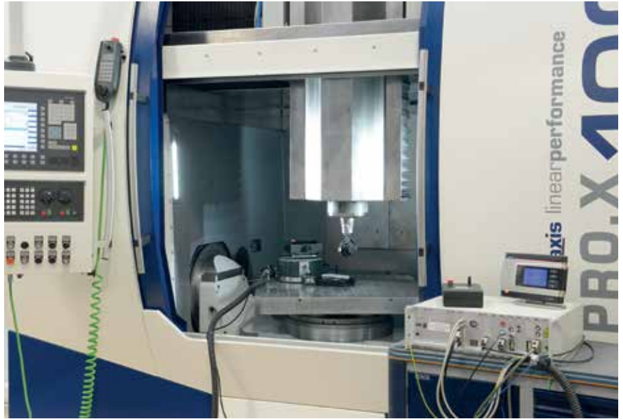
Das Fraunhofer IPT untersucht, wie sich eine Maschinenkomponente für senkrechte Bewegungen (Z-Achse) aus Kohlefaserverbundkunststoff (CFK) in einer neuen Werkzeugmaschine verhält und wie sich der Z-Schlitten optimieren lässt. Bild: Fraunhofer IPT
