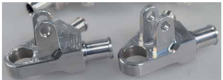
It's Greenteam-Time: Für das Rennteam der Uni Stuttgart fräste der Prototypenbauer die Radträger aus einer Aluminiumlegierung.
