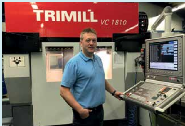
Marco Hillebrand an der neuen 3-Achs CNC-Fräse mit Fahrwegen von 1810mm x 1000mm x 700mm
