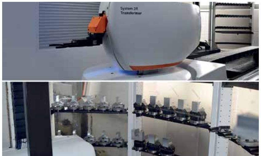
Automatisch mit Nullspannsystem gewechselt: Der Prototypenbauer setzt als einer der wenigen in der Branche auf eine Roboterzelle mit Palettenwechsler für die Bauteilzuführung.
