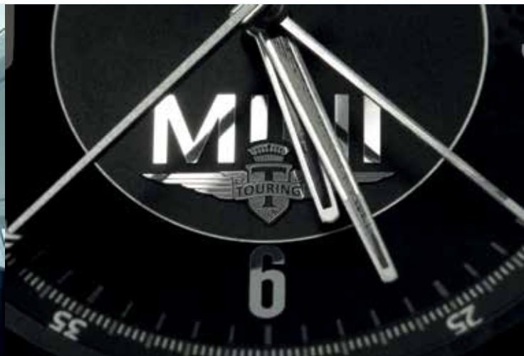
Funktionierende Fahrzeuguhr für fahrbares Modell des Mini Superleggera Vision Concept, Zifferblattdurchmesser 42mm
