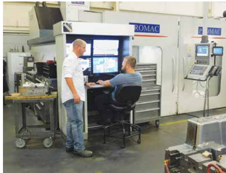
Mit der Tebis Simulationstechnologie kann vor der maschinellen Fräsbearbeitung Kollisionsfreiheit, Effizienz und Oberflächengüte der Bearbeitungsprogramme überprüft werden.
