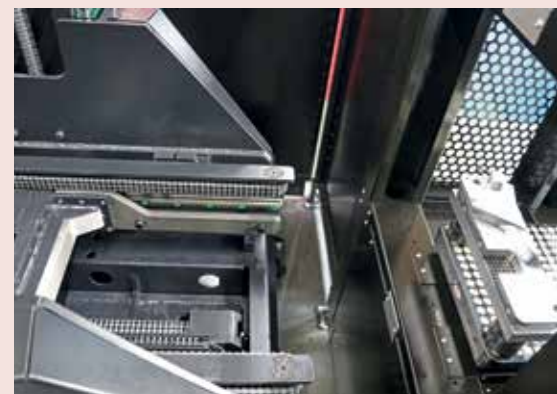
Ein schienengeführtes Handlingsystem transportiert die Paletten zwischen Regal und Maschine.
