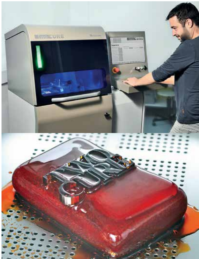
Auf der formnext präsentierte das Fraunhofer ILT den Prototypen der „TwoCure“-Anlage für den harzbasierten, stützfreien 3D-Druck von Kunststoffbauteilen.
