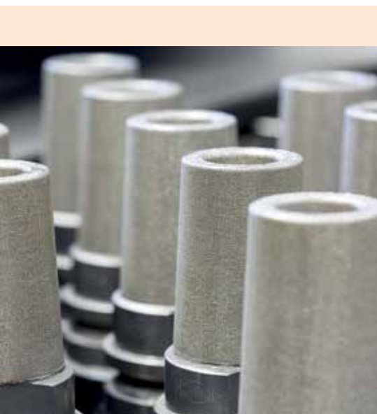
Teilweise additiv gefertigtes Hydrodehnspannfutter von Mapal: Es kommt ohne Lötstelle aus und ist dadurch deutlich temperaturbeständiger als sein konventionelles Pendant. Bild: Mapal
