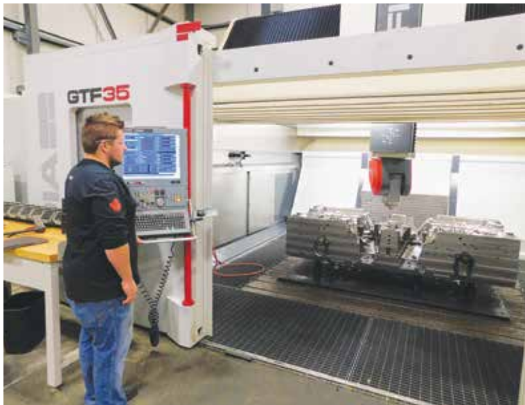
Das 5-Achsen-Fräsen gewinnt für Integrity immer mehr an Bedeutung. Aufspannungen von Bauteilen auf dem Maschinentisch und die räumliche Anstellung von Werkzeugen lassen sich mit Tebis virtuell definieren.
