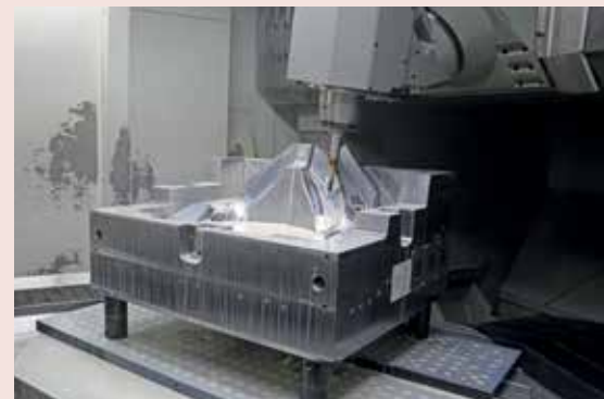
Gerade bei großen Bauteilen trägt das FCS-Nullpunktspannsystem zu störkonturfreier 5-Seiten-Bearbeitung bei.
