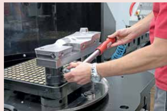
Wenige Handgriffe genügen, um das Bauteil mit dem FCS-System zu spannen.
