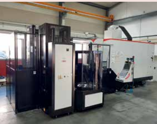
Start in die automatisierte Einzelteilfertigung: WISA ergänzte seine POSmill H 800 U um eine individuell konfigurierte Automatisierungslösung von FCS (im Vordergrund ist der Rüstplatz zu sehen).
