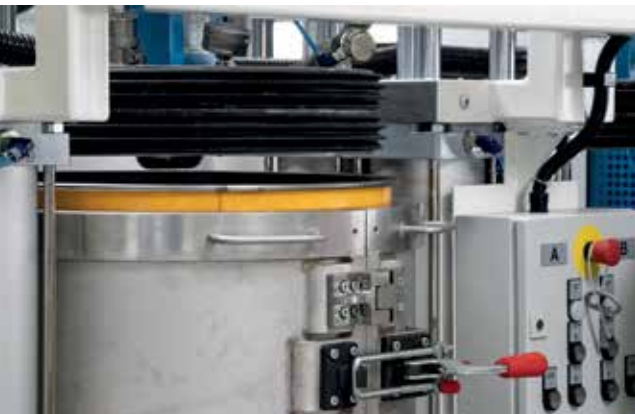
Das Vakuumspannfass von Tartler funktioniert wie eine Vakuumkammer. Beim Fasswechsel wird keinerlei Luft in das System eingebracht, und Materialverlust sowie Spritzgefahr sind ausgeschlossen.
