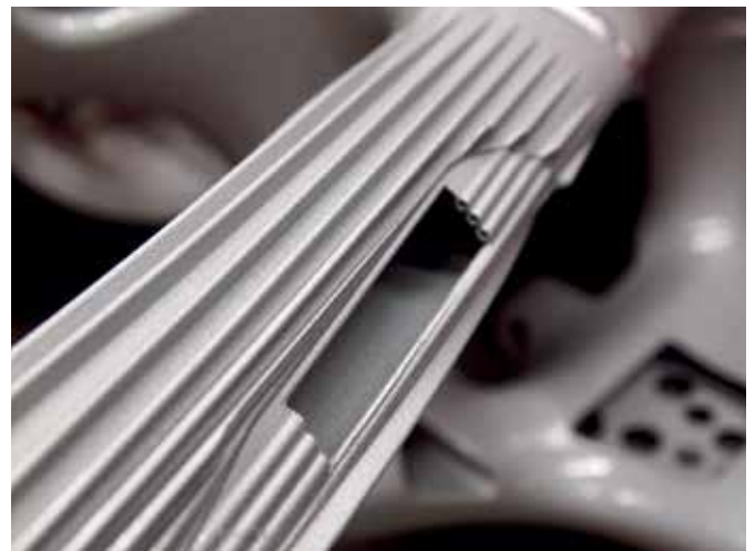
Funktionale Integration - Wärmemanagement in tragende Struktur Bilder: Altair
