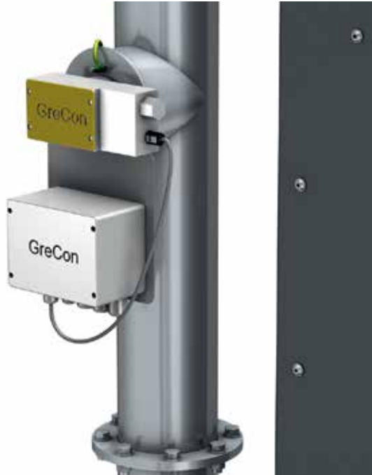
Sollte ein Zündfunke in die Absauganlage gelangen, schlägt der Funken-detektors ProSens Alarm, deaktiviert den Abreinigungsprozess und bannt damit die Explosions-Gefahr
