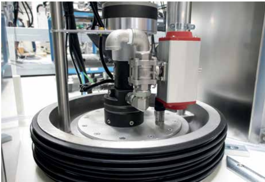
Die manuelle Fassentlüftung per Kugelhahn o.ä. ist problembehaftet. Sie führt zu Materialverlust und Spritzern und bietet keine Garantie für Luftfreiheit unter der Folgeplatte. Bilder: Tartler
