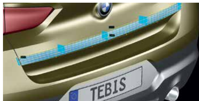
Bei der Flächenrückführung und der Flächenmodellierung bleiben in Tebis die theoretischen Kanten automatisch erhalten. In der Software stehen spezielle Funktionen zur Verfügung, um theoretische Kanten schnell zu erzeugen.
