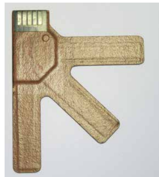
Teil des Sensornetzwerks auf der Innenseite des CFK-Grundkörpers Bilder: Fooke
