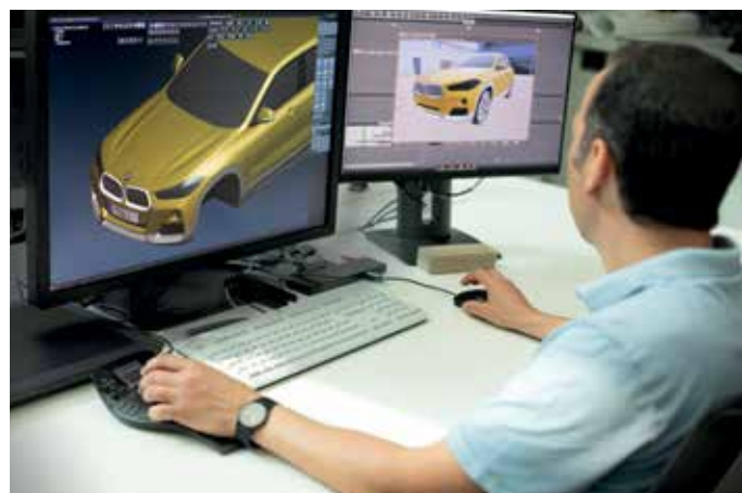
Auf der Grundlage des in Tebis erzeugten Flächenmodells (linker Bildschirm) werden im Tool für Arbeits-Visualisierungen (rechter Bildschirm) die Renderings für den BMW X2 vorbereitet.
