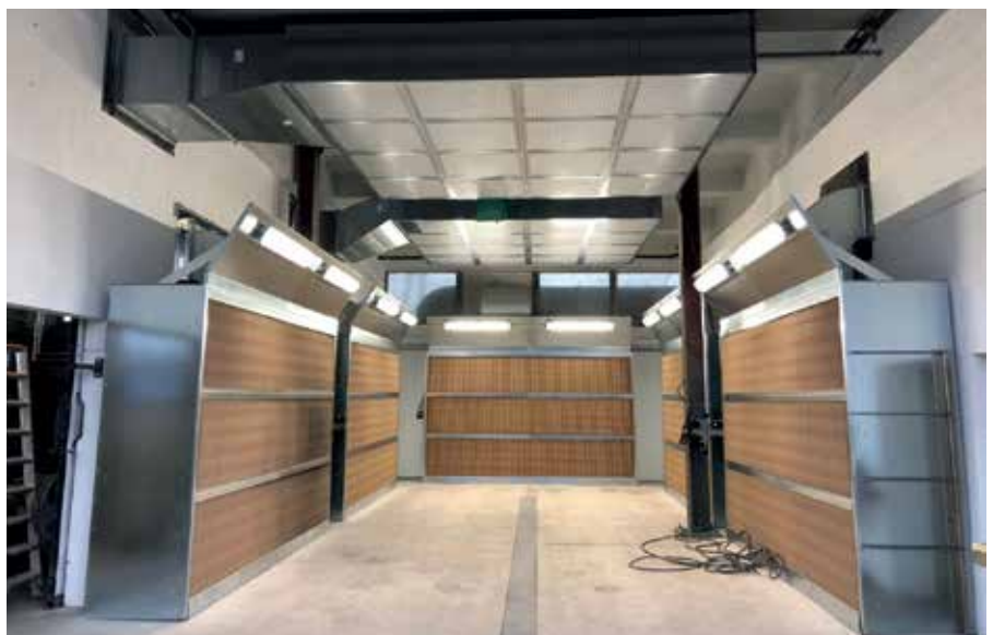
Trockenspritzwände Bilder: Spänex
