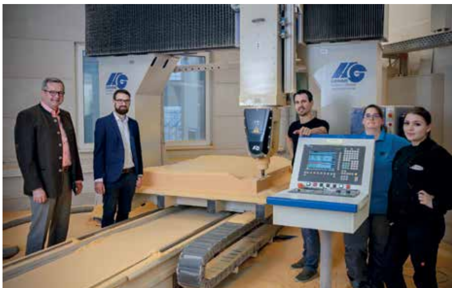
Mit der Portalfräsmaschine PSF (25-17)/M von HG GRIMME (unser Bild v.l. Außendienstmitarbeiter Joachim Schropp sowie Philipp Grimme) bearbeitet man bei Habich & Martin (v.r. Maria Roth, Leiterin C-Fertigung Samanta Miller und Produktionsleiter Tobias Prestele) unter anderem Kunststoff-Blockmaterial.
