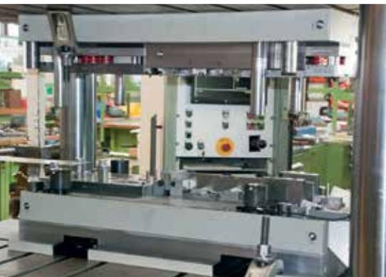
Im Werkzeugbau entstehen neben Einlegewerkzeugen hauptsächlich Folgeverbundwerkzeuge bis zu vier Meter Länge und zehn Tonnen Gewicht. Hier ein kleineres Folgewerkzeug, das auf der Probierpresse abgestimmt wird.
