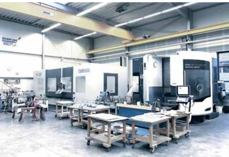
In der Fertigungshalle stehen unter anderem die 3-Achsen-Maschine MTE KT 3200 und die 5-Achsen DMU 85 monoBlock. Die Tebis Simulationstechnik ermöglicht mit ihnen eine sichere, mannlose Fertigung.
