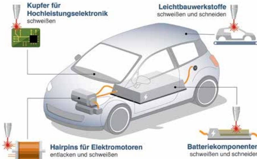
Schweißen, Schneiden und Entlacken: Der hochpräzise Laser ist sehr gefragt beim Bau von E-Fahrzeugen. Bild: Trumpf
