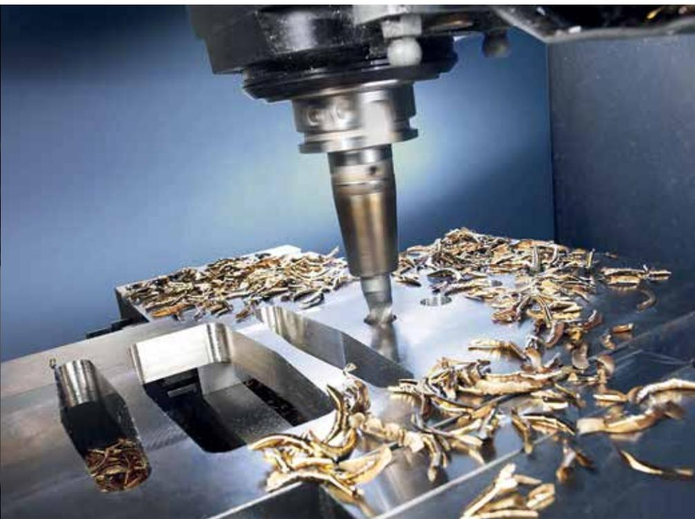
Bei der Bearbeitung mit Minimalmengenschmierung (MMS) sind die anfallenden Späne nahezu rückstandsfrei und können direkt der Wiederverwendung zugeführt werden. Bild: bielomatik Leuze
