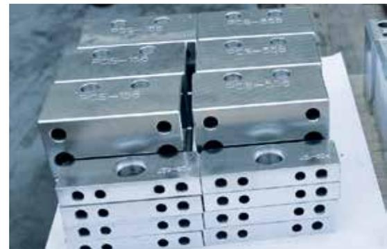
Typische Kleinteile, die sich mit Features automatisiert bearbeiten lassen.
