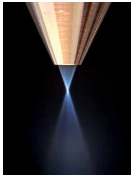
Werkzeug „Pulvergasstrahl“: Mit dem Powder Jet Monitor kann erstmals dokumentiert werden, wie Düsen den Pulvergasstrom, die Verteilung der Partikeldichte und andere Parameter beeinflussen. Bild: Fraunhofer ILT, Aachen
