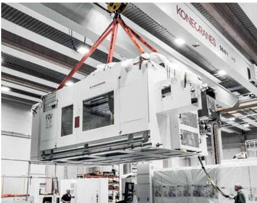
Als „Hakenmaschine“ ausgeführt, kann Zimmermann die FZU im eigenen Haus aufbauen und sie per Lkw oder Schiff zu den Kunden transportieren – ohne sie demonstrieren zu müssen. Bilder: F.Zimmermann
