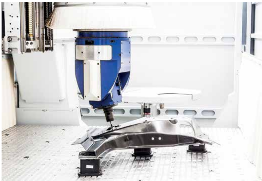
Wird der Maschine ein endkonturnah hergestelltes CFK-Bauteil zugeführt, fräst sie es zunächst hochpräzise. Fraunhofer IPA/Foto: Rainer Bez
