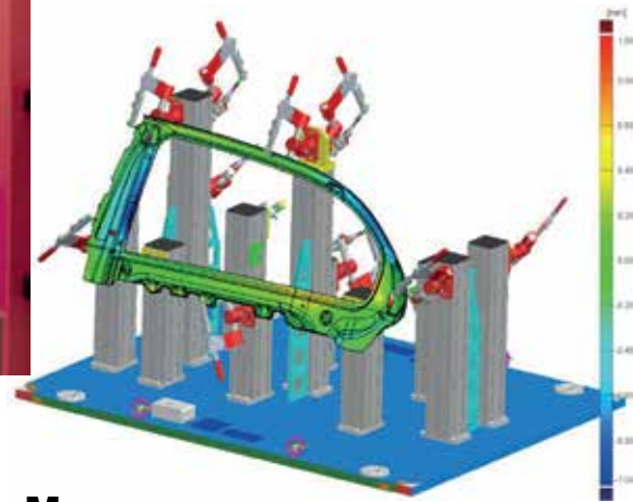
In vielen Fällen müssen Blech- oder Spritzgussteile für die dimensionale Bewertung in eine Zwangslage gebracht werden. Virtual Clamping ersetzt diese aufwendigen Spannvorrichtungen. Bilder: GOM
