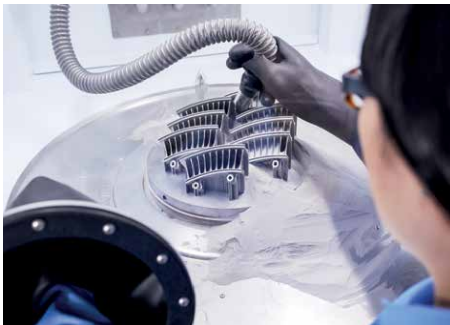
Im Auftrag von Toolcraft hat TRUMPF ein Vane, das bei Flugzeugmotoren zum Einsatz kommt, mit 3D-Druck hergestellt. Gesamtkostenersparnis: 20 Prozent. Bilder: Trumpf
