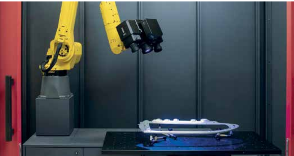
In vielen Fällen müssen Blech- oder Spritzgussteile für die dimensionale Bewertung in eine Zwangslage gebracht werden. Virtual Clamping ersetzt diese aufwendigen Spannvorrichtungen. Bilder: GOM
