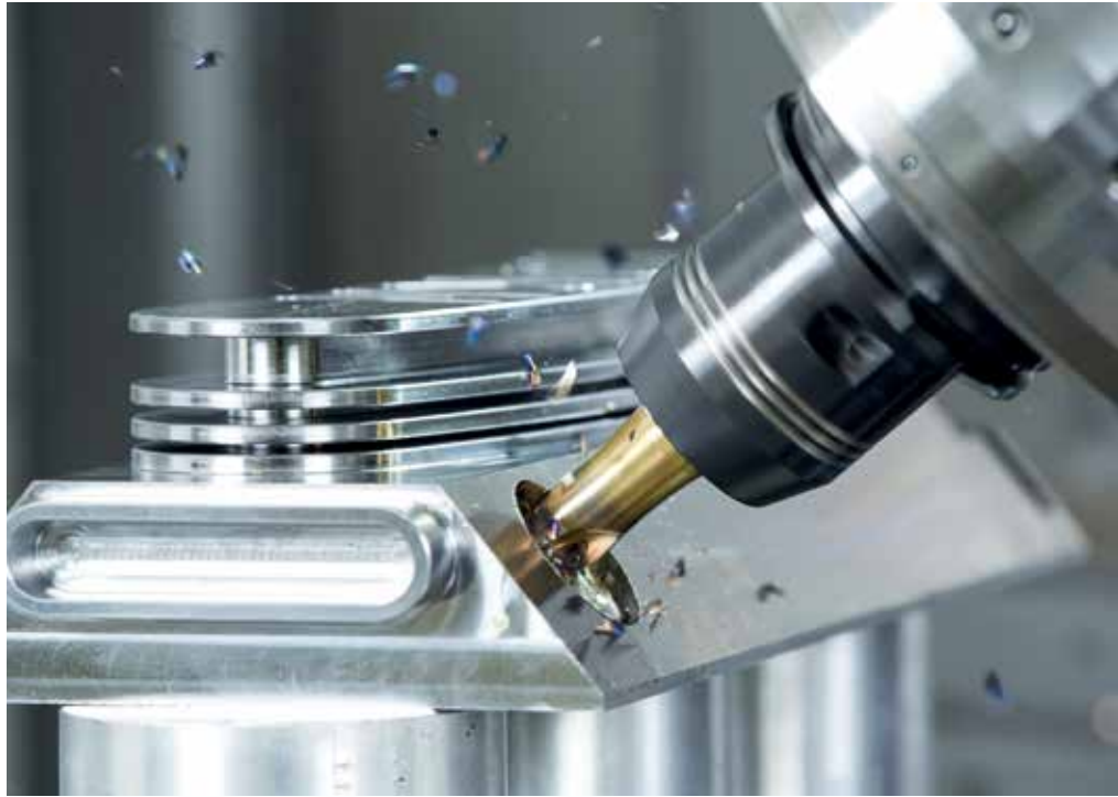
Die Minimalmengenschmierung bietet einige Vorteile: hohe Kosten für die Pflege, Aufbereitung sowie Entsorgung üblicher Kühlschmierstoffe (KSS) entfallen und Energiekosten sinken. Bild: Horn Saueremann
