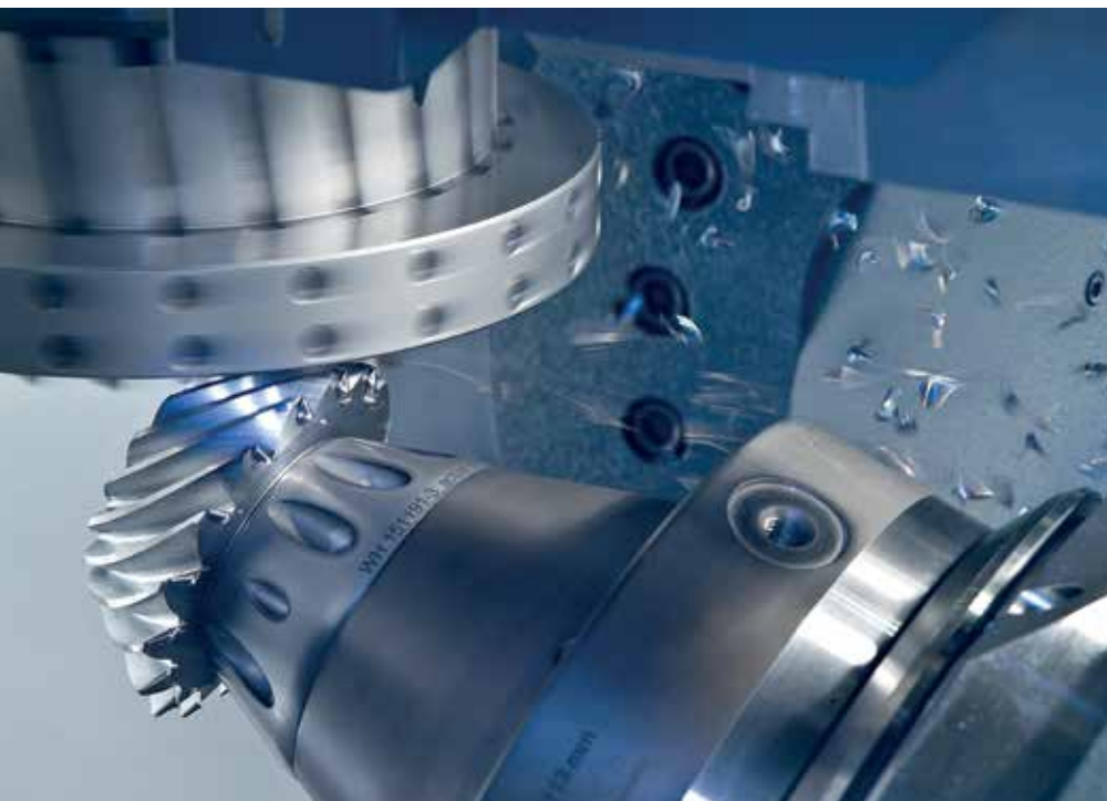
In der Zahradfertigung ist der prognostizierte Siegeszug der Trockenbearbeitung eingetreten. Die Schnittgeschwindigkeiten sind bis zu 5-mal so hoch wie in der Nassbearbeitung vor 20 Jahren. Bild: Klingelberg
