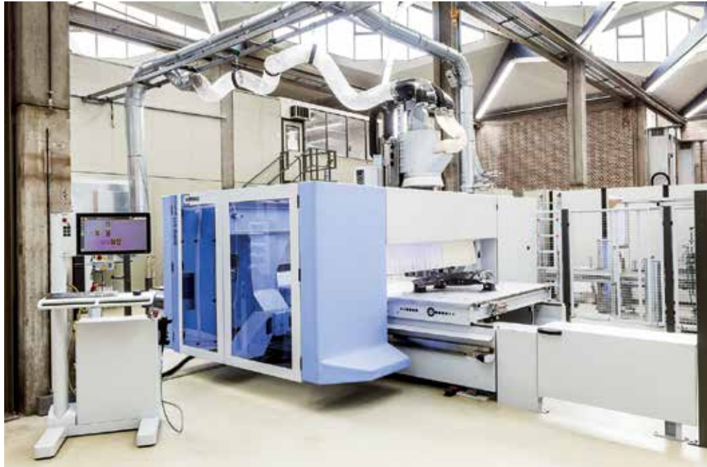
Forscher vom Fraunhofer IPA haben zusammen mit Partnern aus der Industrie eine Maschine entwickelt, die Leichtbauteile nicht nur bearbeitet, sondern auch automatisiert abmisst und versiegelt.
