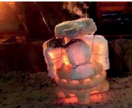
Heiße Phase: Die ausgehärtete Keramikform wird mit Aluminium ausgegossen. Bild: Voxeljet
