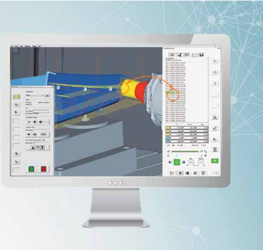
hyperMILL VIRTUAL Machining: der Optimizer analysiert komplette Bearbeitungsfolgen und berücksichtigt Achsenlimitationen.
