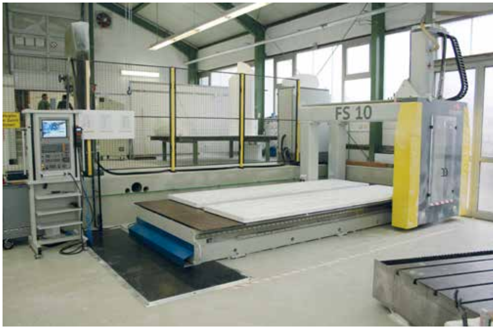
Mit der CNC-Portalfräsmaschine FS 10 von Styrotec lassen alle typischen Anwendungen im Modellbau bewältigen. Dörfelt Modellbau nutzt den großen Fräsbereich (3900 x 2400 x 1400 mm) zur Zerspaltung von Styropor und Hartschaum.
