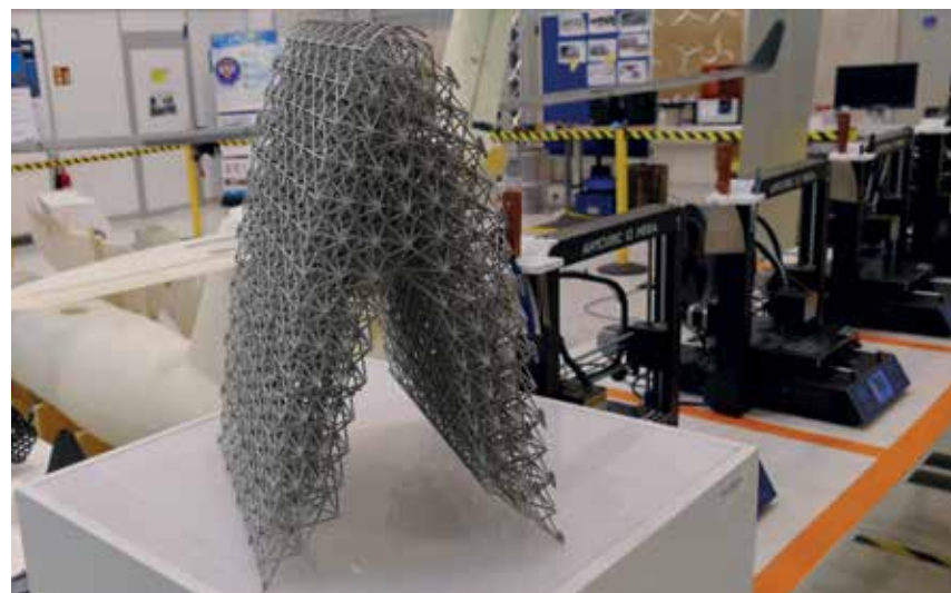
Ein Modell des mit generativem Design optimierten Seitenleitwerks eines A320.
