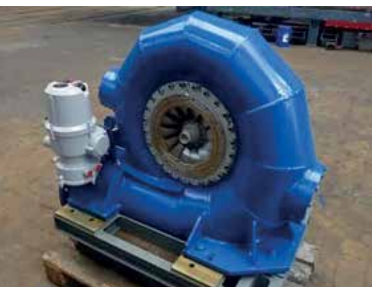
Fertiges Endergebnis: Das eingebaute Laufrad. Bild: Voxeljet
