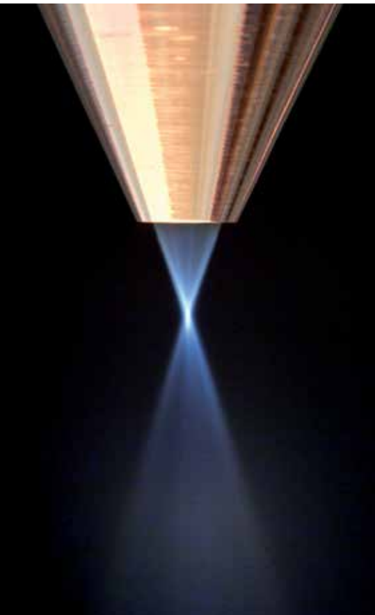
Werkzeug „Pulvergasstrahl“: Mit dem Powder Jet Monitor kann erstmals dokumentiert werden, wie Düsen den Pulvergasstrom, die Verteilung der Partikeldichte und andere Parameter beeinflussen. Bild: Fraunhofer ILT, Aachen
