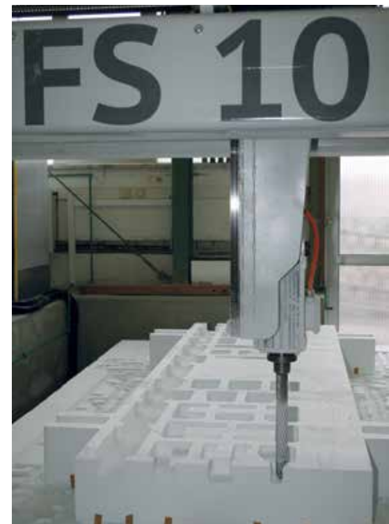
Styroporbearbeitung mit der 3-Achsen Fräse Bilder: Dörfelt
