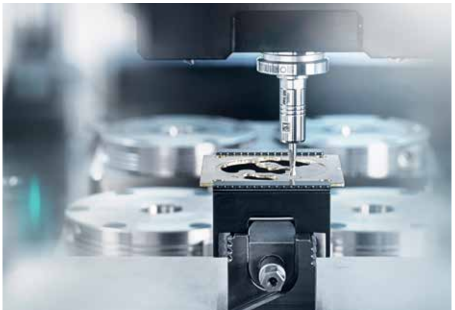
In der Mikrozerspannung gelten eigene Gesetze. Hier zahlen sich spezialisierte Spannfutter wie SCHUNK TRIBOS-Mini schnell aus.
