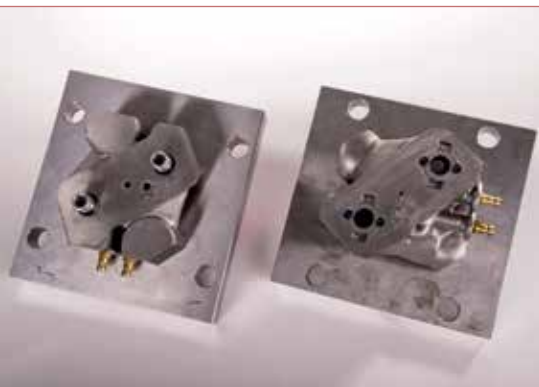
Das neue und optimierte 3D-gedruckte Werkzeug hat stark verkleinerte Bauteilabmessungen.
