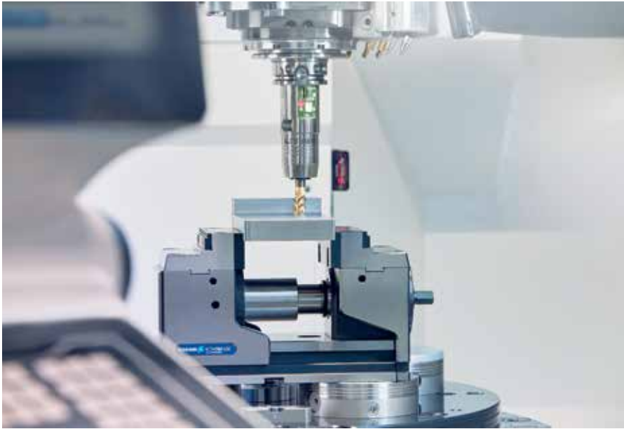
Werkzeughalter der Zukunft: Der smarte iTENDO ermöglicht eine Echtzeitprozessüberwachung und -regelung unmittelbar am Werkzeug. Bilder: Schunk
