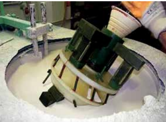
Das gedruckte Feinguss-Kunststoffmodell wird keramisch beschichtet und nach dem Härten im Ofen ausgebrannt (Ausschmelzverfahren). Der innen hohle Keramikmantel bildet die Gussform. Bild: Voxeljet
