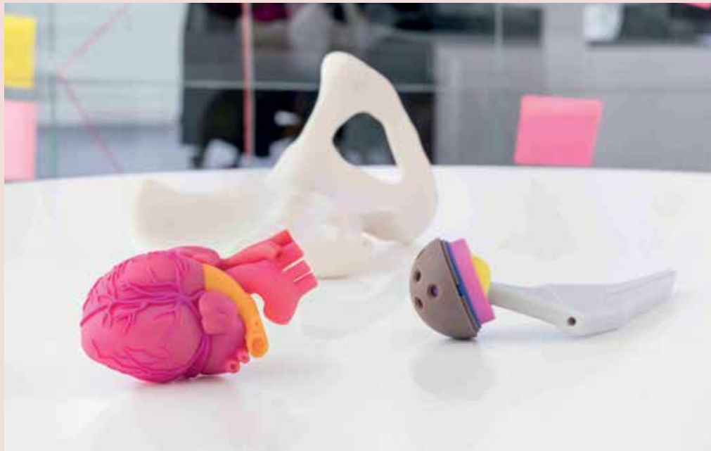
Prototypen physiologischer Modelle für den Lehrunterricht, hergestellt im 3D-Druckverfahren Polyjet. Bild: BAM GmbH
