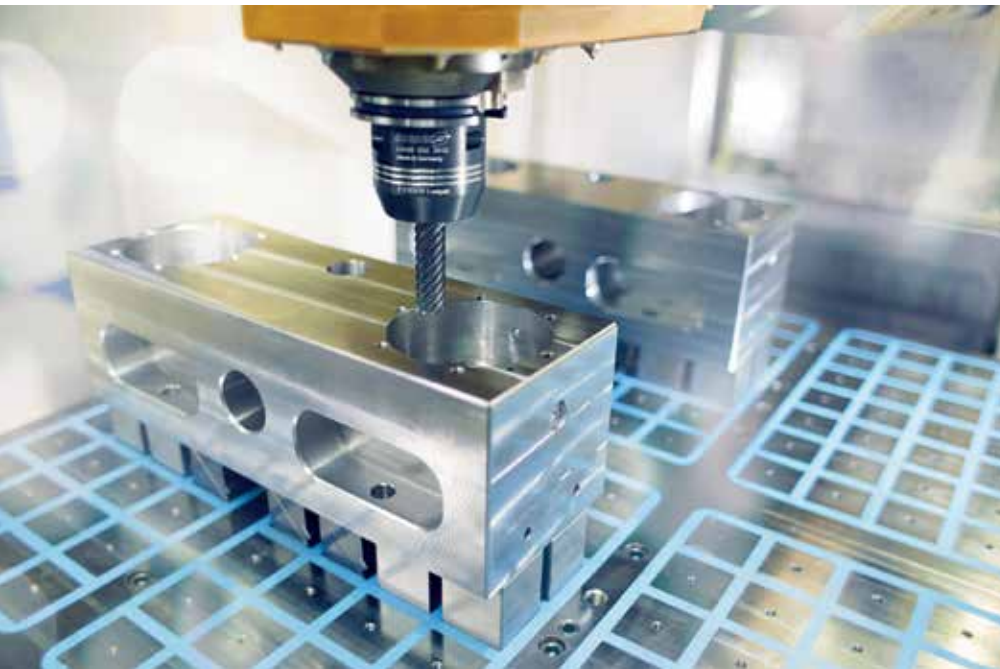
Hochleistungs-Hydro-Dehnspannfutter, wie SCHUNK TENDO E compact, verfügen über hohe Spannkraften und können je nach Spanndurchmesser Drehmomente bis 900 Nm sicher übertragen.
