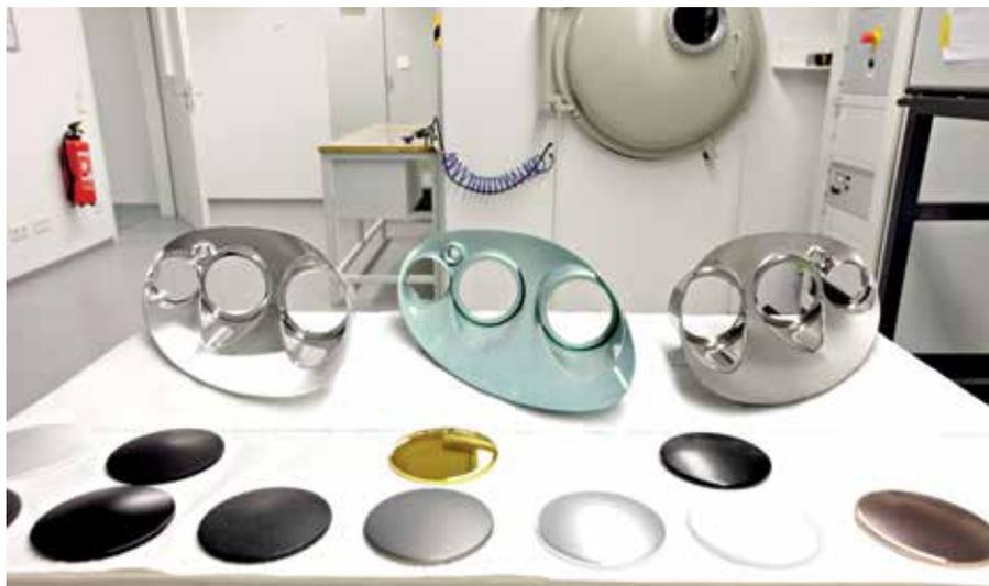
Bedampfung von Bauteilen Bild: Klaus Schraeder
