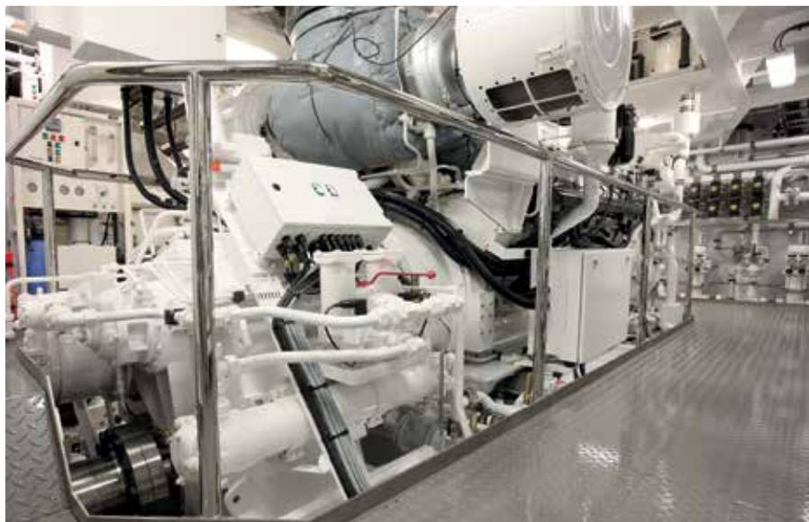
Die tonnenschweren, stählernen Gehäuseteile von Schiffsgtrieben werden bisher gegossen. In Zukunft sollen sie mit einem riesigen 3D-Drucker hergestellt werden. Bild: Reintjes GmbH
