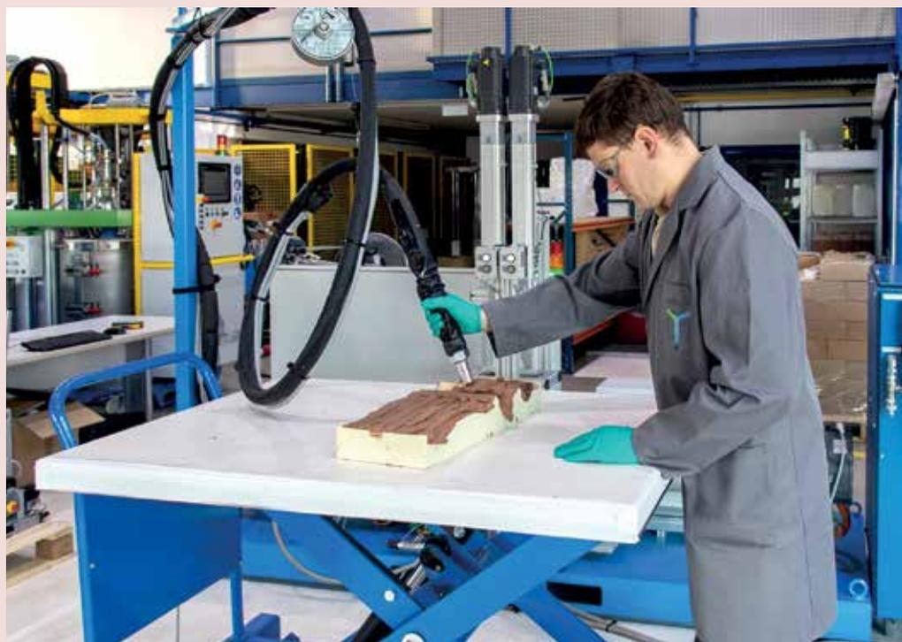
Der Clay-Austrag erfolgt gleichmäßig, mit konstanter Materialtemperatur und einem Ausstoß von bis zu 1,2 kg/min. Die nächstgrößere CAMA 02, deren Entwicklung kurz dem Abschluss steht, wird für einen Ausstoß von über 3,0 kg/min ausgelegt sein.
