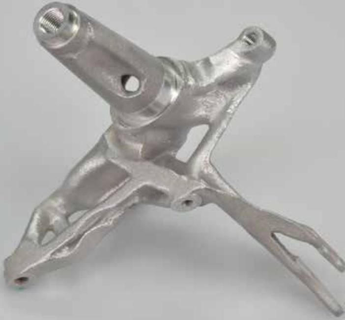
Strukturoptimierter Radträger eines Ultraleichtfahrzeugs: Design für Additive Manufacturing – Herstellung im 3D-Drucklabor Metall und Strukturwerkstoffe am Fraunhofer EMI.
