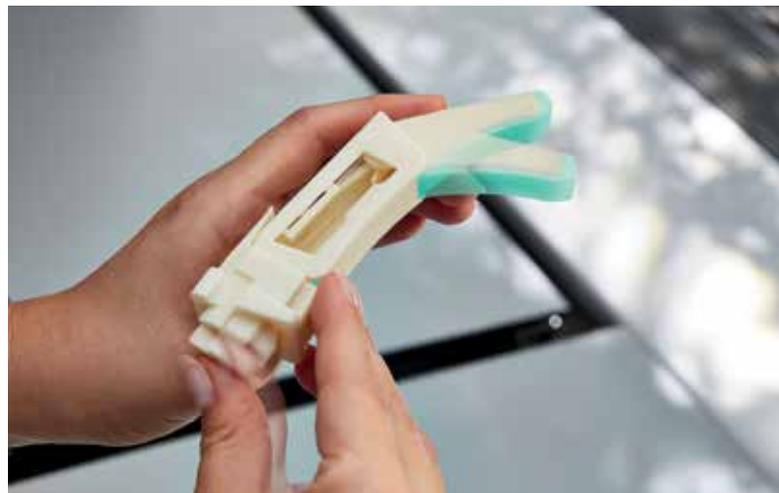
Mit dem Freeformer 300-3X lassen sich z.B. bewegliche Greiferfinger aus ABS und TPU mit Hilfe von Stützmaterial fertigen. Bilder: Arburg
