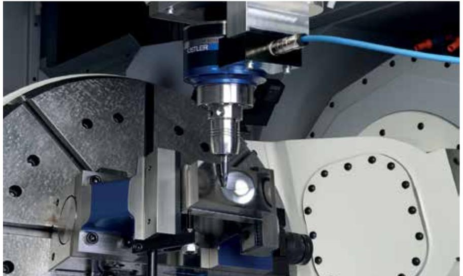
Die Partner entwickelten für die Bearbeitung mit Tonnenfräswerkzeugen nicht nur neue Werkzeuggeometrien, sondern auch passende, flexible Bearbeitungsstrategien und entsprechende CAM-Softwaretools. Foto: Fraunhofer IPT
