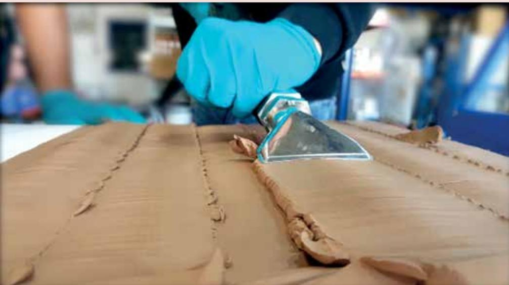
Im Vergleich mit bisher üblichen Methoden des Clay-Modeling sparen Modellbauer und Industriedesigner mit der neuen Clay-Applikationsmaschine enorm viel Zeit – insbesondere durch die Möglichkeit, auch Breitstrahldüsen einzusetzen.
