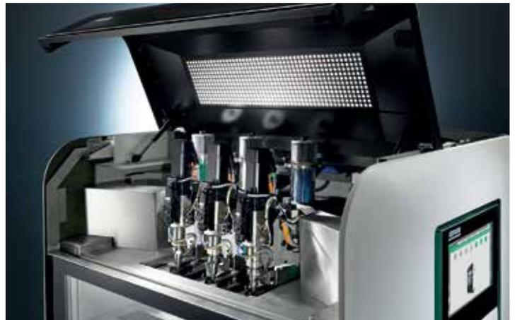
Der Freeformer 300-3X erweitert das Anwendungsspektrum des Arburg Kunststoff-Freiformens (AKF). Mit den drei Austragseinheiten lassen sich komplexe Funktionsbauteile in belastbarer Hart-Weich-Verbindung additiv fertigen.
