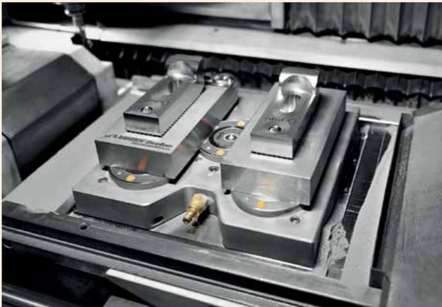
Beim 3D-Druck sind besondere Anforderungen bei der Spanntechnik zu berücksichtigen, unter anderem hohe Temperaturen – von AMF speziell auf die additive Fertigung abgestimmte Nullpunktspanmodule erfüllen die Bedingungen und beschleunigen zudem die Rüstprozesse. Bild: AMF
