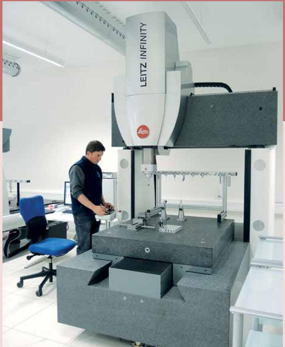
*Leitz Infinity im Messlabor von Gribo Messtechnik. Das Messlabor erfüllt als Klasse 1 Labor den internationalen Standards der VDI/VDE 2627. Mit der ultrahochgenauen Leitz Infinity misst der Schweizer Messdienstleister nun in einer Liga mit nationalen Metrologie-Instituten.*
