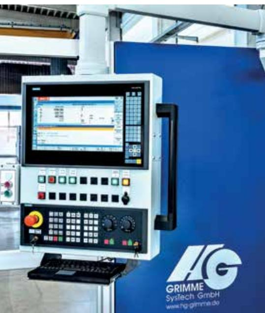
Über ein schwenkbare, hochauflösendes Grafikdisplay kann die G-S-F/MK per Siemens-Sinumerik-840D/SL leicht bedient werden. Bilder: HG Grimme
