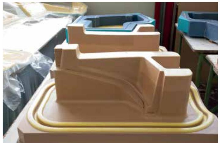
Mastermodell aus Ureol für ein Automotive-Interieur-Teil (Kombiblende), das als Basis für die zu spritzende Vakuumhaube dient. Bilder: Mecadat
