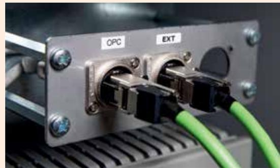
Das Horn-Netzwerk nutzt beispielsweise im Bereich Beschichtung den OPC-UA-Kommunikationsstandard als wichtigen weltweiten Standard für die Industrie 4.0. Bild: Horn
