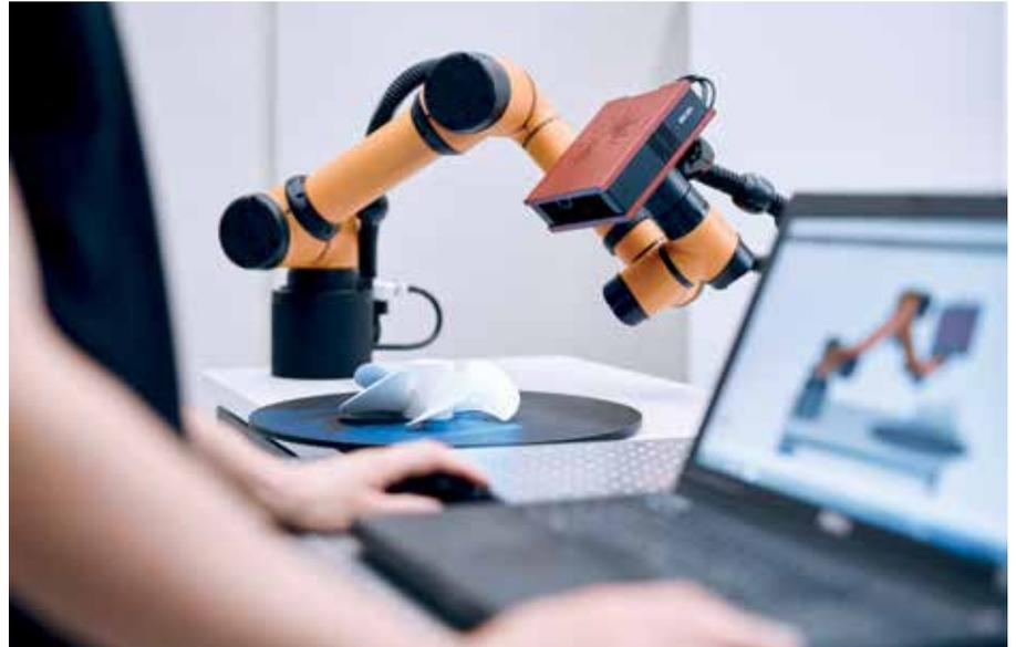
Ausgestattet ist GOM ScanCobot mit der aktuellen GOM Inspektionssoftware inklusive einem virtuellem Messraum, hier beim Digitalisieren eines Impellers aus Plastik. Bild: GOM
