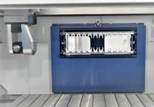
Die Modellbau-Fräsmaschine ist ausgestattet mit einem kompakten 5-Achs-Gabelkopf, der die 3D-Bearbeitung besonders präzise macht.
