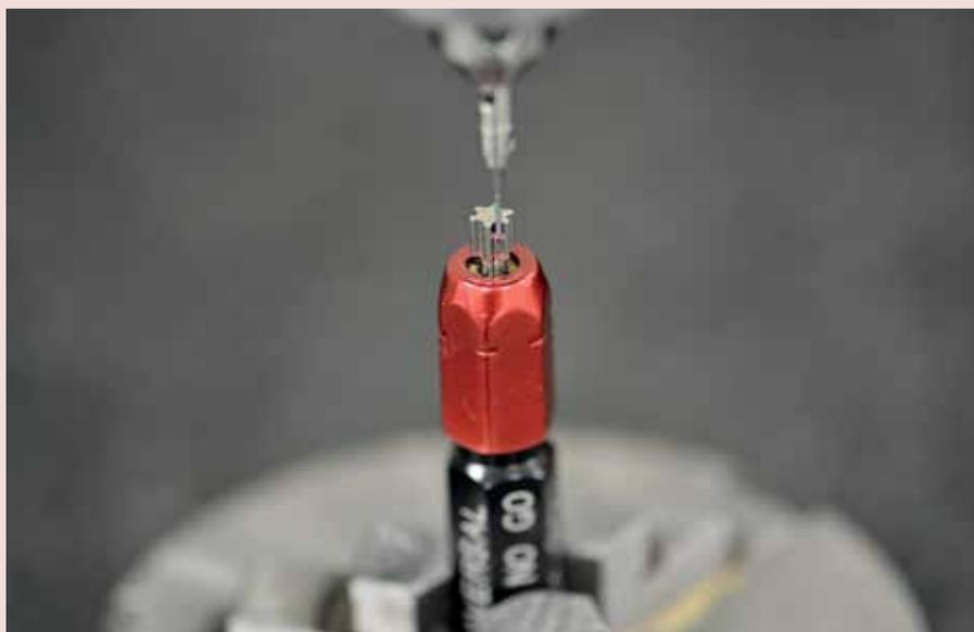
Eine Auftragsmessung für einen Kunden: ein Sonderlehndorn wird mit einer 0,8 mm Tastkugel gemessen.
