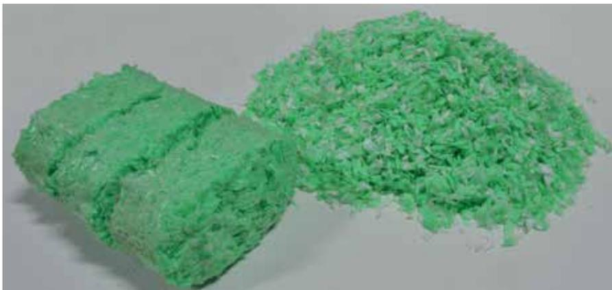
Späne und Briketts aus Polyethylen-HD
