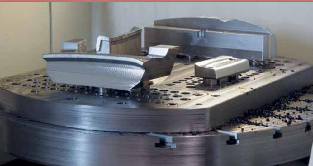
Bild 3: Eigenlösung eines Spannsystems
