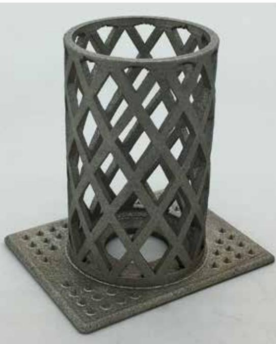
Laminierhülse mit neuartiger Pinstruktur für die formschlüssige Verbindung mit den vorimprägnierten CFK-Fasern. Bild: Fraunhofer IGCV
