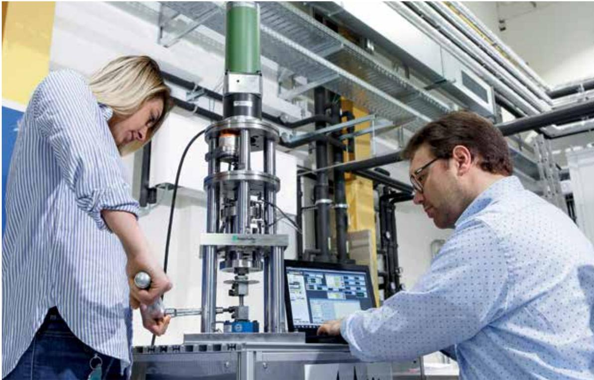
Wissenschaftler des Fraunhofer LBF bei Versuchen zur Charakterisierung des bauteilgebundenen Werkstoffverhaltens additiv gefertigter Strukturen.
