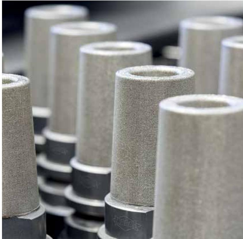
Durch den Einsatz additiver Verfahren hat Mapal die Temperaturbeständigkeit und Geometrie des Hydrodehnspannfutters deutlich optimiert. Bild: Mapal
