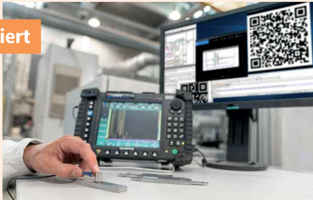
Auslesen des QR-Codes mittels Ultraschall: Das erzeugte Bild wird anschließend über eine spezielle Software ausgelesen, die Kennung extrahiert und mit der Datenbank abgeglichen. Bild: Fraunhofer IFAM
