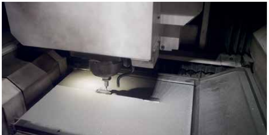
Der Fräskopf: Dessen Hochleistungsspindel beschleunigt den Fräser auf bis 45.000 U/min.
