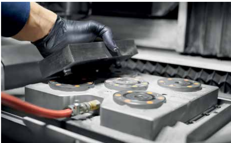
Mit dem AMF Zero-Point System kann die Rüstzeit auf ein Zehntel der Zeit reduziert werden. Bilder: AMF
