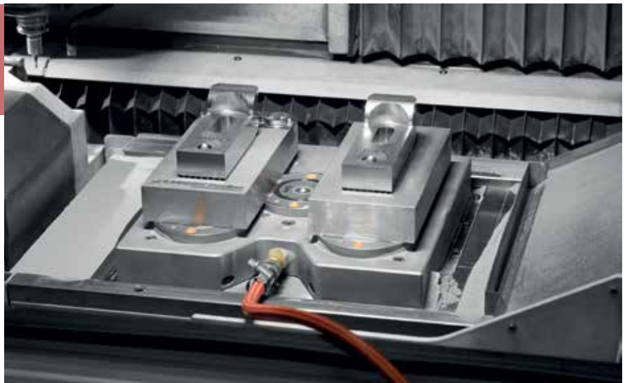
Das Zero-Point System von AMF bietet bei MATSUURA für viele Anwendungen eine optimale Ergänzung die zur Wirtschaftlichkeit des kompletten Prozesses beiträgt.
