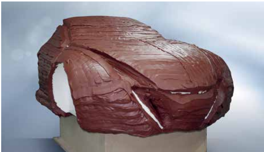
Mit RAKU TOOL Close Contour Pasten von RAMPF Tooling Solutions können großflächige Sektoren wie bei diesem 1:1 Automobilmodell in einer einzigen Applikation bearbeitet werden. Bilder: Rampf
