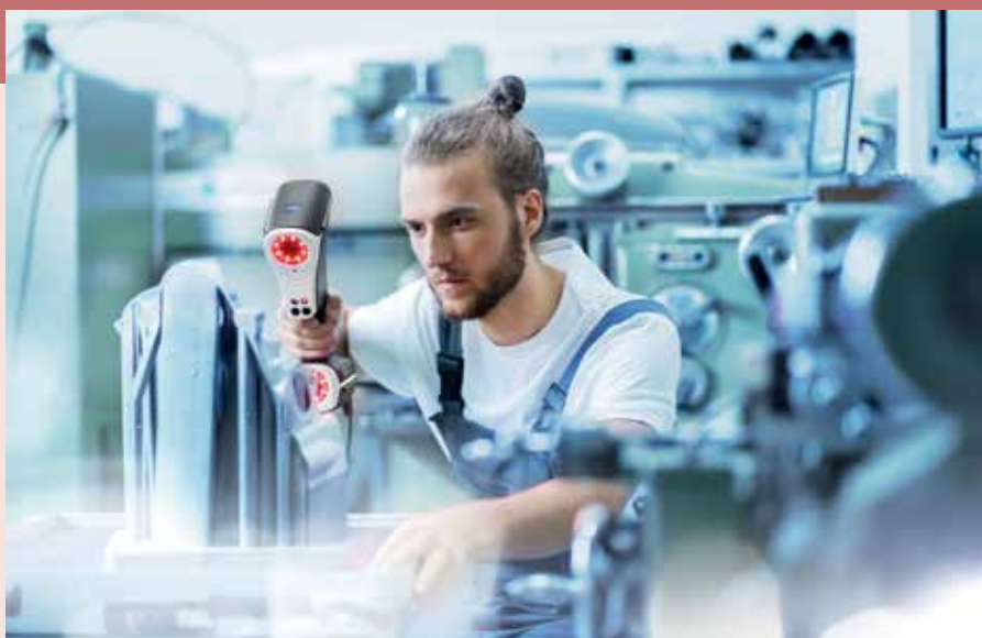
Das neue flexible und präzise handgeführte Laserscansystem ZEISS T-SCAN hawk erfasst Messdaten in Produktionsumgebungen, Labors und an der Werkbank.
