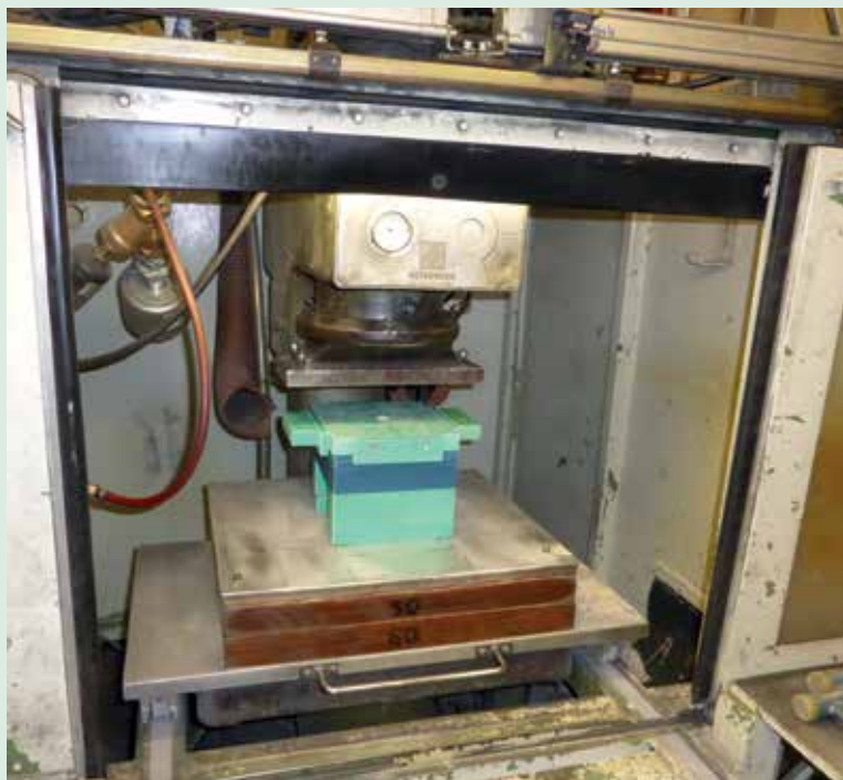
Abb. 2: Kernkasten mit Wechselrahmen
