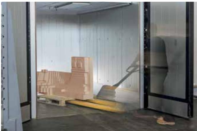
Getemperter angenäherter PU-Rohblock
