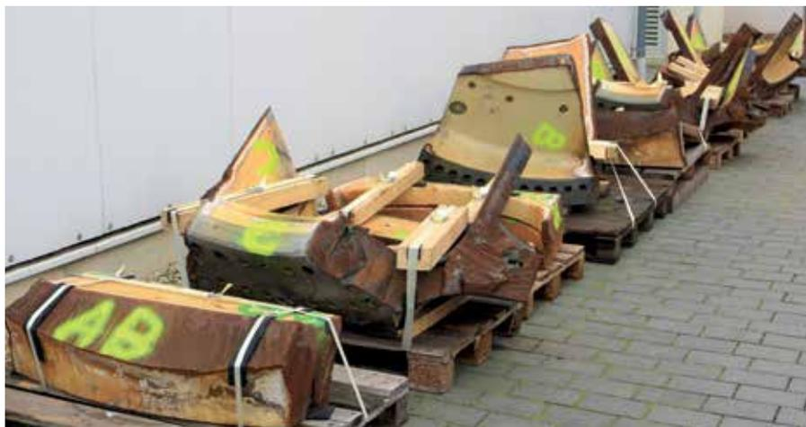
Gussbauteile sollen leicht, nachhaltig und zuverlässig sein. Detaillierte zerstörende Bauteilanalyse liefert Erkenntnisse über lokale Bauteilfestigkeitseigenschaften. Bild: Fraunhofer LBF
