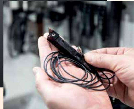
*Im Einsatz bei Langdrehmaschinen erlaubt der Sensor die Messung von Zerspankräften ab wenigen Newton. Bild: Horn*
