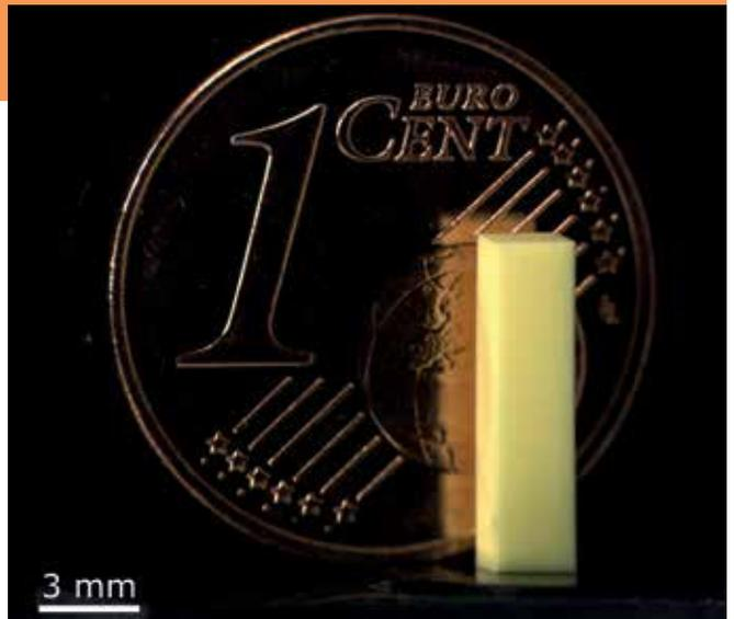
Das Metamaterial, das mit dem neuen System gedruckt wurde, besteht aus einer komplexen dreidimensionalen Gitterstruktur im Mikrometermaßstab. Bild: Vincent Hahn, KIT
