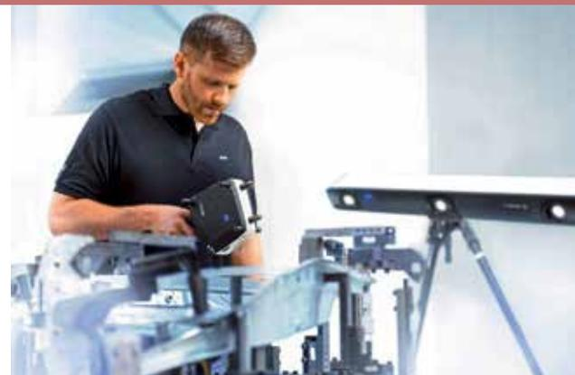
Mithilfe des Messsystems T-Scan von Zeiss können sich 3D-Daten einfach und intuitiv erfassen lassen. Bild: Zeiss
