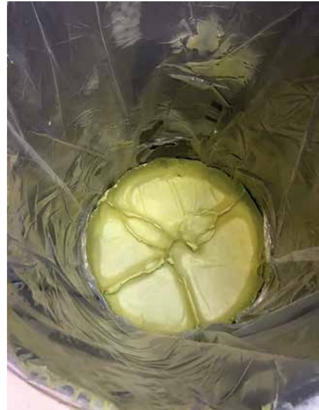
Selbst bei betriebsgerecht geleerten Fässern bleiben bis zu 14 kg Kunstharzreste in deren Foliensack (Inliner) zurück. Mit der TAVA 200 F lassen sie sich aufbereiten und in den Verarbeitungsprozess der Rotorblatt-Produktion zurückführen.
