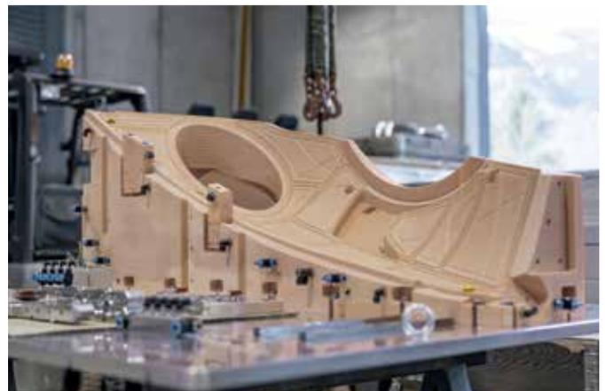
PU Spannvorrichtung für die Automobilindustrie hergestellt aus SikaBiresin® Blockgießharz
