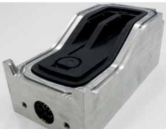
Werkzeughälfte mit eingelegtem Bauteil
