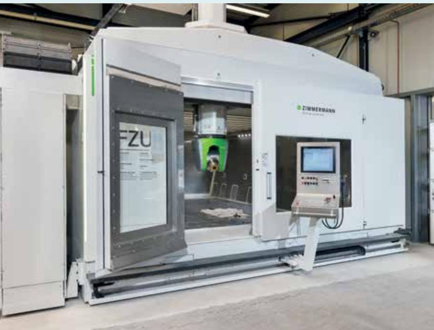
Eine FZU-Fräse der Firma Zimmermann mit einem Bauraum von 4000 x 3000 x 1250 mm steht für die Zerspaltung von Aluminium zur Verfügung.
