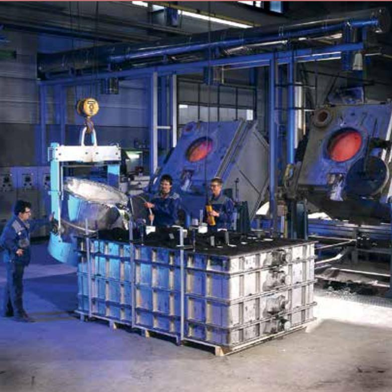
Gießen statt Zerspanen: Blöcher stellt große Blasform-, Tiefzieh- und Schäumwerkzeuge aus Aluminium mit Abmessungen von 2.000 x 3.000 Metern und Stückgewichten von bis zu 2,5 Tonnen her.
