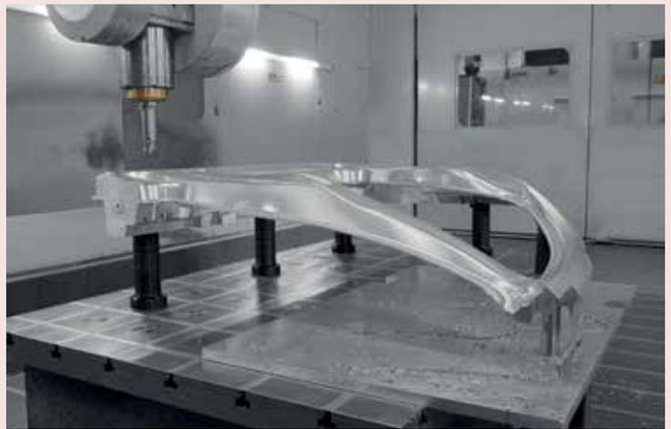
Mit der intelligenten Nullpunktspanntechnik von AMF lassen sich auch Punkte außerhalb der Aufspannplatte erreichen. So kann das Dachelement sicher für eine Fünfseitenbearbeitung gespannt werden.
