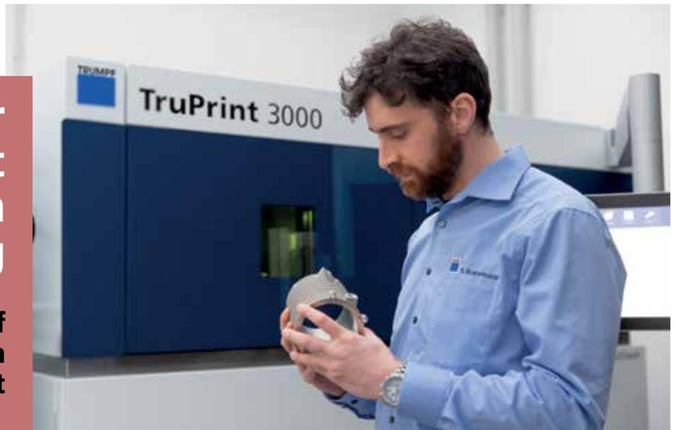
Die neue Mittelformat-Maschine stellt durch pulverbett-basiertes Laserschmelzen Bauteile von bis zu 300 Millimetern Durchmesser und 400 Millimetern Höhe her.
