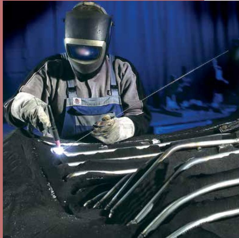
Hochpräzise Integration komplexer Edelstahl-Temperierungen in die Sandgussformen: Konturnah eingegossen statt ins Volle gebohrt oder gefräst.
