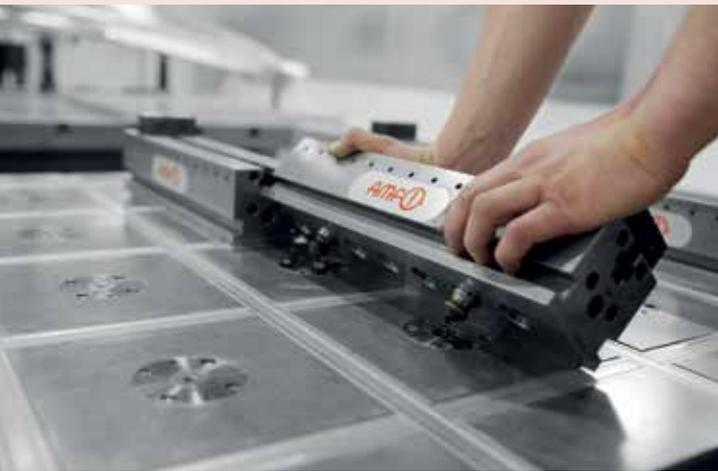
Das Nullpunktspannsystem von AMF ist so einfach und logisch wie Lego. Alles passt zueinander und lässt sich schnell und passgenau platzieren.
