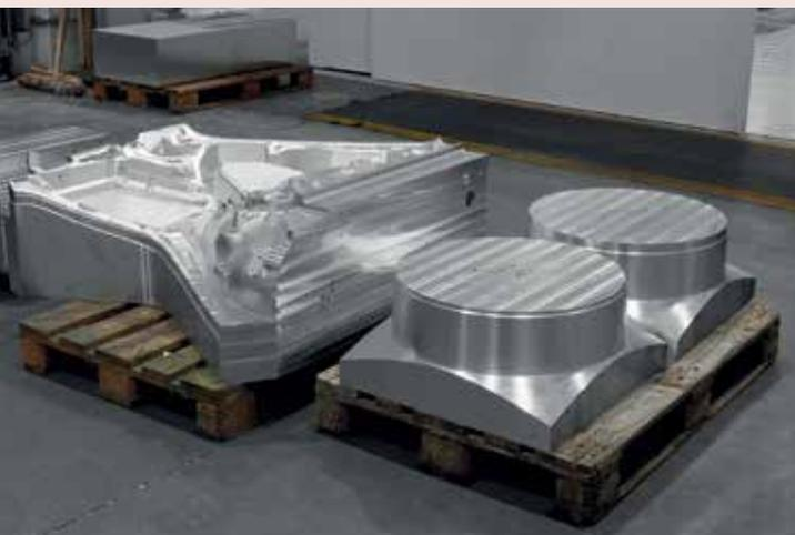
*Karosserie-Seitenteil und Alufelgen werden aus dem Vollen zerspannt.
