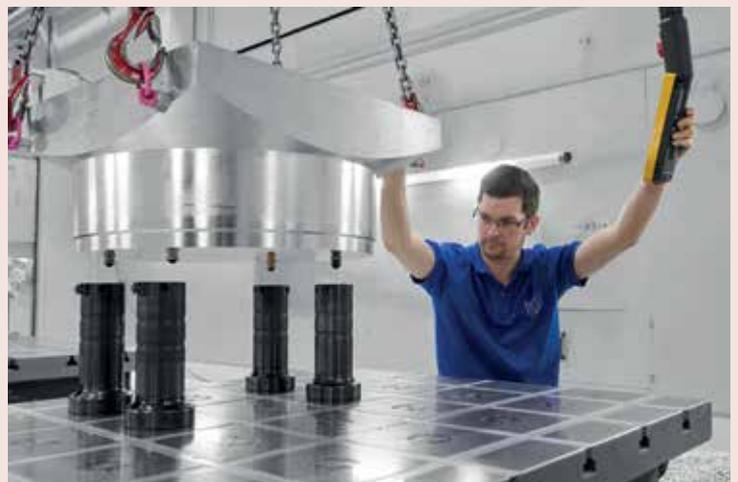
*Rüstzeiten mit AMF Nullpunktspanntechnik minimieren: Mit wenigen Handgriffen ist das Werkstück bei MT-Technologies für die Fünfseitenbearbeitung gespannt.*
