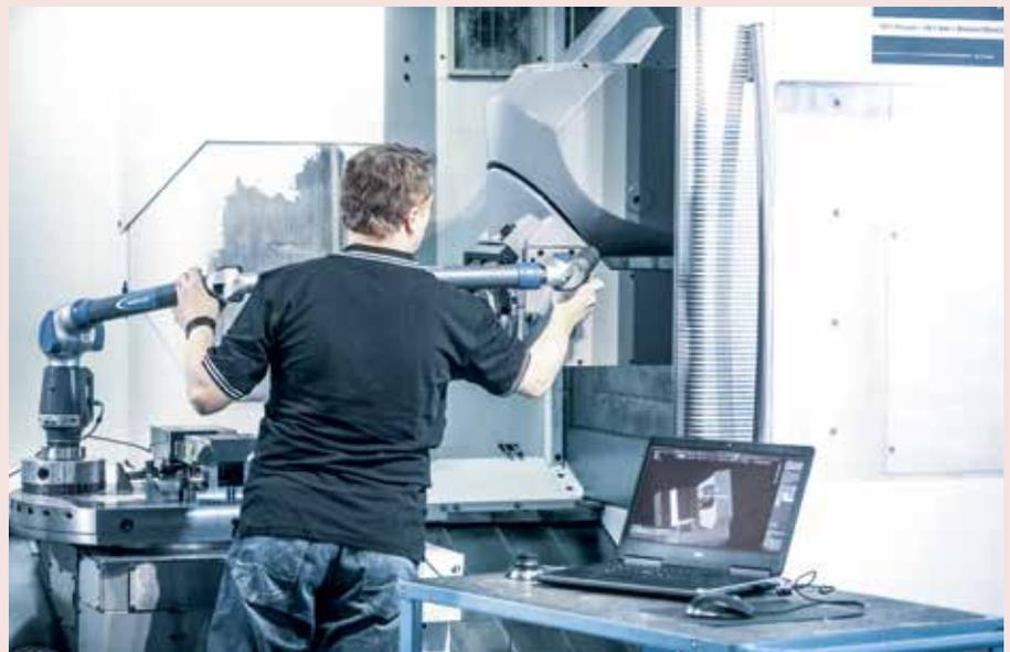
*Digitalisierung der Fertigungsumgebung: Detailgetreue virtuelle Abbildungen etwa von Maschinen, Werkzeugen, Spannmitteln und Aggregaten werden in das CAD/CAM-System Tebis mit ihren jeweiligen geometrischen und technologischen Eigenschaften integriert. Das bietet mehr Sicherheit, Standardisierung und Automation beim Programmieren und Fertigen.*
