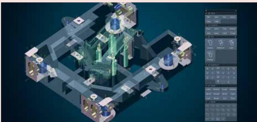
Automatisierte Bauteilaufbereitung: In Features und Schablonen ist das individuelle Fertigungswissen eines Unternehmens in der Tebis Software hinterlegt. Das vereinfacht etwa die Aufbereitung eines Bauteils zur automatisierten NC-Programmierung von Planflächen, Taschen, (Stufen-)Bohrungen und Gewinden.
