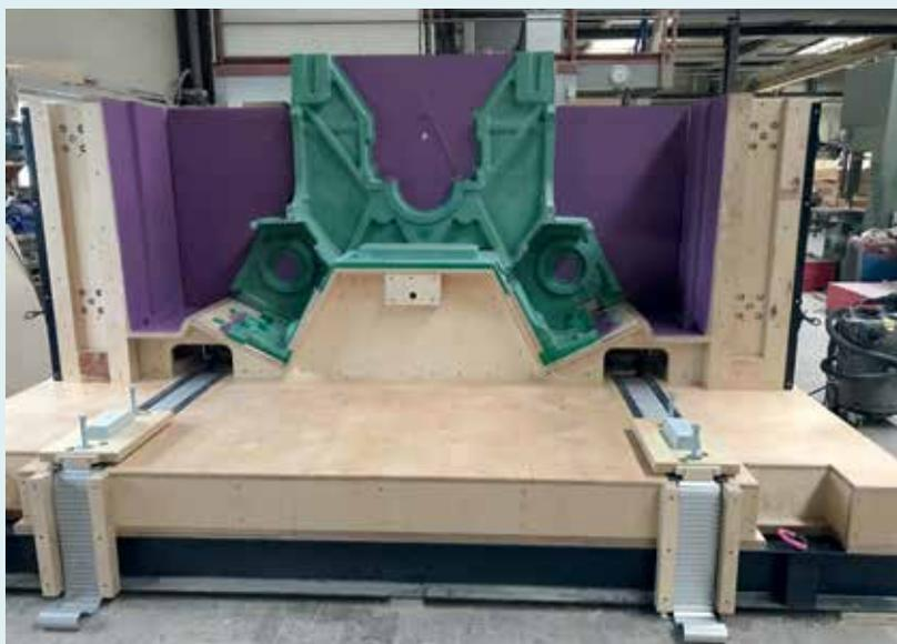
Aus der Produktion der Duisburger Modellfabrik: Kurbelraumkernkasten aus Holz und Kunststoff mit Wänden auf einem Linearführungssystem mit pneumatischer Ausdrückhilfe.
