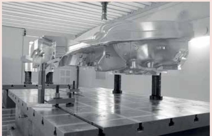
Die Werkstücke werden auf den Paletten direkt gespannt. Die Nullpunktspanmodule in den Aufspannpaletten nehmen die Spannbolzen von Aufbau- und Zwischenelementen auf. Die gibt es von 20 bis 100 Millimeter. Oben ist erneut ein Nullpunktspanmodul K10.2 positioniert, das die im Werkstück verschraubten M8- oder M10-Spannbolzen mit 10 kN einzieht und verschließt und mit 25 kN Kraft hält.
