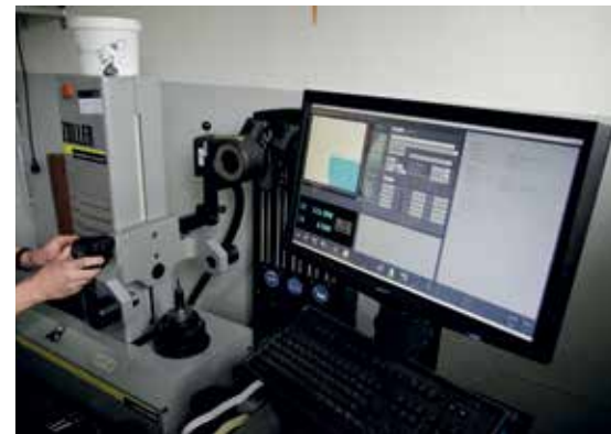
Mit dem Werkzeugvoreinstellgerät können die Werkzeugdaten direkt an die jeweilige Maschine geschickt werden. Bilder: Brüggemann
