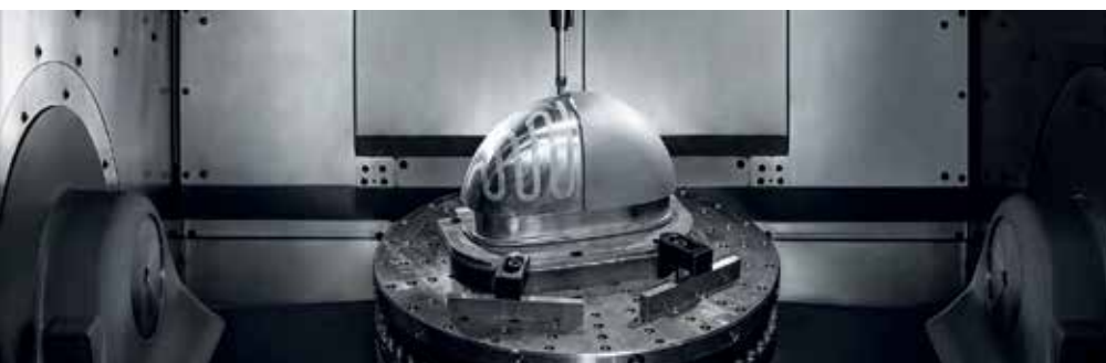
Nachdem die Kühlkanäle mit einem wasserlöslichen Metallpulver gefüllt sind, erfolgt der nächste Metallpulver-Auftrag.
