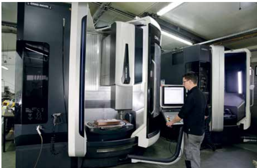
Dem Modellbau-Betrieb stehen sechs 3-Achs- und drei 5-Achs-Simultan-CNC-Fertigungszentren zum Fräsen und Drehen zur Verfügung.
