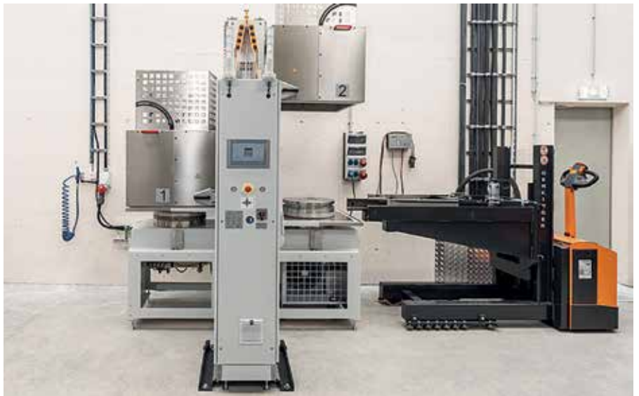
Um die Maschinennutzung zu optimieren, werden die Halbzeuge vor Fertigungsbeginn in einer Heizstation auf Prozess Temperatur gebracht.
