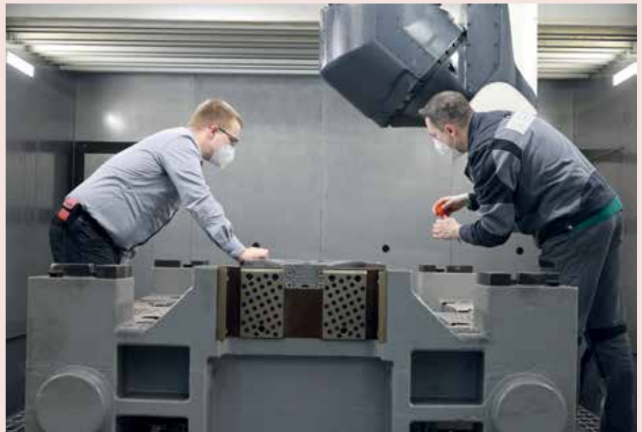
Zerspan wird bei Riemann in erster Linie auf DMG-Maschinen. Hier sind die Dimensionen in den vergangenen Jahren stark gewachsen. Aufgrund der immer komplexeren Geometrien geht der Trend klar zu steifen und präzisen, dabei aber sehr dynamischen 5-Achs-Maschinen.
