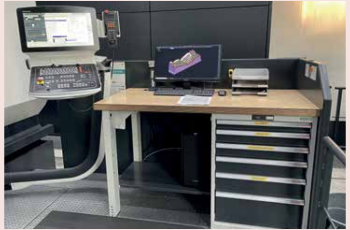
Bei Riemann dienen Zeichnungen nur noch einem ersten Überblick. Den verbindlichen Stand der Daten und auch Bemaßung, Toleranzen und andere Parameter kann der Maschinenbediener an seinem Tebis-Viewer einsehen. So ist sichergestellt, dass stets alle den aktuellen Informationsstand haben.
