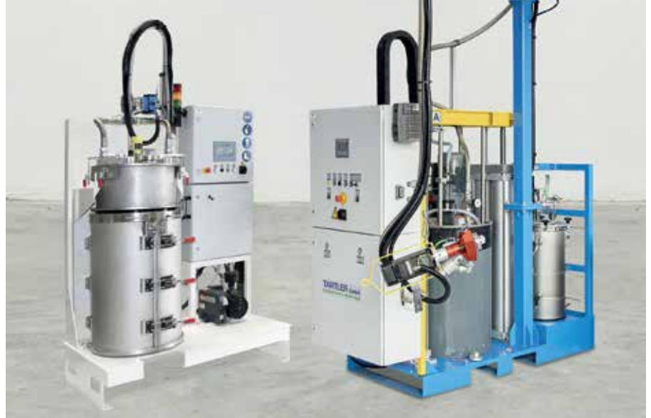
Silikon-, Klebstoff- und Gelcoat-Verarbeiter, die eine TARDOSIL (r.) mit TAVA F (l.) einsetzen, können flüssige und pastöse Materialreste von feuchter Störluft befreien und wieder in den Verarbeitungsprozess zurückführen.
