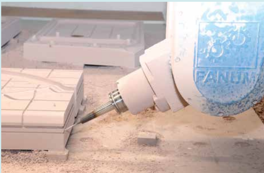
Mit dem 5-Achs-CAD-BAZ können auch hochkomplexe Werkstücke gefräst werden. Bild: Dieckmann
