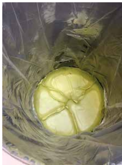
Selbst bei sachgerecht geleerten Fässern bleiben bis zu 14 kg Kunstharzreste in deren Foliensack (Inliner) zurück. Mit der TAVA F lassen sie sich aufbereiten und in den Verarbeitungsprozess zurückführen. Bild: Tartler
