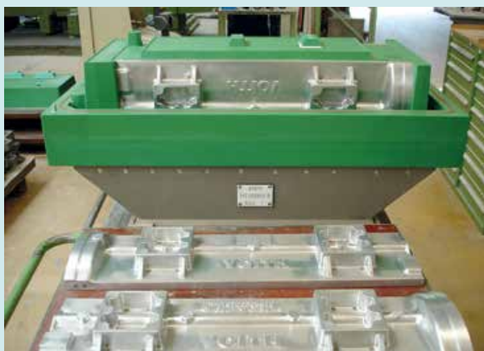
Losteile für den Kernkasten eines Gehäuses mit Aluminium. Bild: Vollack
