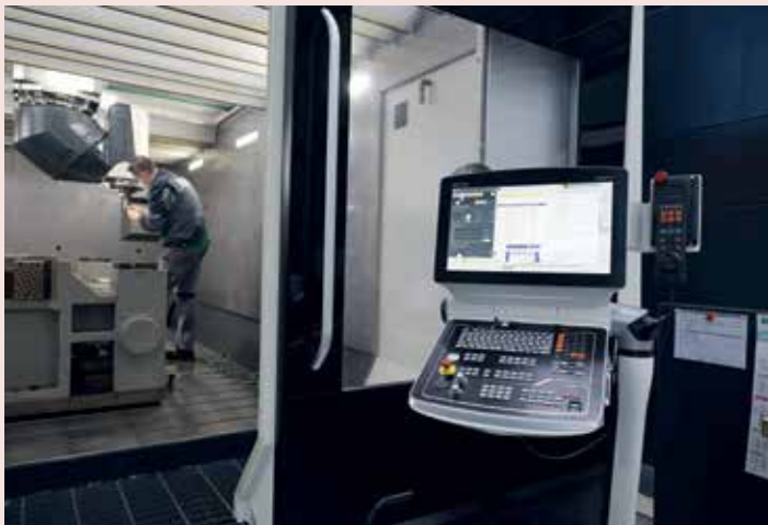
Die Daten kommen fertig aus dem CAD/CAM auf die Maschine. Die Bediener programmieren an der Maschine bei Bedarf lediglich noch 2,5D-Bearbeitungen oder leiten etwa die der DXF-Kurven ab.
