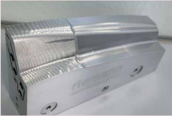
Demo-Backe fürs Warmumformen. Neben Freiformflächen prägt das komplexe Innenleben diese Werkstücke. Dank der durchgängigen Softwarelandschaft von Tebis schaffen die Werkzeugmacher bei Riemann jetzt deutlich mehr Spindelstunden als mit dem alten System.
