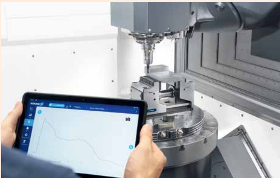
Sofortige Reaktion: Mit intelligenten Werkzeugspannmitteln lassen sich hochgenaue Zerspanprozesse in Echtzeit zuverlässig überwachen und regeln. Bild: Schunk
