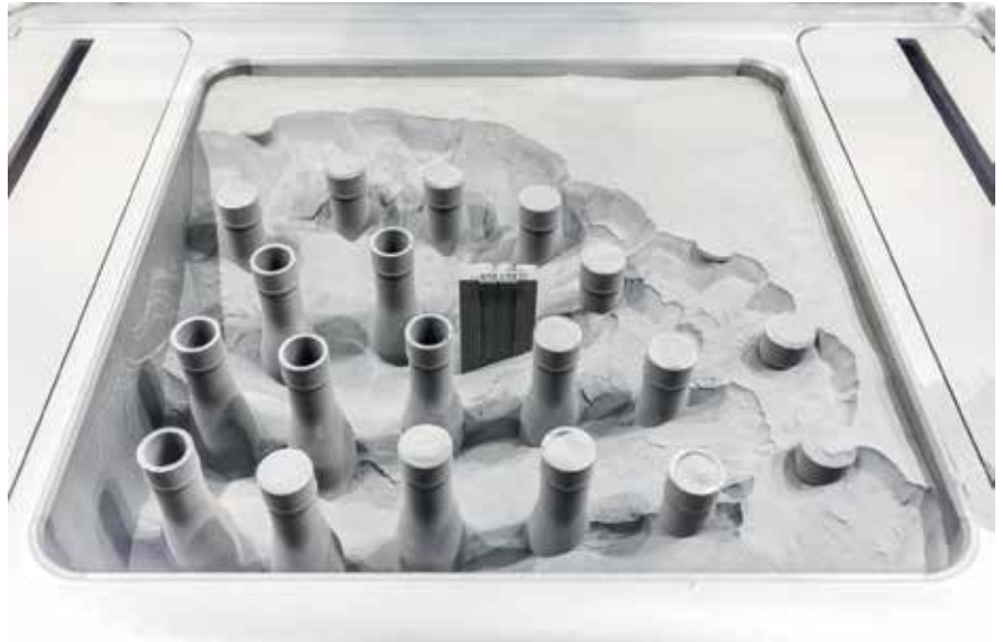
3D-Druck von Verschlusskomponenten für A350-Türen bei Airbus Helicopters Bild: Airbus
