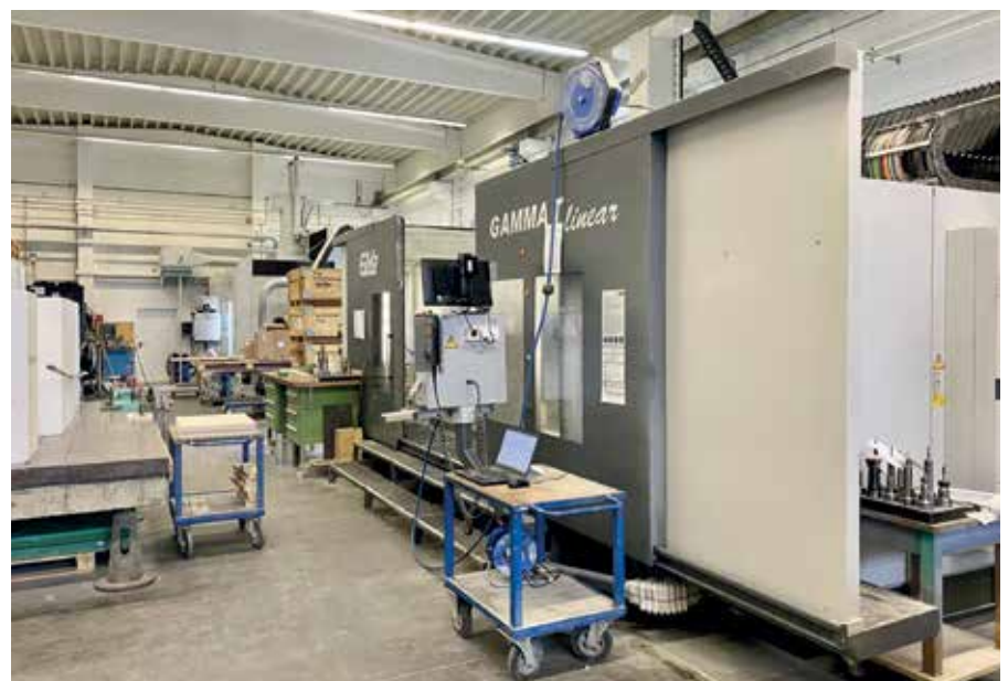
In der Hauk-Fertigungshalle der Modell- und Formenbau GmbH aus Landsberg am Lech stehen 3- und 5-Achs-CNC-Fräsbearbeitungszentren bereit, mit Verfahrwegen bis zu 3.500 x 2.500 x 1.500 mm. Bilder: Marktspiegel Werkzeugbau
