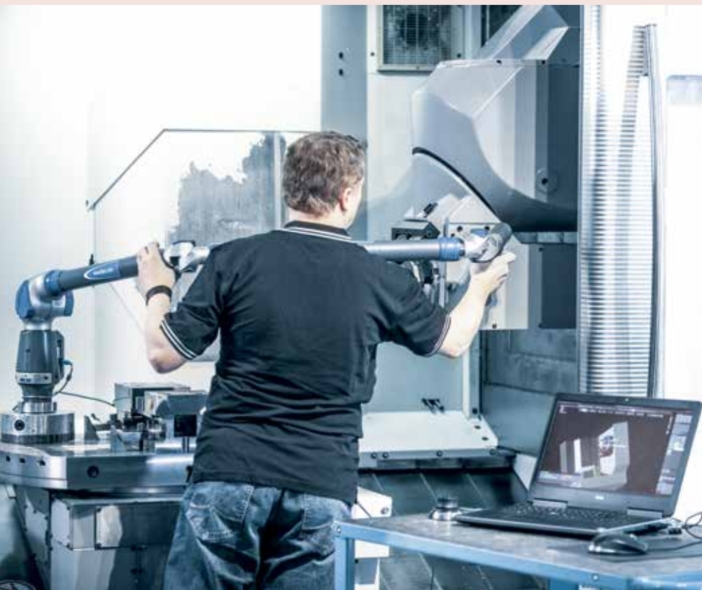
Um die reale Bearbeitungssituation virtuell exakt darstellen zu können, müssen alle Eigenschaften der Maschine präzise vermessen und in das CAM-System transferiert werden.
