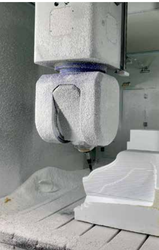
Die Hauk Modell- und Formenbau GmbH bietet ein breites Dienstleistungsportfolio. Beispielhaft dafür steht die Fertigung von Urmodellen aus Exporit für die Luft- und Raumfahrtindustrie.
