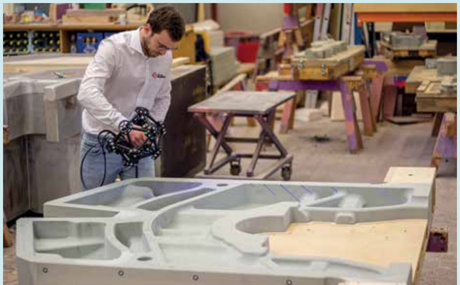
Auch in der Duisburger Modellfabrik, einem Mitgliedsbetrieb des Bundesverband Modell- und Formenbau, kommt der optische Scanner MetraSCAN 3D zum Einsatz.
