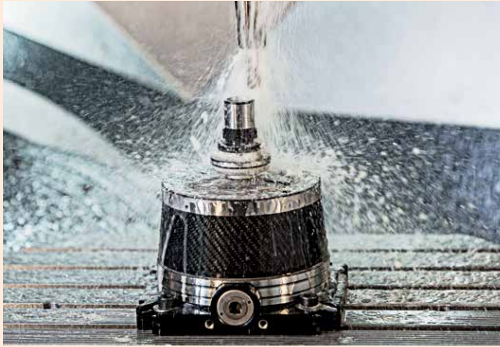
Megatrends im Visier: Zu den smarten Spannmitteln zählen auch Leichtbauprodukte wie der manuelle Spannstock MANOK aus Carbon. Bild: Hainbuch
