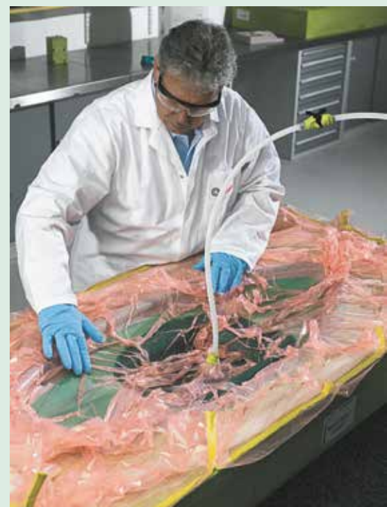
Reaktionsharze aus Polyurethan kommen beim Resin-Infusionsverfahren zur Herstellung von Formteilen zum Einsatz. Bild: Rampf
