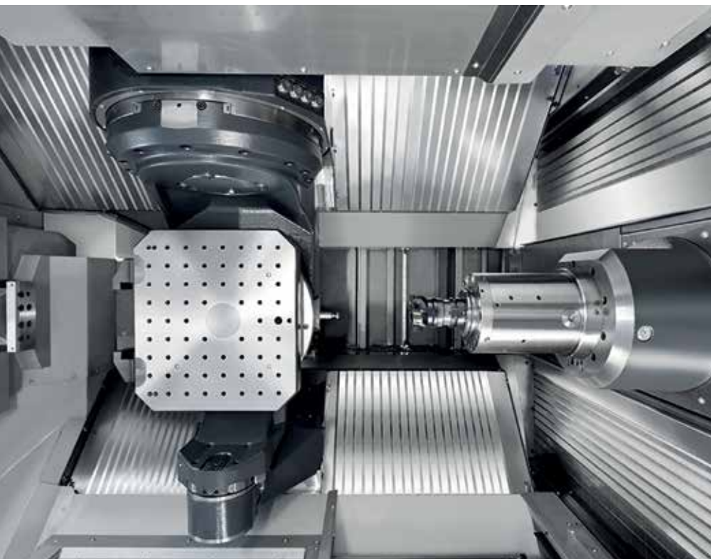
Der Arbeitsraum der HF 3500 überzeugt durch eine Erhöhung der Steifigkeit an Schlüsselkomponenten sowie eine Verkürzung des Abstands der Spindelvorderkante zur Drehmitte der B-Achse.
