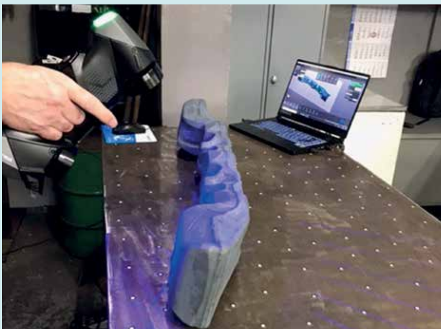
Der HandySCAN 3D kann unter anderem für die Qualitätskontrolle, so wie hier beispielsweise zur Kontrolle von Schmiedeteilen bei der Wilhelm Schulte-Wiese Gesenkschmiede, eingesetzt werden. Bilder: Creaform
