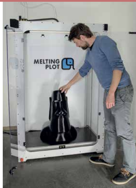
3D Drucker MBL 480 mit einem 600 mm hohen Druckobjekt
