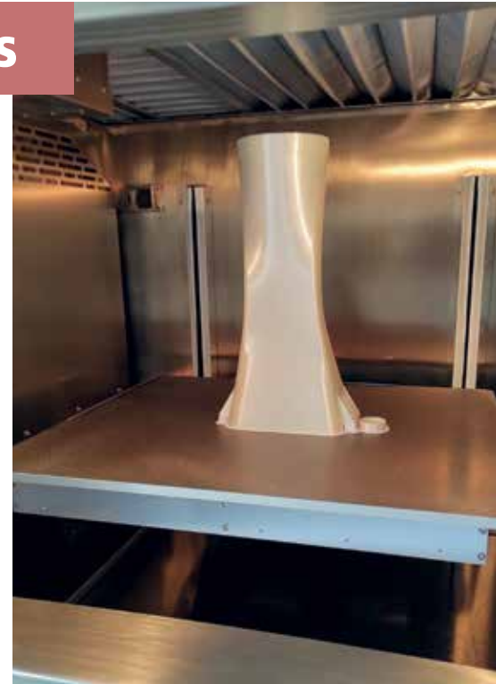
Der 3D-Druckspezialist 4D Concepts hat sein Portfolio um die kurzfristige Bereitstellung anspruchsvoller High Performance Prototypen aus modernen Hochleistungskunststoffen erweitert. Im Bild ein bis zu 175° C hitzefestes Luftführungsrohr aus dem Werkstoff Ultem® 9085.
