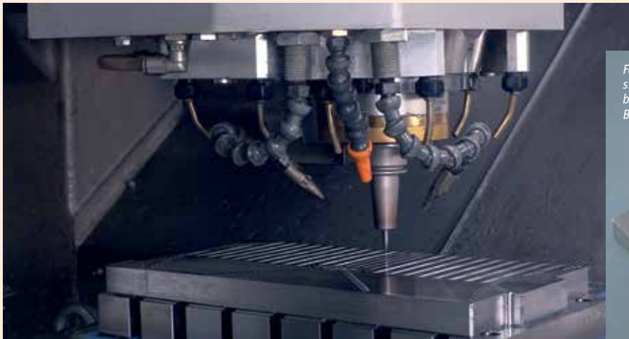
Schichten der Kontur mit einem torischen Werkzeug auf einer Rödgers-Maschine Bild: Rödgers
