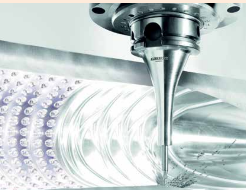
Zur Bearbeitung kleiner Bauteile mit tiefen Aussparungen, wie Steuerunggehäusen oder Sensorhalterungen, eignet sich die weitere Spannfutterbaureihe der Baden-Württemberger mit einem Spannbereich von 1 bis 6 mm. Bild: Albrecht
