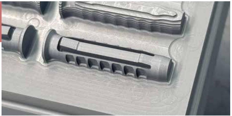
Vorschub verdreifacht: Die Beispielektrode nach dem Schruppen und nach dem Schlichten der beiden linken „Dübelhälften“ auf Endmaß mit dem MOLDINO-Kugelfräser D-EPDB-2004-4.
