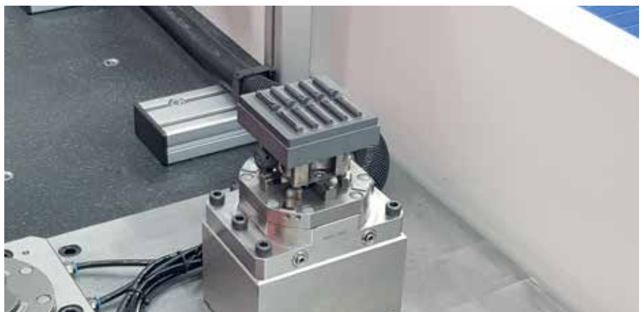
Höhere Maßhaltigkeit, bessere Oberflächen und darum so gut wie keine Nacharbeit mehr: Die Beispielektrode mitsamt Halter auf dem Nullpunktspannplatz der Koordinatenmessmaschine (Zeiss Contura). Bilder: Moldino
