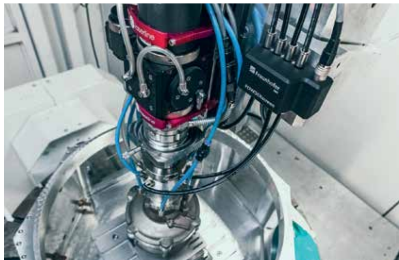
Konzipiert ist POWDERscreen für das Laserauftragschweißen, bei dem Spezialdüsen konzentrierte Ströme aus Metallpulver genau in den Fokus eines Laserstrahls fördern.
