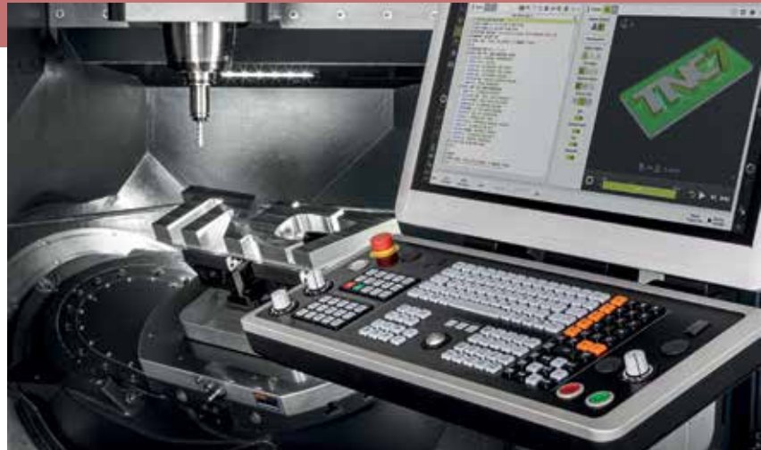
Die Oberfläche der TNC7 wurde von Grund auf neu entwickelt und läuft auf einer leistungsfähigen Hardware und entspiegeltem 24" Full-HD-Bildschirm.
