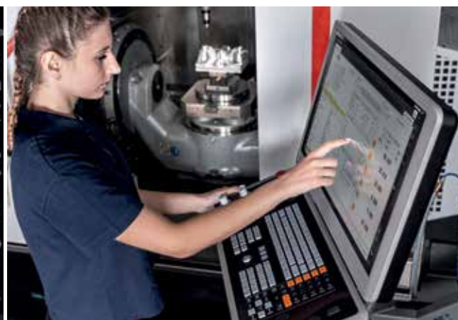
Mit der TNC7 können Anwender die Anzeige der Arbeitsbereiche nach Bedarf anpassen und Favoriten hinterlegen. So sind alle Informationen und Funktionen immer genau da, wo sie im jeweiligen Arbeitsschritt benötigt werden.
