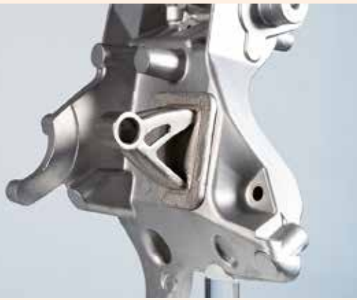
Im Forschungsprojekt CastAutoGen erprobten der Autozulieferer Edag und Partner hybride Fertigungsketten aus Gießen und additiver Fertigung für automobiler Anwendungen, hier ein Nebenaggregathalter.
