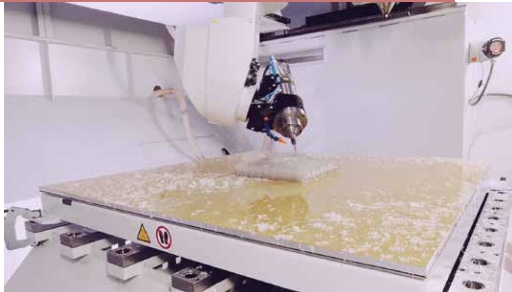
Die Hybridmaschine von Weber Additive und Reichenbacher während des Druckprozesses. Bild: Weber
