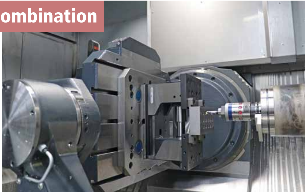
Der neue Feinspindelkopf KOMflex von CERATIZIT nutzt die Funktechnik eines BLUM-Messtasters (Funkschnittstelle RC66 links oben im Bild) zur intelligenten Bohrungsfertigung mit Selbstkorrektur (Schneidenkompensation).
