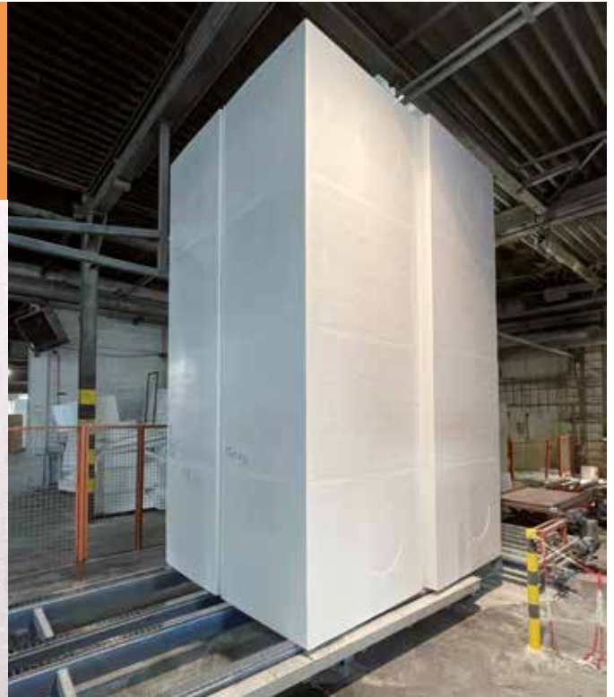
Die ersten Schaumblöcke, die zu 100 Prozent aus recyceltem EPS-Material hergestellt wurden, stehen in Bonn starklar zur Auslieferung.
