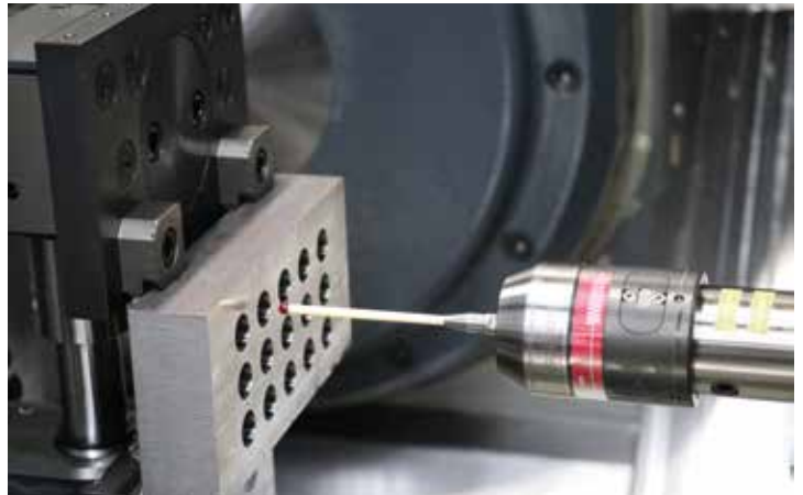
Die Kombination aus Messtaster und Feinspindelkopf ermöglicht den Betrieb in einem geschlossenen Regelkreis, auch in mannlosen Schichten. Das hat für den Anwender technische und wirtschaftliche Vorteile.
