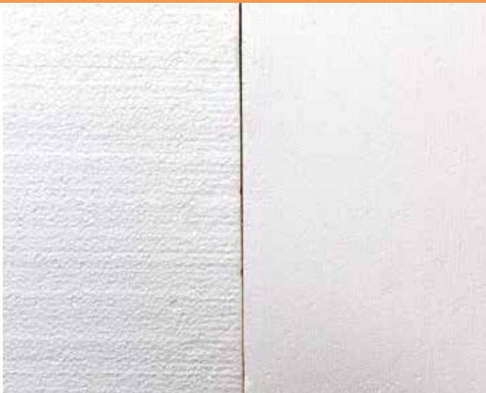
Auch die neuen Vollformguss-Schäume (unser Bild: links normaler EPS-Schaum und rechts EPS-Modellschaum) zeichnen sich durch ihre gleichmäßige Feinkörnigkeit aus und ermöglichen dadurch eine präzise Bearbeitung.
