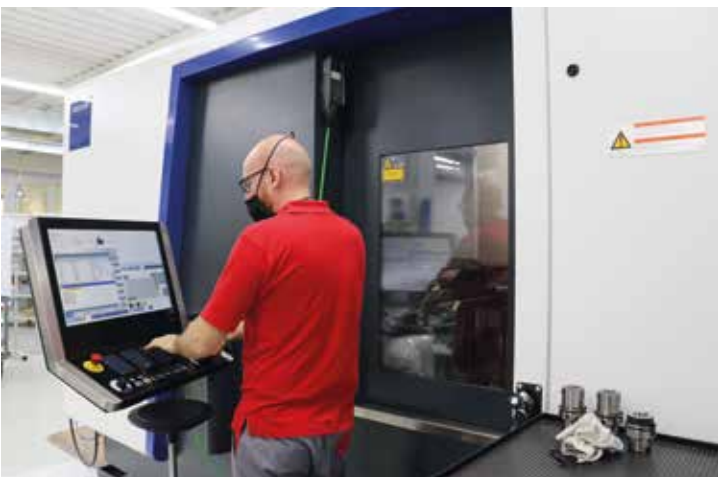
Vorteil für den Maschinenbediener: Einmal eingerichtet arbeitet der Feinspindelkopf KOMflex voll automatisch. Ein manuelles Nachjustieren ist nicht mehr erforderlich. Bilder: CERATIZIT
