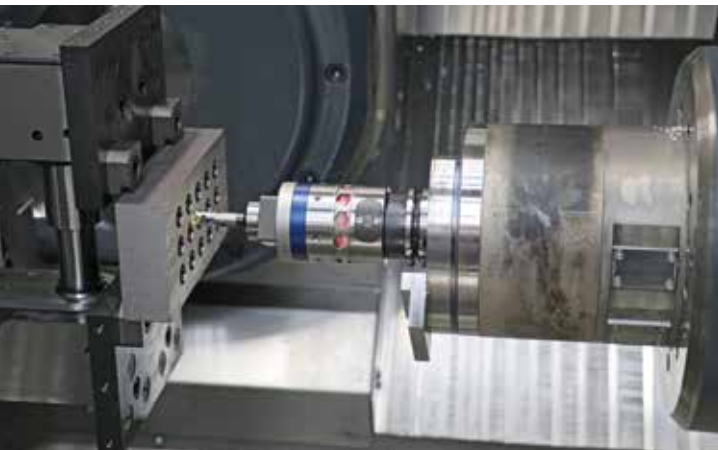
Der neue Feinspindelkopf ist kompakt aufgebaut und leistungsstark. Er lässt sich mit Drehzahlen bis zu 8000 min -1 betreiben und gewährleistet eine Verstellpositionierung mit einer Auflösung von 0,001 mm. Der Verstellbereich beträgt ±0,25 mm.
