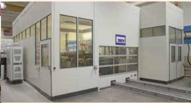
VX4000 3D-Drucker von Voxeljet beim Zulieferer TEI: Der nach Herstellerangaben weltweit größte 3D- Sanddrucker hat ein Bauvolumen von 4 x 2 x 1 m.
